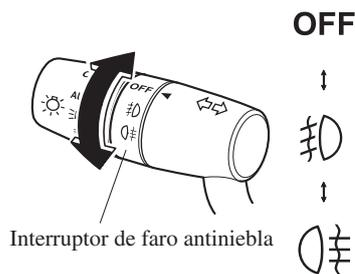
El interruptor de faros se debe encontrar en la posición o antes de encender los faros antiniebla delanteros. El indicador de faros antiniebla delanteros en el panel de instrumentos se enciende mientras los faros antiniebla delanteros están encendidos.
