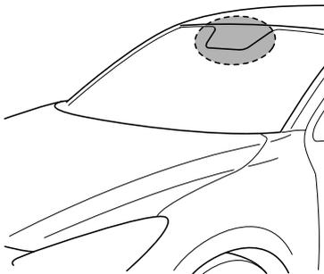
La cámara sensora hacia adelante (FSC) determina las condiciones adelante del vehículo al viajar durante la noche y detecta los carriles de tránsito. La distancia en la que la cámara sensora hacia adelante (FSC) puede detectar objetos varía dependiendo de las condiciones de alrededor.
