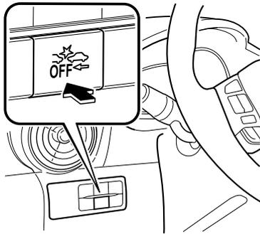
Oprima otra vez el interruptor para volver a encender el sistema. El indicador de soporte de freno de ciudad inteligente (SCBS) OFF se apagará.
