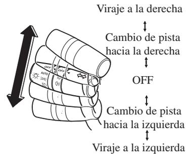
Los indicadores de señales de viraje (verde) en el grupo de instrumentos destellan de acuerdo al funcionamiento de la palanca de señal de viraje para mostrar que señal está funcionando.
