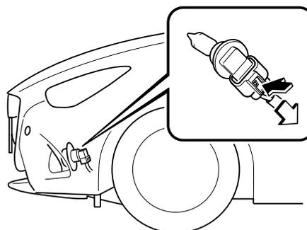
4. Gire el conector y el conjunto de la bombilla para desmontarla. Desmonte cuidadosamente la bombilla de su conector en el reflector tirando suavemente derecho hacia atrás del conector.
