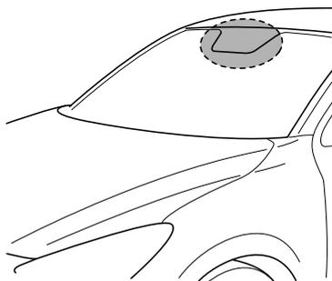
Mantenga siempre la superficie del parabrisas alrededor del sensor láser limpia para asegurarse el funcionamiento correcto del sistema de soporte de freno de ciudad inteligente (SCBS).
