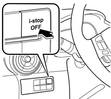
Oprimiendo el interruptor hasta que suene un bip, la función i-stop se desactiva y la advertencia i-stop (ámbar) en el grupo de instrumentos se enciende. Oprimiendo otra vez el interruptor hasta que suene un bip, la función i-stop se activa y la advertencia i-stop (ámbar) se apaga.
