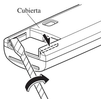
3. Inserte el destornillador de punta plana envuelto en cinta en la ranura y deslícelo en la dirección de la flecha.
