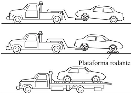
Cuando se remolca el vehículo con las ruedas traseras apoyadas en el suelo, se debe soltar el freno de mano.
