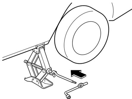
8. Gírela la manija del gato hacia la derecha y levante el vehículo lo suficientemente alto como para instalar el neumático de repuesto. Antes de quitar las tuercas de orejeta, verifique que el vehículo se encuentre en una posición estable y que no se deslice o mueva.
