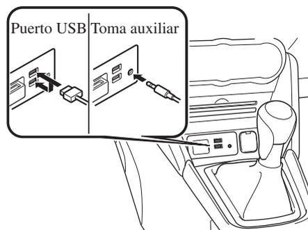
**Conexión de un dispositivo**
