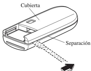
4. Inserte y gire en la dirección de la flecha el destornillador de punta plana y retire la cubierta.
