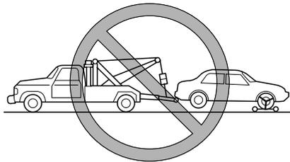
Si en caso de emergencia, no existe un servicio de remolque, tenga en cuenta que el vehículo debe ser remolcado con las cuatro ruedas en el piso usando el gancho de remolque en la parte de adelante del vehículo.
