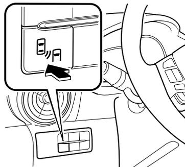
Cuando se oprime el interruptor de monitoreo de punto ciego (BSM), los sistemas de monitoreo de punto ciego (BSM) y alerta de tránsito atrás (RCTA) se desactivan y el indicador de monitoreo de punto ciego (BSM) OFF en el grupo de instrumentos se enciende.
