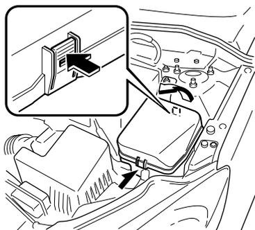
3. Si hay un fusible diferente del fusible MAIN fundido, cámbielo por uno nuevo **con las mismas especificaciones de amperaje**.
