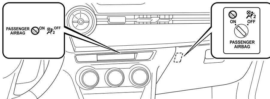
El interruptor de desactivación de la bolsa de aire del acompañante debe ser usado para desactivar la bolsa de aire del acompañante y las bolsas de aire laterales y también el sistema de pretensores del cinturón de seguridad del asiento del acompañante si se instala un sistema de seguridad para niños en el asiento del acompañante.
