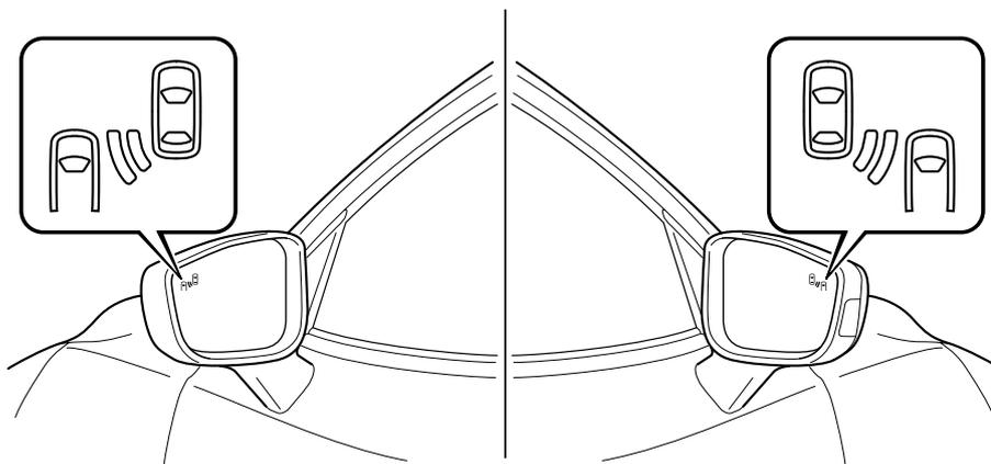
Cuando el encendido se cambia a ON, la advertencia de malfuncionamiento se enciende momentáneamente y luego se apaga después de algunos segundos.
