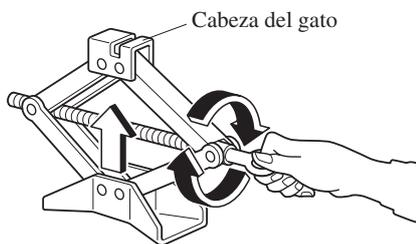
5. Inserte el gato debajo de la posición del gato más cercana al neumático que se quiere cambiar con la cabeza del gato en ángulo recto a la posición del gato.
