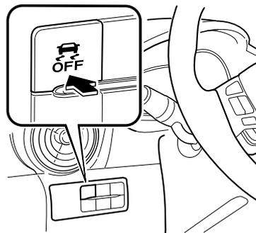
Oprima otra vez el interruptor para volver a encender el TCS/DSC. El indicador DSC OFF se apagará.
