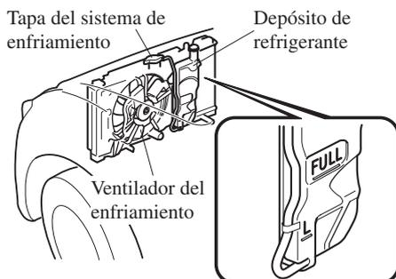
Si está en o cerca de la marca L, agregue suficiente refrigerante anticongelante y anticorrosivo en el depósito de refrigerante para llevar el nivel hasta la marca F ó FULL.
