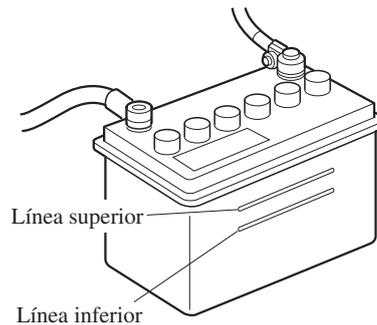
Inspeccione el nivel del electrolito al menos una vez a la semana. Si está bajo, retire la tapas y agregue suficiente agua destilada para llevar el nivel entre las líneas superior e inferior (consulte la figura).
