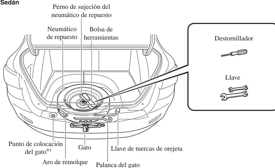
\*1 El punto de colocación del gato puede ser usado por talleres de reparaciones de vehículos y servicios de asistencia en ruta. Consulte a un técnico autorizado Mazda para más detalles.
