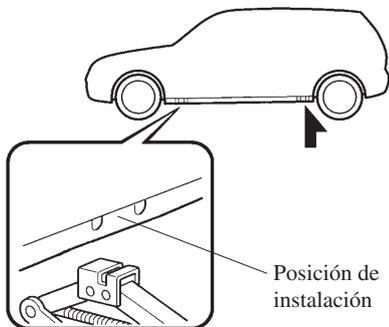
6. Continúe levantando la cabeza del gato gradualmente girando el tornillo con su mano hasta que la cabeza del gato quede insertada en la posición del gato.
