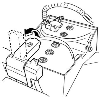
2. Debe asegurarse de que la batería de refuerzo sea de 12 V y que el terminal negativo esté conectado a masa.
