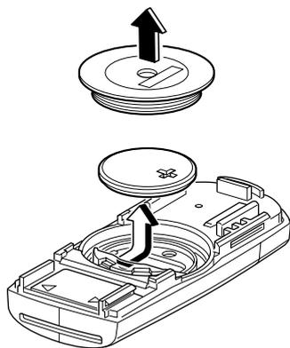
6. Inserte una pila nueva con el polo positivo hacia arriba, y luego cubra la pila con la tapa de la pila.
