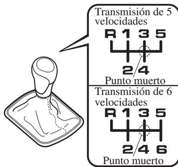
El vehículo está equipado con una transmisión manual de 5 o 6 velocidades. Anteriormente se indica el patrón de cambio para cada una.
