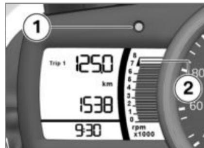
La advertencia de revoluciones **1** indica al conductor que se ha alcanzado el área roja de revoluciones **2**. La señal se conserva hasta que se sube una marcha o se reducen las revoluciones.
