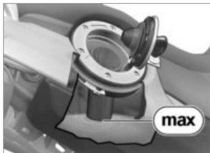
⚠ El combustible se expande si está expuesto a altas temperaturas. Si el depósito de combustible está excesivamente lleno puede derramarse combustible sobre el pavimento. Se corre el riesgo de sufrir una caída.
