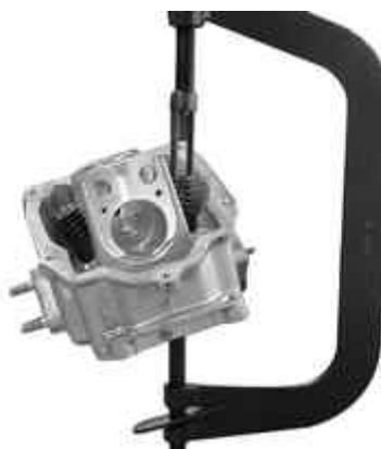
020382Y011 adaptador para herramienta desmontaje válvulas
