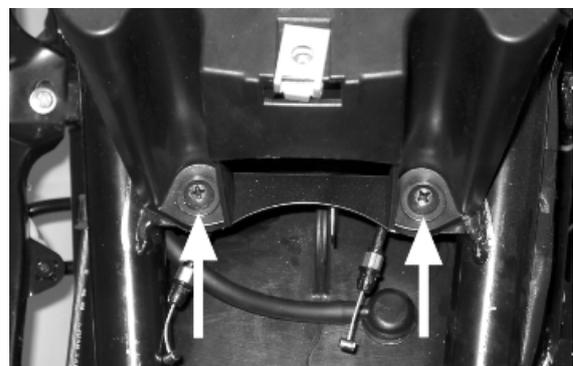
Desenroscar los 4 tornillos (2 por lado) situados en la parte lateral del compartimento portacasco.
