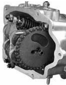
Introducir el anillo de tope en la masa alza-válvula y montar la leva alza-válvula en el árbol de levas.
