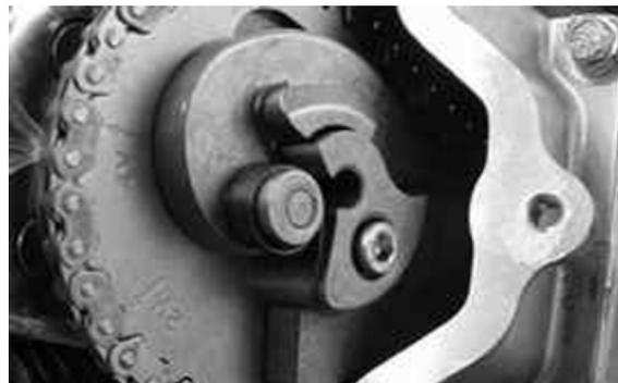
Montar la campana de contención utilizando como referencia el tornillo de fijación del contrapeso.
