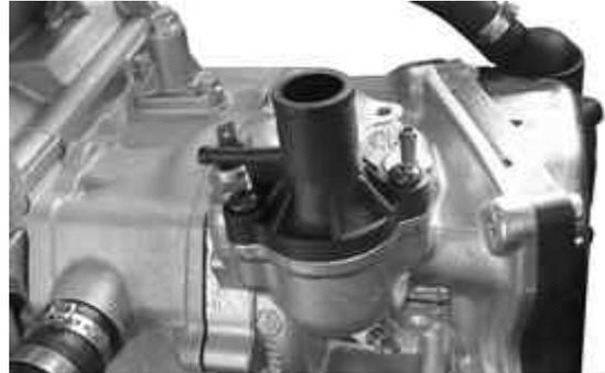
**Pares de apriete (N\*m)****Tornillos de la tapa del termostato 3 ÷ 4**
