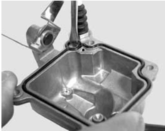
Sostener adecuadamente el carburador y mediante clavija y martillo quitar el perno del flotante desde el lado mando del acelerador.
