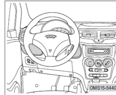
Los compartimentos auxiliares están ubicados en el panel de instrumentos del lado del conductor en ambos lados de la columna de dirección.
