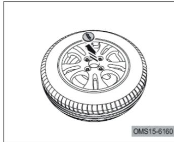
Antes de almacenar la llanta reemplazada, retire el adorno en el centro de la rueda primero e introdúzcalo en la bolsa porta herramienta.
