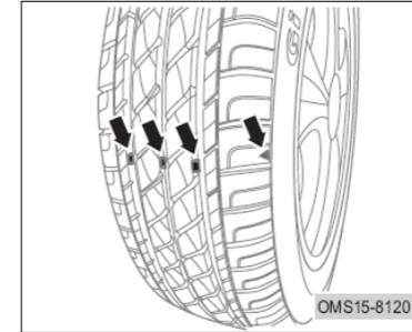
Compruebe la pisada del neumático según los indicadores de desgaste de la banda de rodadura. Cuando la banda de rodadura se desgasta 3 mm, las bandas de desgaste aparecerá en la banda de rodadura. La aparición de las bandas de desgaste indica que se disminuyen seriamente el rendimiento y la seguridad de los neumáticos, y el reemplazo es necesario.
