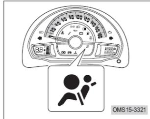
Testigo de Aviso de Airbag SRS (cuadro de instrumentos analógico)
