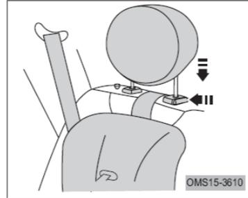
3. Vuelva a colocar el reposacabezas en su posición y presione hasta que quede fijo.
