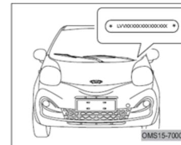
El código VIN está situado en la esquina delantera del panel de instrumentos en el lado del conductor. Es visible desde el exterior del vehículo a través del parabrisas.
