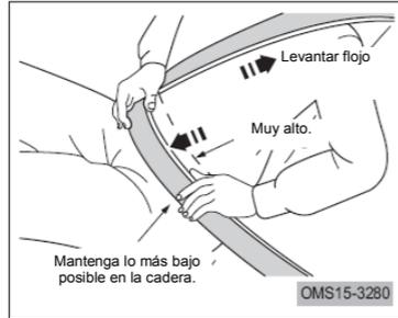
Ajuste de la posición del cinturón de seguridad de 3 puntos
