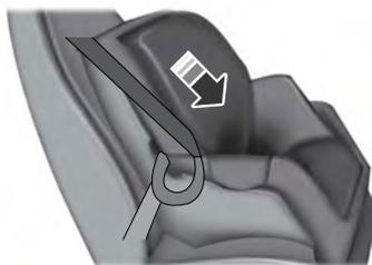
5. Para poner el retractor en el modo de bloqueo automático, tome la parte del hombro del cinturón y jale hacia abajo hasta extraer todo el cinturón.
