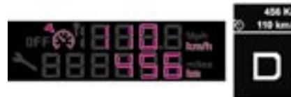
**Observación :** es posible acelerar y circular momentáneamente a una velocidad superior a la velocidad memorizada. El valor memorizado parpadea. Cuando se suelta el pedal de acelerador, el vehículo retoma la velocidad memorizada.
