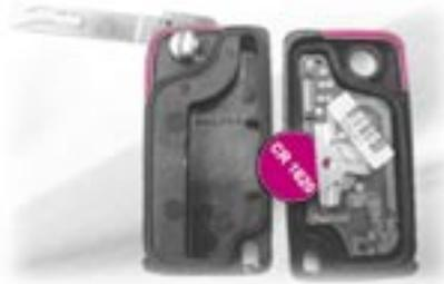
Para sustituir la pila, suelte el cajetín, con la ayuda de una moneda a nivel del anillo (pila CR 1620/3 voltios).
