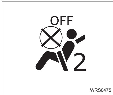
7. Si el sujetador de niños está instalado en el asiento del pasajero delantero: Cuando gire el interruptor de encendido a la posición "ON", la luz de estado de la bolsa de aire del pasajero puede o no iluminarse, esto depende de la estatura del niño y el tipo de asiento elevador que se está utilizando. Vea "Luz de estado y bolsa de aire del pasajero delantero" más adelante en esta sección.
