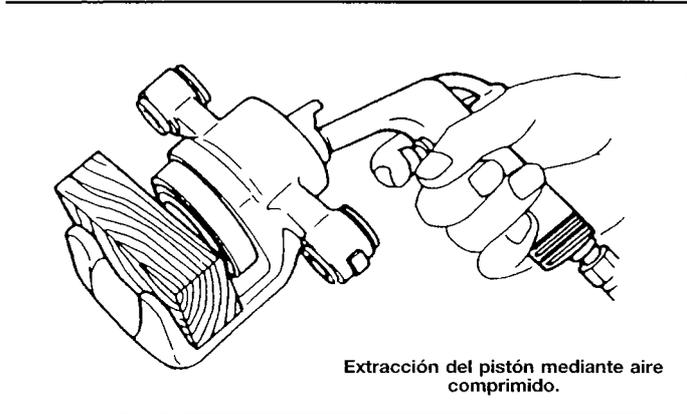
Extracción del pistón mediante aire comprimido.
