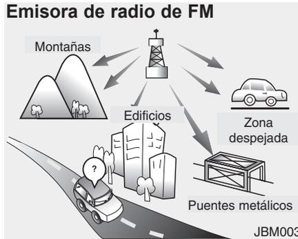
Las emisiones en FM se transmiten a frecuencias elevadas y las ondas no se curvan siguiendo la superficie terrestre. Por ello, las emisiones en FM comienzan por lo general a desvanecerse a escasa distancia de la emisora. Además, las señales de FM se suelen ver afectadas por edificios, montañas u otros obstáculos. Este puede inducirle a pensar que su aparato de radio tiene algún fallo. Las condiciones que se indican a continuación son normales y no indican averías en la radio.
