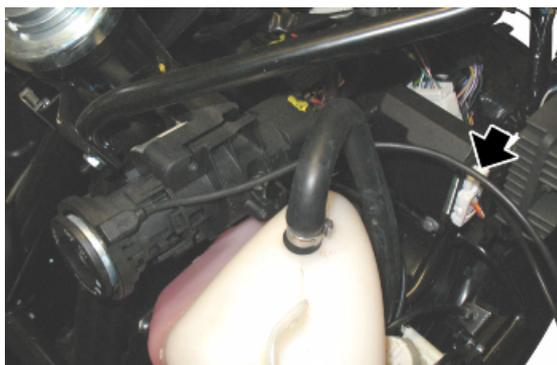
**17.** Décodeur de l'antidémarrage : pour y accéder, déposer le tablier avant.
