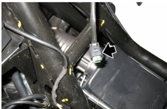
19. Dispositif de gestion des commandes électriques : pour y accéder, déposer le tablier avant.
