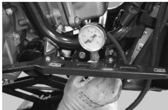
**5** - Mesurer la pression lorsque le moteur est froid et avec un minimum de tours.
