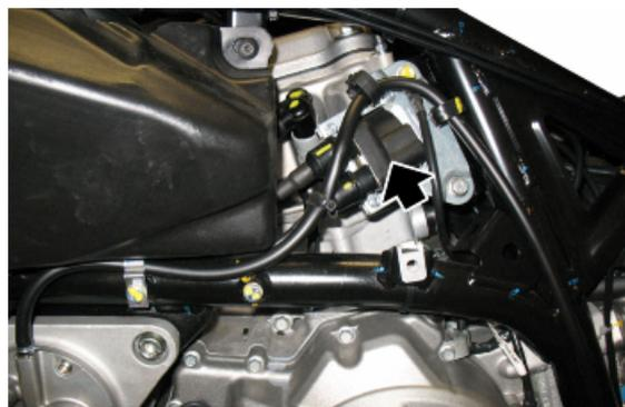
14. Transmetteur de niveau de carburant : pour y accéder, déposer le carénage droit.
