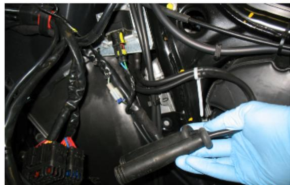
Si on relève des valeurs incorrectes, débrancher les capuchons et mesurer la résistance directement entre les extrémités des deux câbles H.T.
