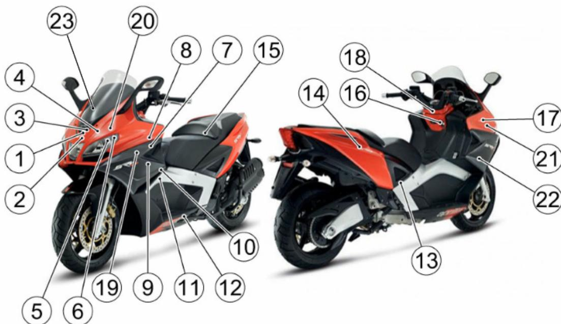
1. Préinstallation pour l'antivol : pour y accéder, déposer le tablier avant.
