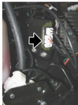
**18.** Préinstallation pour GPS : pour y accéder, déposer la protection centrale du guidon.
