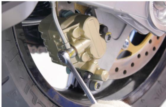
**Couples de blocage (N\*m)****Raccord du tuyau de frein à l'étrier du frein arrière 20 ÷ 25 Vis de fixation de l'étrier du frein arrière à la plaque de support 20 ÷ 25****Avant**
