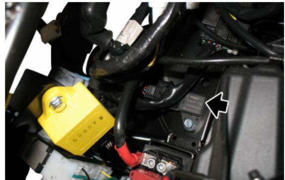
**6.** Dispositif de commande des clignotants : pour y accéder, déposer le tablier avant.
