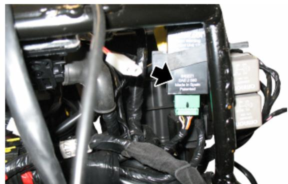
7. Prise de diagnostic : pour y accéder, déposer le couvre-batterie.
