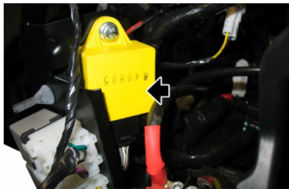
20. Capteur de retournement : pour y accéder, déposer le tablier avant.
