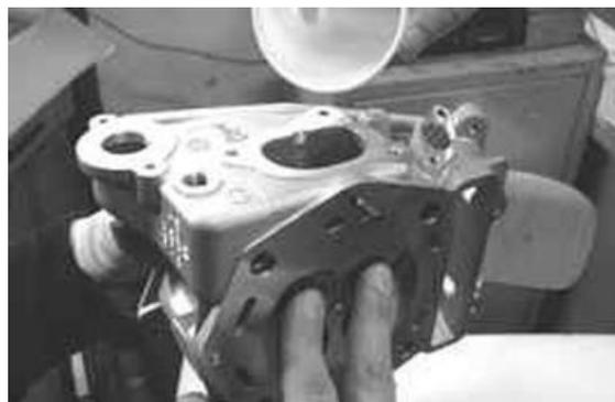
Au moyen d'un alésomètre, mesurer les portées des sièges de l'arbre à cames et des pivots de support des culbuteurs.
