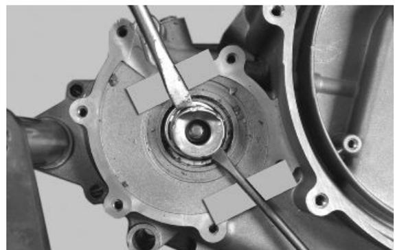
Durant le démontage du joint d'étanchéité, il est possible que la céramique se brise.
