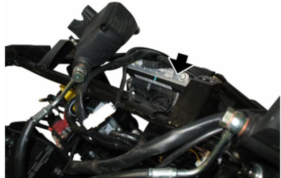
**5.** Capteur de pression barométrique : pour y accéder, déposer le tablier avant.
