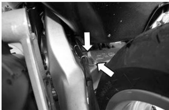
**Frein de stationnement****DÉPOSE DE L'ÉTRIER DU FREIN DE STATIONNEMENT**
