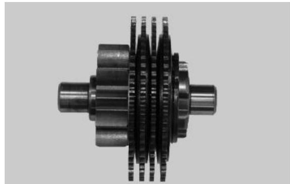
Tout le dispositif limiteur ne peut pas être révisé. Si l'on relève des anomalies évidentes sur les disques crantés, il faut remplacer l'ensemble.
