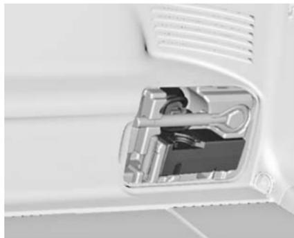
El juego de reparación de neumáticos está en un compartimento debajo de la cubierta del piso en el compartimento de carga. Abra el compartimento portaobjetos → 235
