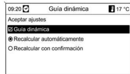
Seleccione **Guía dinámica** para activar/desactivar la guía de ruta dinámica.
