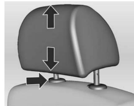
Para ajustar la altura, tire del reposacabezas hacia arriba. Para bajarlo, pulse el resorte y empuje el reposacabezas hacia abajo.
