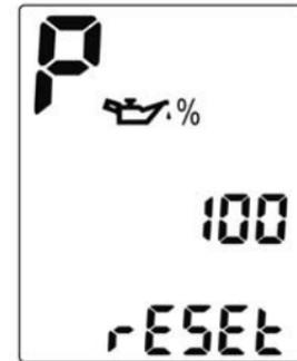
La vida útil restante del aceite se indica en el centro de información del conductor mediante el testigo de control
