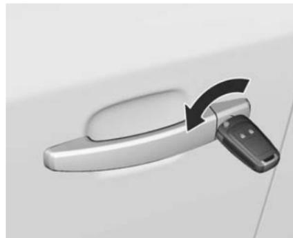
Desbloquee manualmente la puerta del conductor girando la llave en la cerradura. Conecte el encendido y pulse el botón del cierre centralizado
