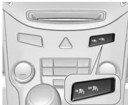
En caso de colisión, el sistema del airbag del acompañante se inflará siempre que el testigo de control
