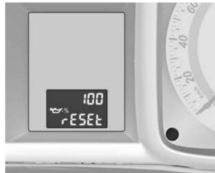
Pulse el botón de ajuste durante unos 5 segundos hasta que se haya mostrado la vida útil restante del aceite del motor. Suelte el botón de ajuste y púlselo de nuevo unos segundos para reiniciar el sistema de control de vida útil del aceite del motor.
