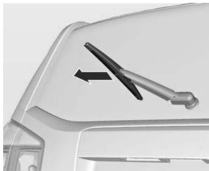
Levante el brazo del limpiaparabrisas. Inserte la escobilla ligeramente inclinada respecto al brazo del limpiaparabrisas y empújela hasta que enclave.
