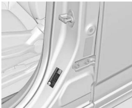
Presión de los neumáticos ⇨ 272 y en la etiqueta colocada en el marco de la puerta delantera izquierda.
