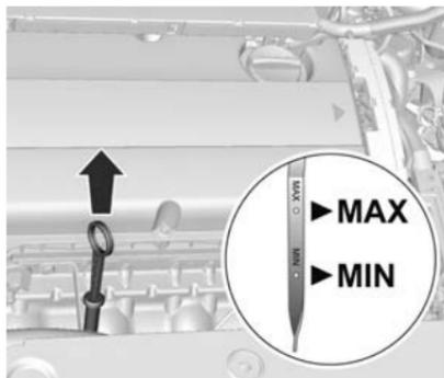
Se utilizan distintos tipos de varilla de medición del aceite, según el tipo de motor.
