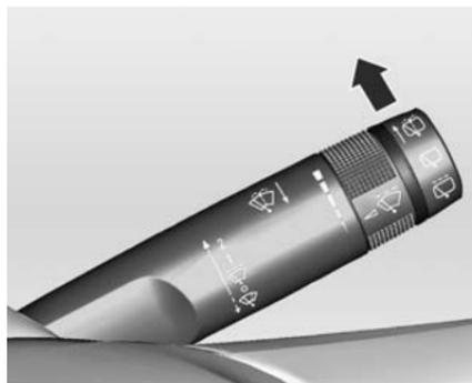
Presione la palanca. Se pulveriza líquido de lavado sobre la luneta trasera y el limpiacristales se realiza el barrido varias veces.
