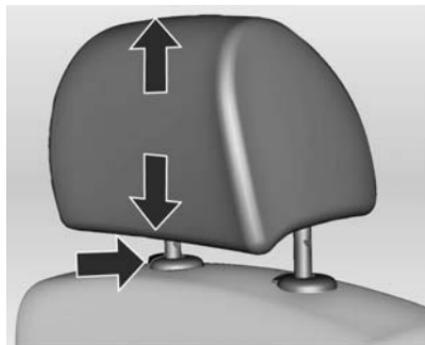
Tire del reposacabezas hacia arriba. Para bajarlo, pulse el resorte y empuje el reposacabezas hacia abajo.
