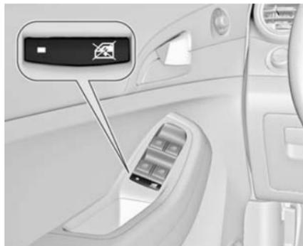
Pulse el interruptor
