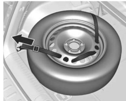
4. Inserte la correa entre los radios de la llanta como se muestra en la ilustración.
