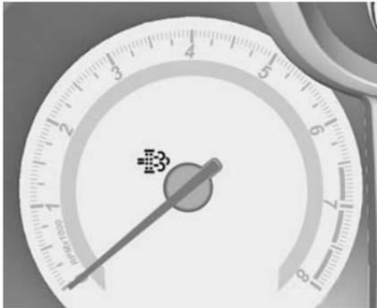
El testigo de control
