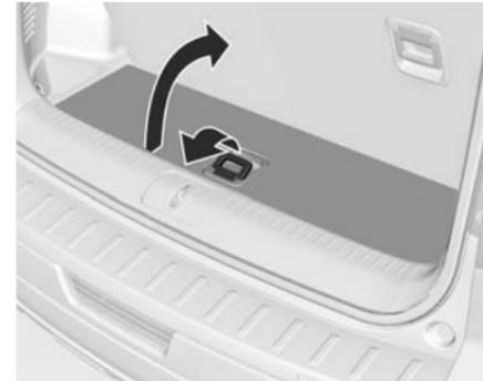
Tire de la manilla de la cubierta del piso. Levante la cubierta del piso.
