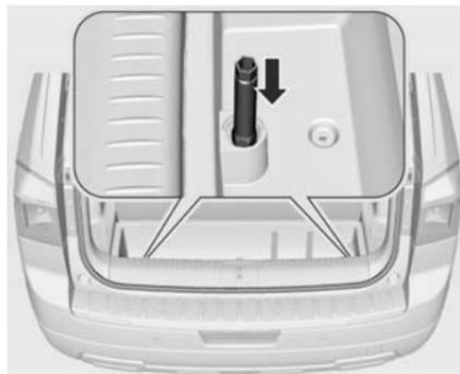
3. Coloque la barra de prolongación sobre el tornillo hexagonal.
