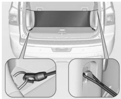
Para montar la red, enganche los lazos en los anclajes del panel trasero y fije los ganchos en las argollas del piso del compartimento de carga.
