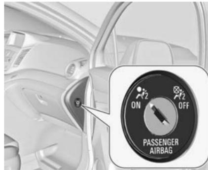
El sistema de airbag del acompañante se puede desactivar mediante un interruptor accionado con la llave en el lado derecho del tablero de instrumentos.
