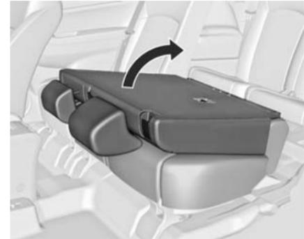
Coloque el respaldo en posición vertical, hasta que se enclave.
