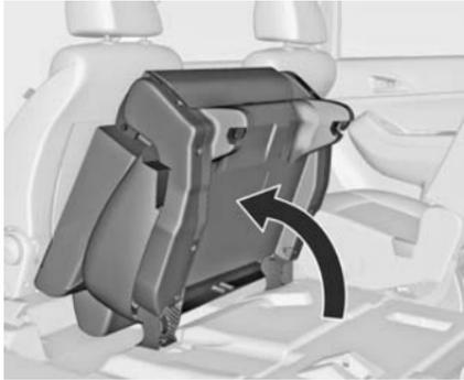
A continuación, el asiento se levantará automáticamente. Si el asiento no se levanta completamente, puede levantarlo manualmente hasta dicha posición.
