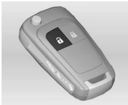
Pulse el botón
