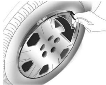
1. Desenclave los tapones de las tuercas de rueda con un destornillador y desmóntelos. Quite el tapacubos con el gancho. Herramientas del vehículo ↗ 235.
