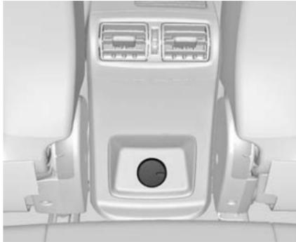
Hay tomas de corriente de 12 V en la consola del piso trasero y en el lado izquierdo del compartimento de carga.
