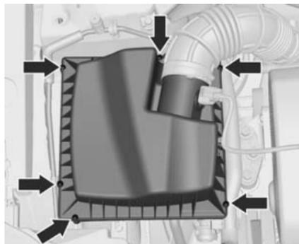
Para sustituir el filtro de aire del motor, desenrosque 6 tornillos y desmonte la carcasa del filtro.
