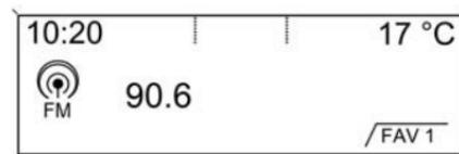
Indicación de la hora, la temperatura exterior, la fecha o del sistema de infoentretenimiento (cuando está encendido) y de los ajustes para la personalización del vehículo.
