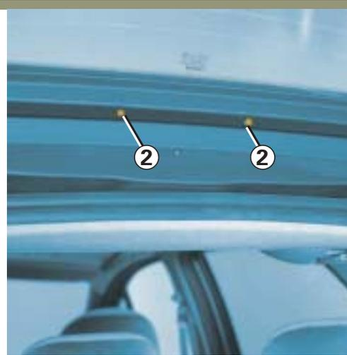
Suelte la óptica, introduciendo una herramienta tipo destornillador plano en los dos huecos **2**.
