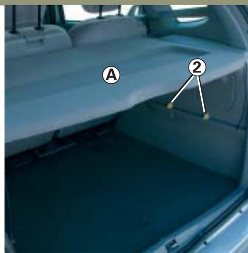
Es posible colocar la bandeja a media altura del baúl (altura que corresponde a la de los asientos traseros con respaldos abatidos). Para ello, utilice los puntos de apoyo **2** de cada lado del baúl.
