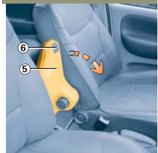
Para el reglaje del apoyabrazos central (solamente en algunas versiones), baje el apoyabrazos **5** hasta bloquearlo e introduzca el botón **6** para ajustar su altura.
