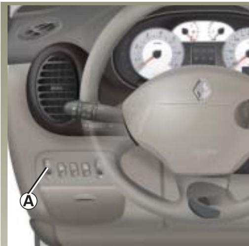
El botón **A** permite corregir la altura de los faros en función de la carga.
