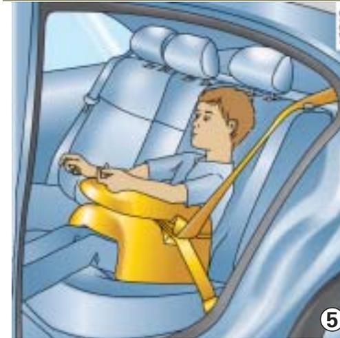
Para colocar el cinturón lo más cerca posible del cuello, pero sin llegar a tocarlo, se aconseja un suplemento con respaldo regulable en altura y una guía del cinturón. Para los vehículos equipados de un cinturón de dos puntos en la plaza central, es preciso utilizar un asiento de tipo receptáculo (figura 5).
