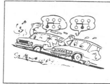
6.- Al subir una pendiente, cambie al engranaje de baja velocidad antes de que el motor empiece a andar con dificultad, a fin de rebajar la sobrecarga del motor.
