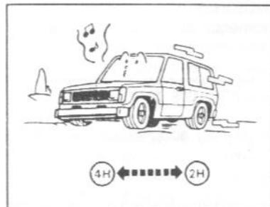
\* La caja de transferencia no posee punto neutro. Por lo tanto, la palanca de cambio debe colocarse correctamente en posición 2H, 4H ó 4L durante la operación.
