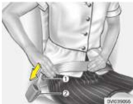
Para ajustar el cinturón de dos puntos estáticos, introduzca la lengüeta metálica (1) en la hebilla de bloqueo (2). Se escuchará un "clíc" cuando la lengüeta quede bloqueada en la hebilla. Asegúrese de que el cinturón está correctamente bloqueado y de que el cinturón no está retorcido.
