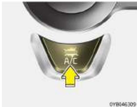
Pulse el botón A/C para encender el sistema de aire acondicionado (se iluminará un testigo indicador). Pulse el botón otra vez para apagar el sistema de aire acondicionado.
