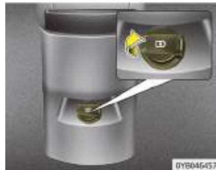
El cargador USB se ha diseñado para recargar la batería de pequeños dispositivos eléctricos mediante un cable USB. Los dispositivos eléctricos pueden recargarse cuando el botón ENGINE START/STOP (inicio/parada del motor) está en la posición ACC/ON/START. El estado de carga de la batería puede observarse en el dispositivo eléctrico. Desconecte el cable USB del puerto USB después de usarlo.
