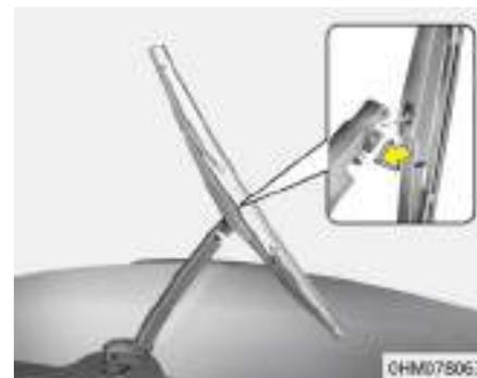
2. Monte un nuevo conjunto de la escobilla colocando la parte central en la ranura del brazo del limpiaparabrisas hasta que encaje en su sitio.
