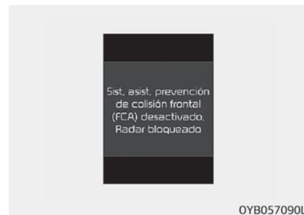
Si la cubierta del sensor está sucia a causa de la presencia de cuerpos extraños, como nieve o lluvia, el funcionamiento del sistema FCA podría detenerse temporalmente. En este caso, aparece el mensaje de advertencia para advertir al conductor.
