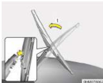
1. Levante el brazo del limpiaparabrisas (1) y tire hacia fuera del conjunto de la escobilla.
