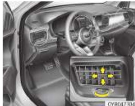
El difusor de salida puede abrirse o cerrarse por separado utilizando la ruedecilla horizontal. Para cerrar la ventilación, gírela hacia abajo hasta la posición máxima. Para abrir la ventilación, gírela hacia arriba hasta la posición que desea.
