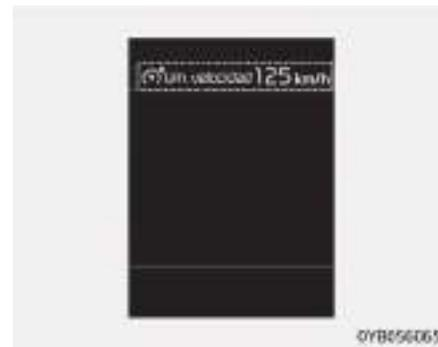
Para conducir sobrepasando el límite de velocidad ajustado, pise con fuerza el pedal del acelerador (más del 80 %) hasta que se accione el mecanismo kick down con un clic. El límite de velocidad ajustado parpadeará y sonará una señal acústica hasta que se regrese al límite de velocidad ajustado.
