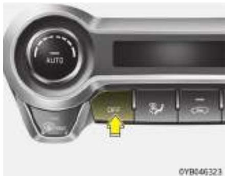
Pulse el botón OFF para apagar el sistema de control del climatizador de aire. No obstante, todavía puede accionar los botones de admisión de aire mientras que el botón de encendido está en la posición ON.
