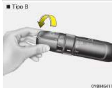
Cuando el interruptor de las luces está en la posición de luz de estacionamiento (2.<sup>a</sup> posición), la luz trasera, la de posición, la de la matrícula y el panel de instrumentos se encenderán.
