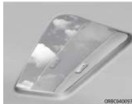
El parasol se abrirá automáticamente con el panel de cristal a la vez que el panel de cristal se desliza. Si quiere cerrarlo, tendrá que hacerlo manualmente.
