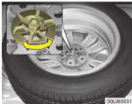
Gire el perno de palomilla de apriete de la rueda en sentido antihorario. Guarde el neumático siguiendo el proceso de desmontaje en sentido inverso. Para impedir que la rueda de repuesto y las demás herramientas se muevan mientras el vehículo está en marcha, guárdelas correctamente.
