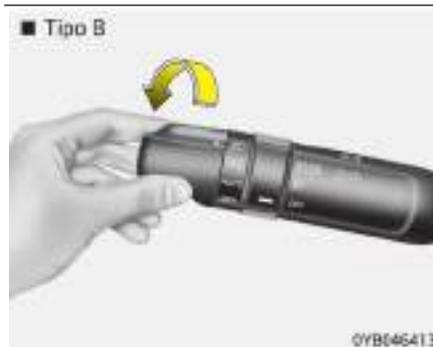
Cuando el interruptor de las luces está en la posición de faros (3.<sup>a</sup> posición), los faros, las luces traseras, la luz de posición, la de la matrícula y del panel de instrumentos están encendidos.
