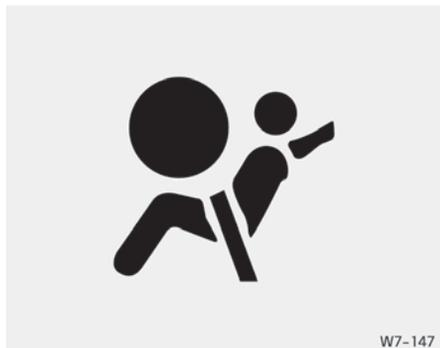
El objetivo del testigo de advertencia del airbag en el panel de instrumentos es el de avisar de un problema potencial del airbag - Sistema de sujeción suplementario (SRS).
