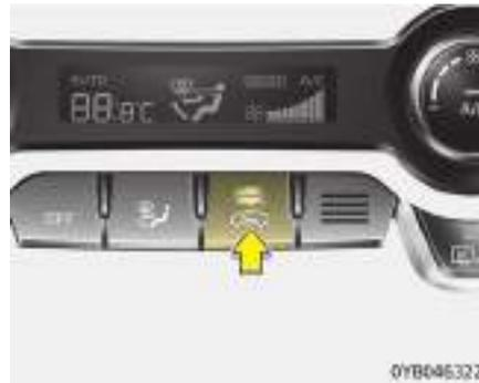
Esto se emplea para seleccionar la posición del aire (fresco) exterior o la posición del aire recirculado.
