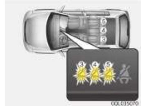
Si el interruptor de encendido está en posición ON (el motor no está funcionando) cuando el cinturón de seguridad del acompañante trasero está desabrochado, el testigo de advertencia correspondiente se iluminará hasta que se abroche el cinturón.
