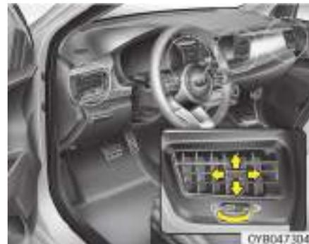
Los difusores de salida pueden abrirse o cerrarse por separado utilizando la rueda-clic. Para cerrar la ventilación, gírela hacia abajo hasta la posición máxima.
