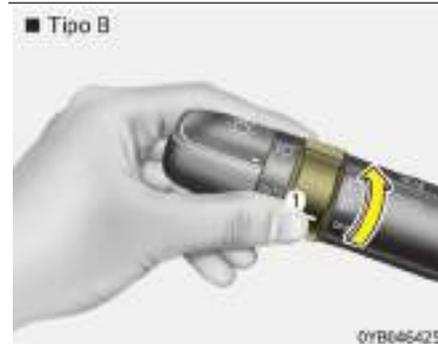
Para encender los pilotos antiniebla traseros, coloque el interruptor de la luz antiniebla trasera (1) en la posición ON con los faros encendidos.
