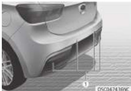
El sistema de ayuda al estacionamiento trasero asiste al conductor en el movimiento de dar marcha atrás emitiendo una señal acústica si se detecta algún objeto a una distancia de 120 cm detrás del vehículo.
