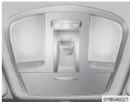
Si el vehículo está equipado con un techo solar, puede deslizarlo o inclinarlo con la palanca de control del techo solar ubicada en la consola superior. El techo solar solo puede abrirse, cerrarse o inclinarse cuando el interruptor de encendido está en la posición ON.
