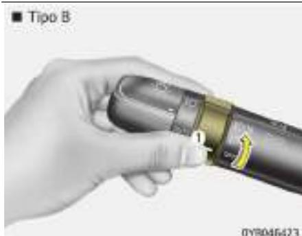
Las luces antiniebla sirven para mejorar la visibilidad en caso de niebla, lluvia o nieve, etc. Las luces antiniebla se encenderán cuando el interruptor de las luces antinieblas (1) se activa después de encender la luz de estacionamiento. Para apagar las luces antiniebla, coloque el interruptor de las luces antiniebla (1) en la posición 0 (Off).
