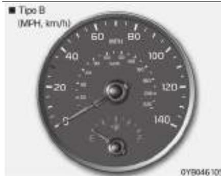
El velocímetro indica la velocidad del vehículo y está calibrado a millas por hora (mph) y/o kilómetros por hora (km/h).
