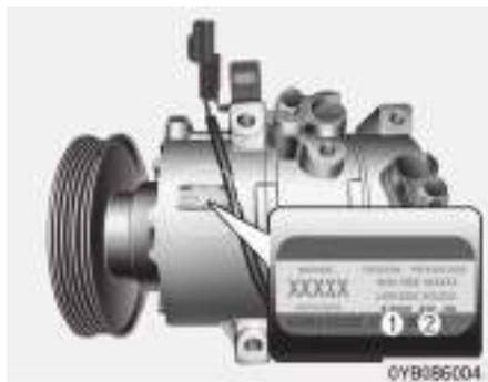
La etiqueta del compresor indica el tipo de compresor con el que está equipado el vehículo, el modelo, el número de pieza, el número de producción, el refrigerante (1) y el aceite refrigerante (2).
