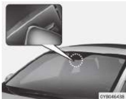
El sistema de desempañado automático reduce la posibilidad de empañado en el interior del parabrisas al detectar automáticamente la humedad del interior del parabrisas y el flujo de aire hacia el parabrisas puede aumentar. El sistema de desempañado automático funciona cuando el modo AUTO está activado.
