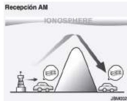
Las retransmisiones AM se reciben a mayores distancias que las retransmisiones FM. Esto se debe a que las ondas de radio de AM se transmiten a bajas frecuencias. Estas ondas de radio de baja frecuencia pueden seguir la curvatura de la tierra mejor que viajar en línea recta en la atmósfera. Además, esquivan los obstáculos y así proporcionan una cobertura de señal mejor.
