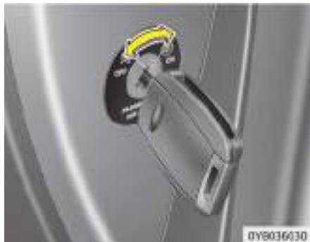
Se puede desactivar el airbag frontal del copiloto mediante el interruptor de activación / desactivación (ON/OFF) del airbag frontal del acompañante si se instala un sistema de retención para niños o si el asiento del acompañante no está ocupado.
