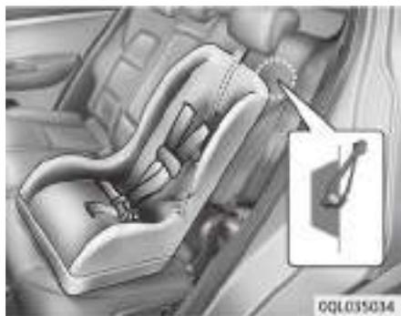
1. Coloque la correa superior del sistema de sujeción para niños sobre el respaldo. Al colocar la correa superior, siga las instrucciones del fabricante del sistema de sujeción para niños.
