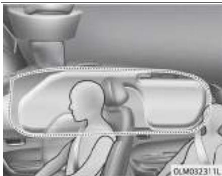
Los airbags laterales y de cortina están diseñados para inflarse cuando los sensores de colisión laterales detectan un impacto dependiendo de la fuerza, la velocidad o los ángulos de impacto provocado por una colisión de impacto lateral.
