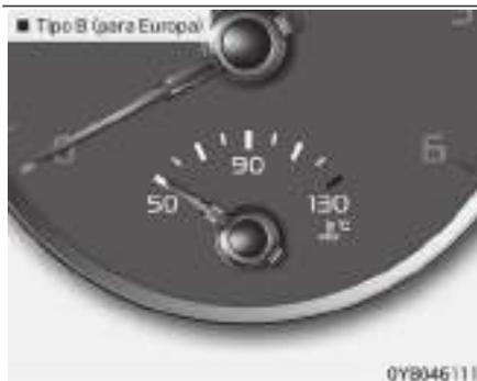
Este indicador muestra la temperatura del refrigerante del motor cuando el interruptor de encendido o el botón ENGINE START/STOP (inicio/parada del motor) está en ON.
