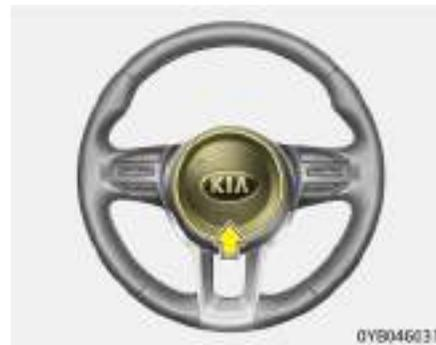
Para hacer sonar el claxon, pulse los símbolos del claxon de su volante. Compruebe habitualmente el claxon para asegurarse de que funciona correctamente.
