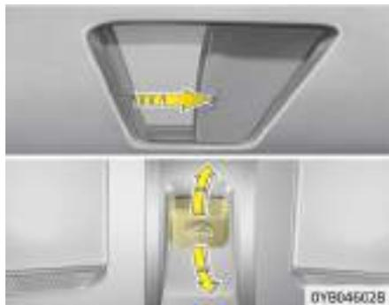
Para abrir el techo solar, empuje la palanca de control del mismo hacia atrás. Para cerrar el techo solar, pulse la palanca de control del techo solar hacia delante.
