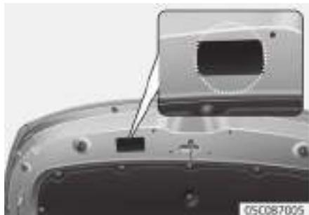
La etiqueta de refrigerante está colocada en la parte inferior del capó.
