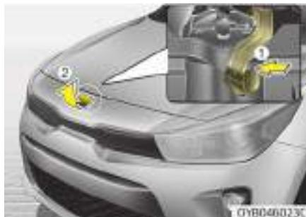
2. Vaya a la parte delantera del vehículo, eleve el capó ligeramente, después tire del enganche (1) interior del centro del capó y levante el capó (2).
