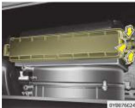
3. Extraiga la cubierta del filtro de aire del control del climatizador pulsan-
