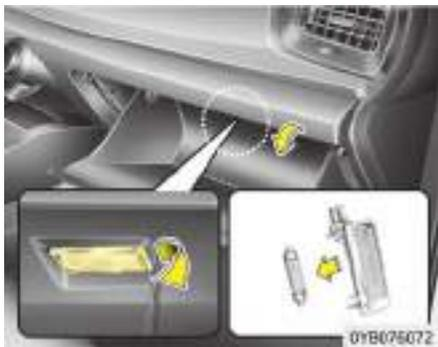
1. Con un destornillador de punta plana, haga un poco de palanca en la lente desde el interior del conjunto de la luz.
