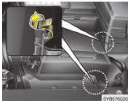
1. Afloje los clips de sujeción de la cubierta del purificador de aire y abra la cubierta.
