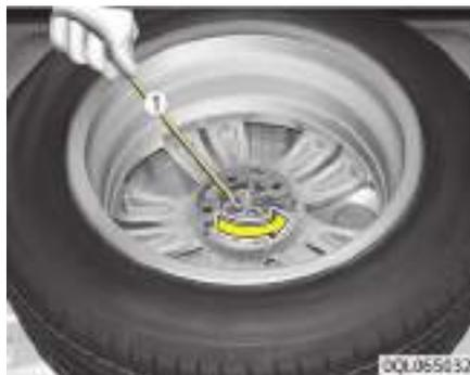
Si resulta difícil aflojar el perno de palomilla de fijación de la rueda con la mano, podrá aflojarlo más fácilmente usando la manivela del gato.
