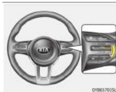
3. Mueva la palanca hacia abajo (a SET-) y suéltela a la velocidad deseada. El testigo indicador de cruceo se iluminará. Suelte el pedal del acelerador al mismo tiempo. Se mantendrá automáticamente la velocidad deseada.
