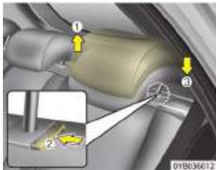
Para elevar el reposacabezas, tire del mismo hacia arriba a la posición deseada (1). Para bajar el reposacabezas, tire y mantenga pulsado el botón de desbloqueo (2) en el soporte del reposacabezas y bájelo a la posición deseada (3).
