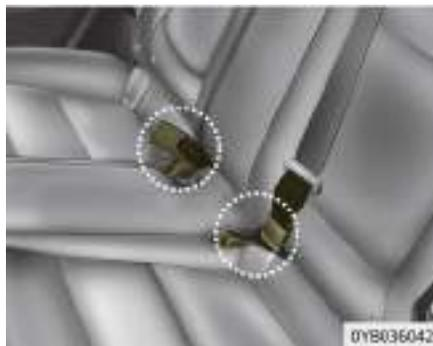
Las hebillas de los cinturones de seguridad traseros se pueden guardar en el bolsillo situado entre el respaldo trasero y el cojín cuando no se utilizan.
