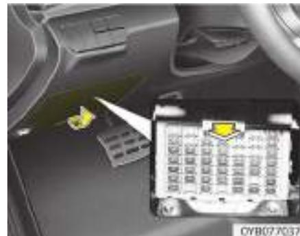
Su vehículo está equipado con un fusible de memoria para impedir la descarga de la batería cuando aparcas el vehículo tras haber conducido durante un período de tiempo largo. Siga los procedimientos siguientes antes de aparcar el vehículo durante un tiempo largo.
