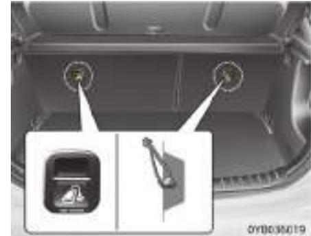
Los anclajes de correa superior para el sistema de sujeción para niños se encuentran en la parte trasera del respaldo del asiento trasero.
