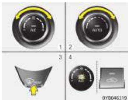
1. Ajuste la velocidad del ventilador a la posición deseada.
