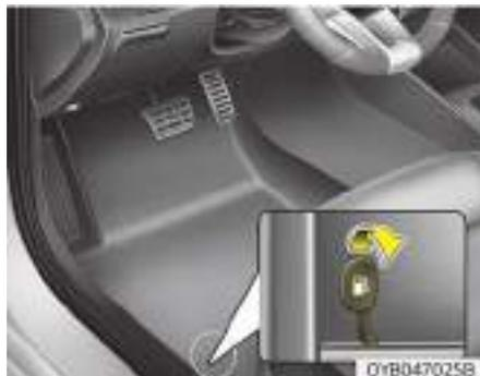
La tapa de llenado de combustible debe abrirse desde el interior del vehículo tirando de la palanca de la tapa de llenado de combustible ubicada en la zona del suelo delantero debajo del asiento del conductor.
