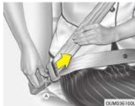
El cinturón se suelta pulsando el botón de desbloqueo (A) en la hebilla de bloqueo. Al soltarlo, el cinturón deberá regresar automáticamente al retractor. Si esto no ocurriese, compruebe el cinturón para asegurarse de que no está retorcido y vuelva a intentarlo.
