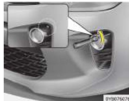
La luz antiniebla delantera puede orientarse del mismo modo que los faros. Con las luces antiniebla delanteras y la batería en estado normal, oriente las luces antiniebla delanteras. Para orientar la luz antiniebla delantera hacia arriba o hacia abajo, gire el destornillador en el sentido de las agujas del reloj o al contrario.
