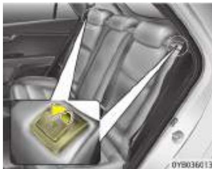
4. Tire de la palanca de liberación de bloqueo y pliegue el respaldo del asiento trasero hacia delante y hacia abajo.
