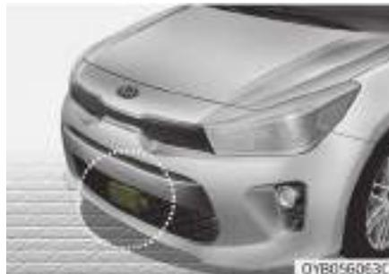
El sensor sirve para mantener una cierta distancia con el vehículo que lo precede. Sin embargo, si las lentes del sensor están sucias a causa de la presencia de cuerpos extraños, como nieve y lluvia, esto afecta negativamente el rendimiento del sensor. Podría incluso cancelar temporalmente el FCA. Mantenga siempre limpias las lentes del sensor.
