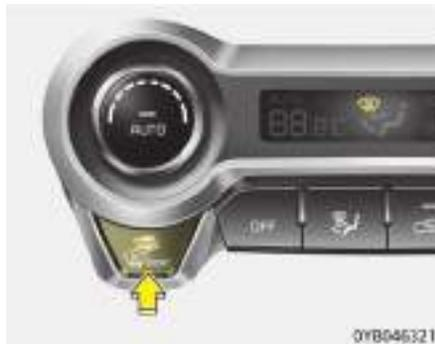
Si selecciona el modo del desempañador, se realizarán automáticamente los siguientes ajustes en el sistema:
