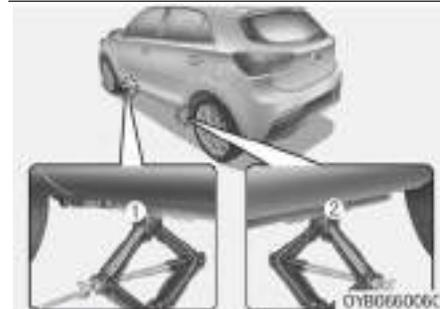
7. Sitúe el gato en la posición delantera (1) o trasera (2), más cercana a la rueda que se cambia. Coloque el gato en la zona designada debajo del bastidor. Las posiciones para el gato son placas soldadas al bastidor con dos lengüetas y un punto de apoyo para el gato.
