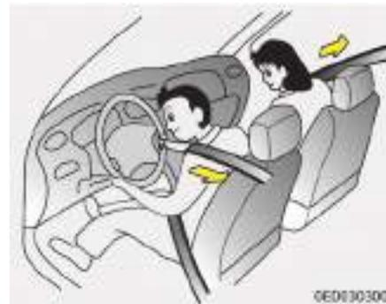
El vehículo está equipado con pretensores de los cinturones de seguridad en las posiciones de los asientos delanteros y traseros exteriores. El objetivo de los pretensores es garantizar que los cinturones se ajusten de forma ceñida al cuerpo del ocupante en ciertas colisiones. Los pretensores del cinturón de seguridad pueden activarse en caso de choque cuando la colisión es lo bastante fuerte.
