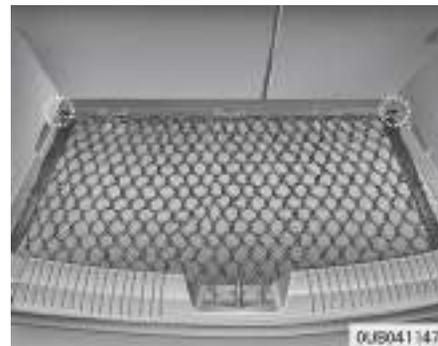
Para evitar que el equipaje se desplace en el área de carga, puede utilizar los 4 soportes ubicados en el área de carga para enganchar la red del maletero. Si es necesario, Kia recomienda ponerse en contacto con un centro de servicio / distribuidor Kia autorizado.
