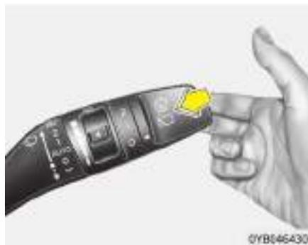
En la posición 0 (Off), tire ligeramente de la palanca hacia usted para pulverizar líquido sobre el parabrisas y para activar 1-3 barridos del limpiaparabrisas.
