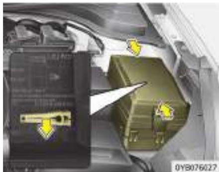
3. Tire del fusible averiado. Utilice la herramienta de desmontaje que se encuentra en la caja de fusibles principal del compartimento del motor.
