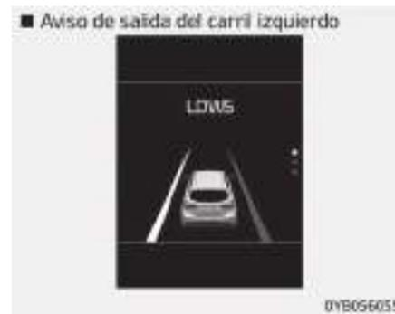
Al seleccionar el visualizador de viaje, el modo de sistema de aviso de salida de carril (LDW) aparecerá en la pantalla LCD.
