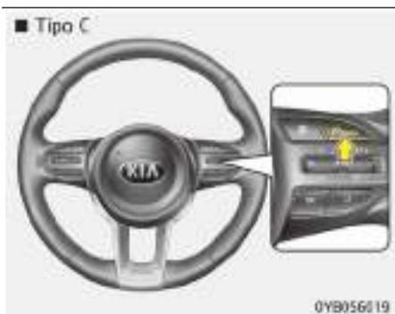
1. Pulse el botón de cruceo /CRUISE/MODE en el volante para activar el sistema. El testigo indicador de cruceo se iluminará.
