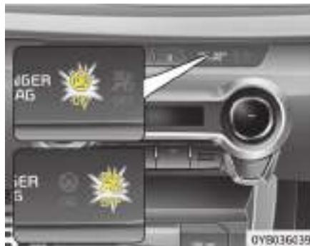
Para desactivar el airbag delantero del acompañante, inserte la llave maestra en el interruptor de activación / desactivación (ON/OFF) del airbag delantero del acompañante y gírela a la posición de desactivación. El indicador OFF del airbag delantero del acompañante (⚠) se ilumina y permanece encendido hasta que se reactiva el airbag delantero del acompañante.
