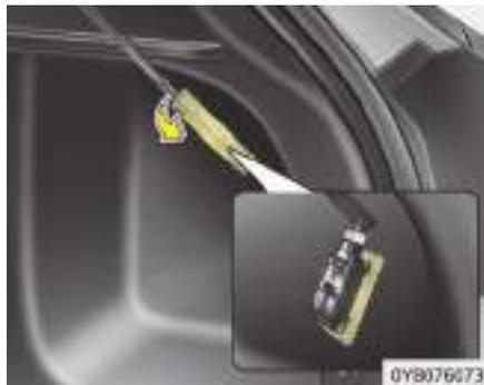
1. Con un destornillador de punta plana, haga un poco de palanca en la cubierta de la lente desde la carcasa.
