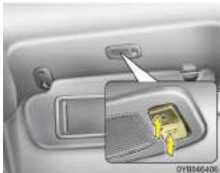
Pulse el interruptor para encender o apagar la luz.
