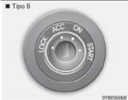
El volante está bloqueado como protección antirrobo. La llave de encendido solo se puede extraer en la posición LOCK (bloqueo).
