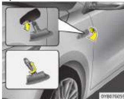
1. Desmonte el conjunto de las luces del vehículo haciendo palanca con la lente y tirando del conjunto hacia fuera.
