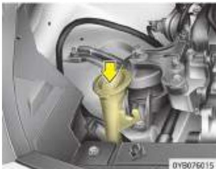
El depósito es translúcido para que pueda comprobar el nivel con una rápida comprobación visual.
