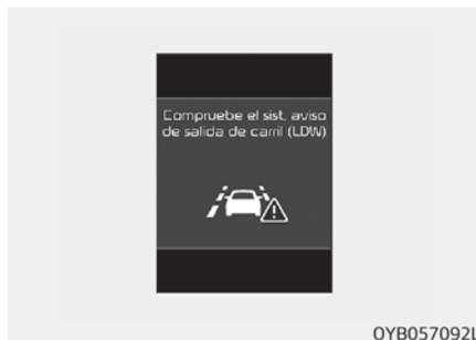
Si el sistema de aviso de salida del carril (LDW) no funciona correctamente, el testigo de advertencia se iluminará y aparecerá un mensaje de advertencia durante unos segundos. Cuando el mensaje desaparece, el testigo de advertencia maestro se ilumina. En este caso, solicite la comprobación del sistema en un taller profesional. Kia recomienda visitar un centro de servicio / distribuidor Kia autorizado.
