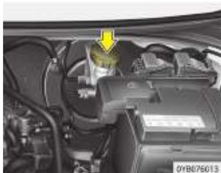
Compruebe periódicamente el nivel de líquido en el depósito. El nivel de líquido debe estar entre las marcas MIN y MAX situadas a un lado del depósito.
