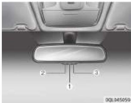
El retrovisor electrocrómico controla automáticamente el brillo de los faros del vehículo de detrás por la noche o condiciones de conducción con luces bajas. El sensor (3) montado en el retrovisor detecta la intensidad de iluminación alrededor del vehículo y ajusta automáticamente el brillo de los faros de los vehículos de detrás.
