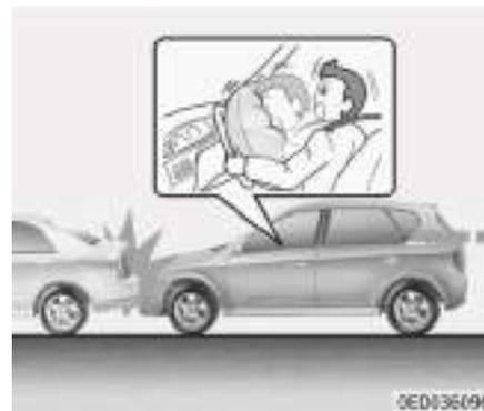
Los airbags delanteros están diseñados para inflarse en caso de colisión frontal dependiendo de la intensidad, la velocidad o los ángulos de impacto de dicha colisión.
