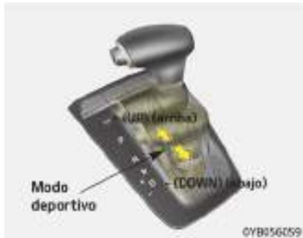
Tanto si el vehículo está parado o en movimiento, el modo deportivo se selecciona empujando la palanca de cambios de la posición D (conducción) a la corredera manual. Para regresar al margen operativo D (conducción), empuje la palanca de cambios de nuevo a la corredera principal.
