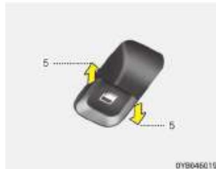
La puerta del conductor tiene un interruptor maestro de los elevallas eléctricos que controla todas las ventanillas del vehículo.
