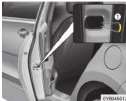
Si el interruptor de bloqueo automático de la puerta no se opera eléctricamente, la única manera de bloquear las puertas es con la llave mecánica desde el orificio para la llave exterior. Las puertas sin orificio para la llave exterior, se pueden bloquear del modo siguiente:
