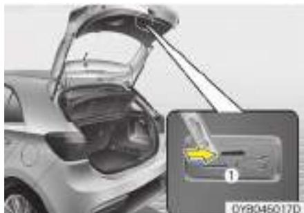
Su vehículo está equipado con una palanca de desbloqueo de seguridad del portón trasero ubicada en la parte inferior del portón. Cuando alguien se quede encerrado por error en el maletero. El portón trasero puede abrirse como sigue:
