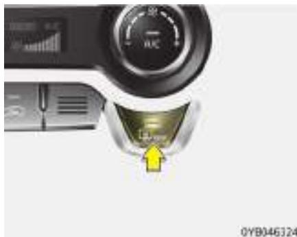
El desempañador calienta la luna trasera para eliminar la escarcha, la niebla, una capa fina de hielo de la luna trasera cuando el motor está encendido.
