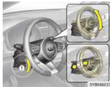
Para cambiar el ángulo del volante, tire hacia abajo la palanca de desbloqueo (1), ajuste el volante al ángulo deseado (2) y a la altura deseada (3, si está equipado); después tire hacia arriba de la palanca de desbloqueo para bloquear el volante en su sitio. Asegúrese de colocar el volante de dirección en la posición que desee antes de conducir.
