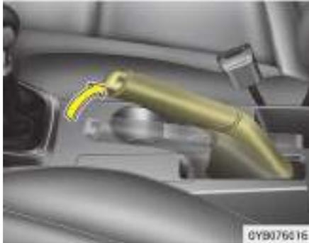
Compruebe el recorrido del freno de estacionamiento contando el número de "clicks" que se escuchan al levantarlo completamente desde la posición de desenganche. El freno de estacionamiento también debe mantener el vehículo de forma segura en pendientes pronunciadas. Si la carrera es superior o inferior al valor especificado, solicite el mantenimiento del sistema en un taller profesional. Kia recomienda visitar un centro de servicio / distribuidor Kia autorizado.
