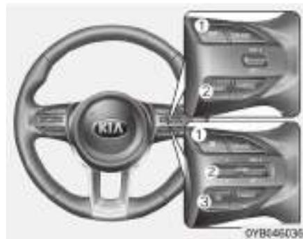
Los modos de la ventana LCD se pueden cambiar usando los botones de ajuste en el volante.
