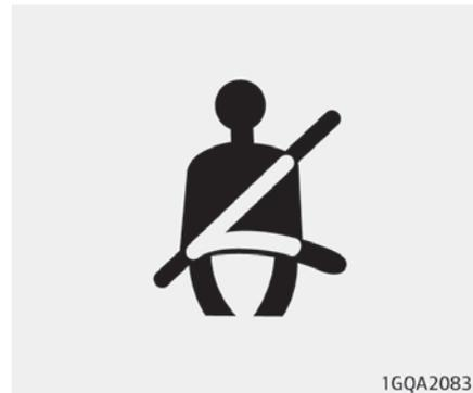
Como recordatorio de los cinturones de seguridad delanteros, los testigos de advertencia de los cinturones de seguridad delanteros se encenderán durante aproximadamente 6 segundos cada vez que se coloca el interruptor de encendido en ON sin tener en cuenta si el cinturón está o no abrochado.
