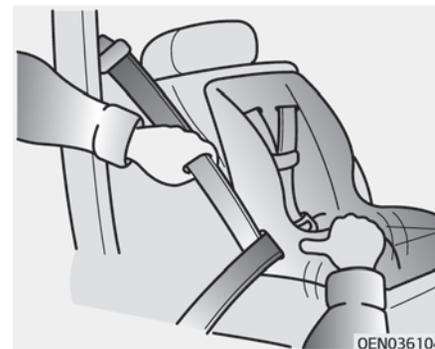
3. Elimine la mayor cantidad de holgura del cinturón como sea posible empujando el sistema de sujeción para niños hacia abajo mientras hace regresar la parte del hombro del cinturón de seguridad al interior del retractor.
