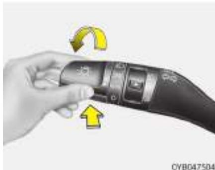
La asistencia de luces de carretera es un sistema que ajusta automáticamente el margen de los faros (cambia entre luces de carretera y luces de cruce) según el brillo de otros vehículos y las condiciones de la carretera.
