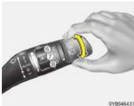
El interruptor del limpia y lavaparabrisas de la luna trasera está colocado en el extremo de la palanca del interruptor del limpia y lavaparabrisas. Coloque el interruptor en la posición deseada para accionar el limpia y el lavaparabrisas.
