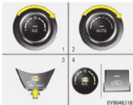
1. Ajuste la velocidad del ventilador a la mayor posición (extremo derecho).
