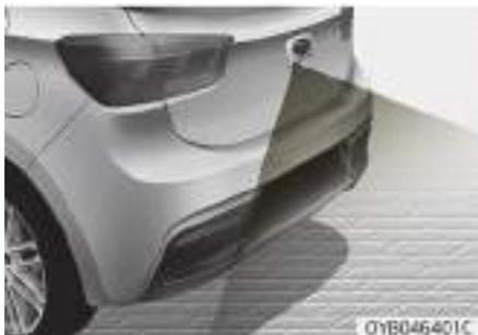
La cámara de visión trasera se activará cuando se encienda la luz de marcha atrás con el interruptor de encendido en ON y la palanca de cambios en la posición R (marcha atrás).
