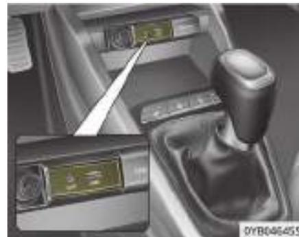
Puede utilizar el puerto AUX para conectar los dispositivos de audio y un puerto USB para conectar un dispositivo USB o iPod®.
