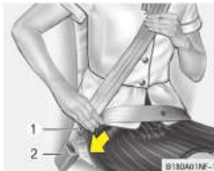
Para abrochar el cinturón, sáquelo del retractor e introduzca la lengüeta metálica (1) en la hebilla (2). Se escuchará un "clic" cuando la lengüeta quede bloqueada en la hebilla.
