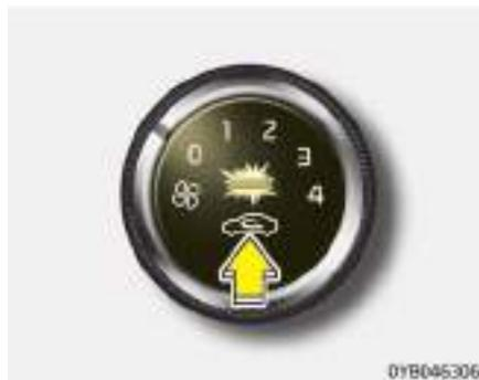
El control de toma de aire se emplea para seleccionar la posición del aire (fresco) exterior o la posición del aire recirculado.
