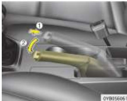
Para dejar de usar el freno de estacionamiento, en primer lugar pise el freno de pie y tire ligeramente de la palanca del freno de estacionamiento. A continuación, pulse el botón de liberación (1) y baje la palanca del freno de estacionamiento (2) mientras sostiene el botón.
