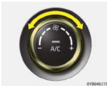
La velocidad del ventilador puede ajustarse a la velocidad deseada accionando el mando de control de velocidad de ventilador.
