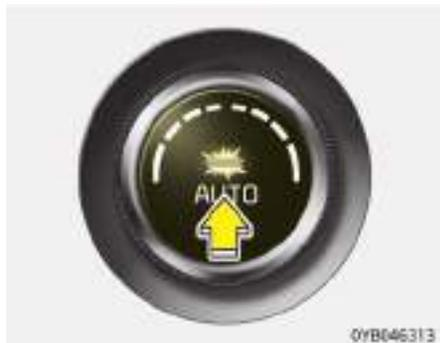
1. Pulse el botón AUTO. Los modos, las velocidades del ventilador, la toma de aire y el aire acondicionado se controlan automáticamente según el ajuste de temperatura.
