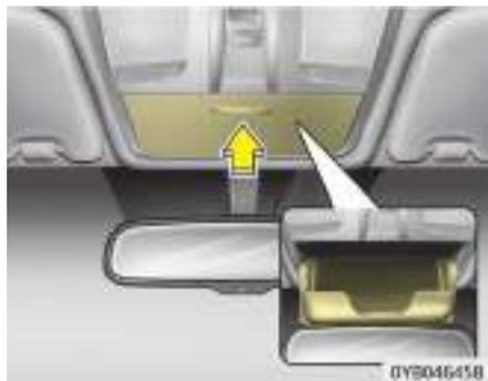
Para abrir el soporte para las gafas de sol, presione la cubierta y el soporte se abrirá despacio. Coloque las gafas de sol con las lentes hacia fuera. Para cerrar el soporte de las gafas de sol, levántelo hacia arriba.
