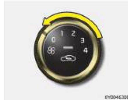
Para las toberas de salida de aire, coloque el mando de control de la velocidad del ventilador a la posición "0".
