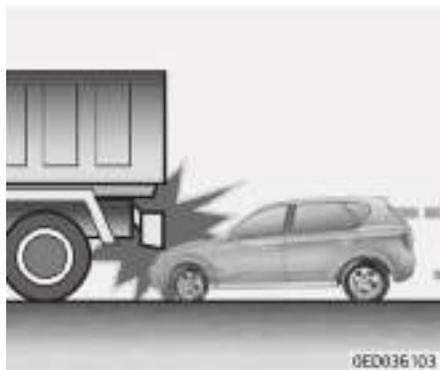
• Normalmente, los conductores frenan con mucha fuerza justo antes del impacto. Estas frenadas fuertes bajan la parte delantera del vehículo provocando que "conduzca" un vehículo con una mayor holgura con el suelo. Los airbags podrían no inflarse en estas situaciones de "infra-conducción" porque las fuerzas de deceleración que se detectan en los sensores podrían verse muy reducidas en dichas colisiones de "infra conducción".
