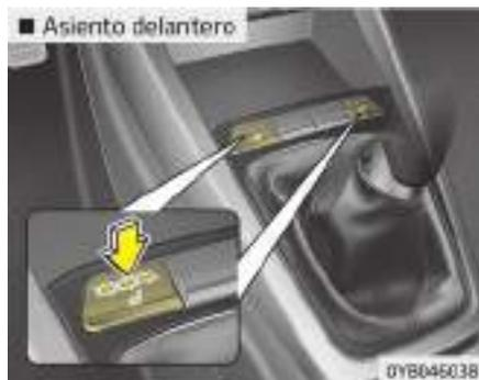
La calefacción de asientos proporciona calor a los asientos delanteros en condiciones ambientales frías. Cuando el interruptor de encendido está en la posición ON, pulse cualquiera de los interruptores para calentar el asiento del conductor y el asiento del pasajero delantero.
