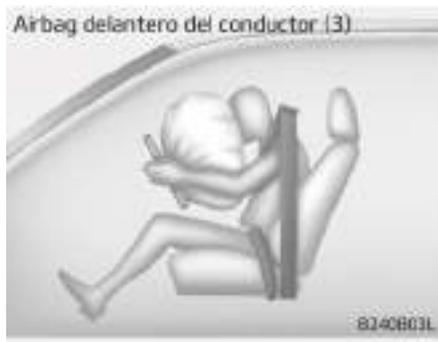
Un airbag completamente inflado, en combinación con un cinturón correctamente colocado, aminora el movimiento hacia delante del conductor y del acompañante, reduciendo el riesgo de lesiones en cabeza y pecho.
