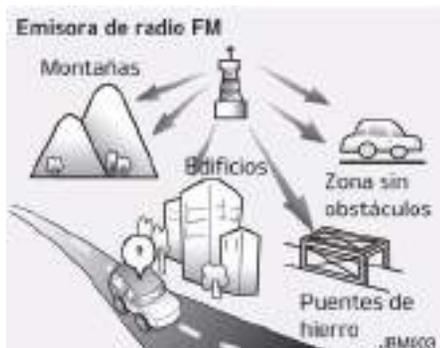
Las emisoras FM se transmiten a altas frecuencia y no toman la curva de la superficie de la tierra. Debido a ello, las retransmisiones FM suelen empezar a perder intensidad a cortas distancias de la emisora. Asimismo, las construcciones, montañas u otros obstáculos afectan de manera más fácil las señales FM. Ello afecta a las condiciones de escucha y le haría creer que su radio tiene problemas. Las siguientes condiciones son normales y no indican un problema de la radio:
