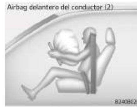
Los módulos del airbag están situados en el centro del volante de la dirección y en el panel del pasajero delantero sobre la guantera. Cuando el SRSCM detecta un impacto fuerte en la parte delantera del vehículo, se desplegarán automáticamente los airbags delanteros.
