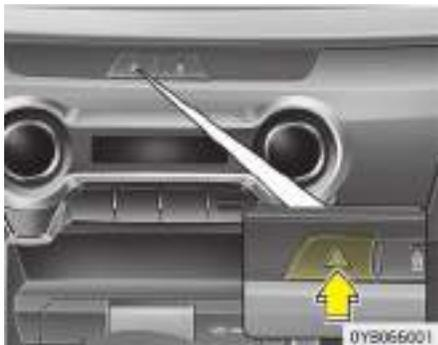
Las luces de emergencia sirven para avisar a los demás conductores de que extremen las precauciones cuando se aproximen o adelanten su vehículo. Deben utilizarse cada vez que se realice una reparación de emergencia o cuando detenga el vehículo cerca de la orilla de la carretera.
