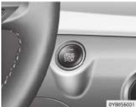
Cada vez que se abre una puerta delantera, el botón ENGINE START/STOP (inicio/parada del motor) se iluminará como ayuda. La luz se apaga 30 segundos después de cerrar la puerta. Se apagará inmediatamente cuando se active el sistema de alarma.
