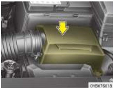
Debe cambiarse cuando sea necesario, no debe limpiarse. Puede limpiar el filtro al comprobar el elemento purificador de aire. Limpie el filtro usando aire comprimido.
