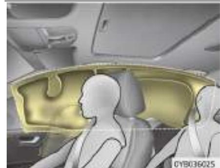
En las guías del techo de ambos lados, encima de la columna central, se encuentran los airbags de cortina.
