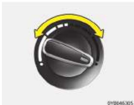
El mando de control de temperatura permite controlar la temperatura del aire que fluye por el sistema de ventilación. Para cambiar la temperatura del aire en el compartimento de pasajeros, gire el mando a la posición derecha para calentar el aire y hacia la posición izquierda para enfriarlo.
