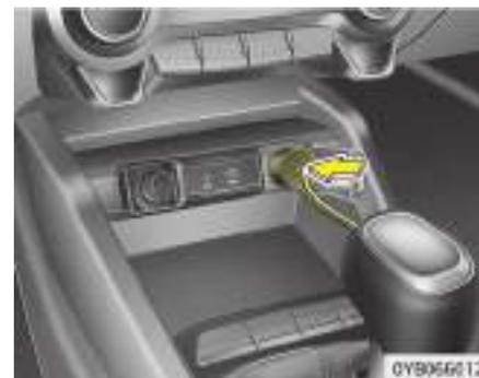
9. Conecte el compresor a la toma de corriente del vehículo con el cable y los conectores.
