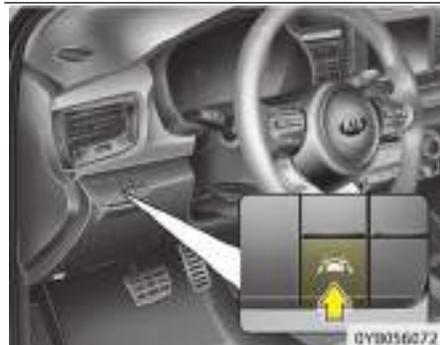
El sistema detecta el carril con el sensor situado en el parabrisas delantero y le avisa cuando el vehículo se sale del carril.
