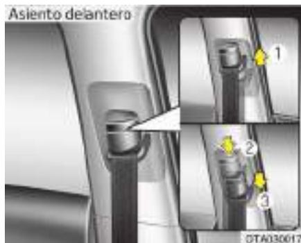
Para mayor confort y seguridad se puede ajustar la altura del cinturón de hombros a una de las 3 posiciones.
