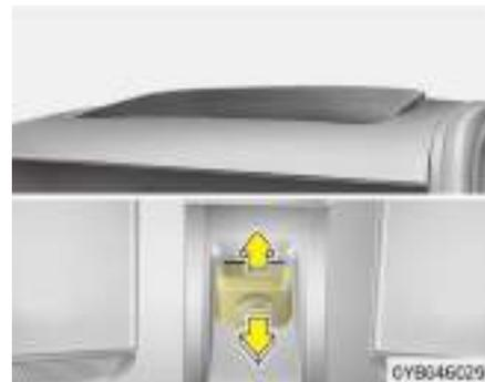
Para abrir el techo solar, empuje de la palanca de control del techo solar hacia arriba hasta colocar el techo solar a la posición deseada. Para cerrar el techo solar, empuje de la palanca del techo solar hacia delante hasta colocar el techo solar a la posición deseada.
