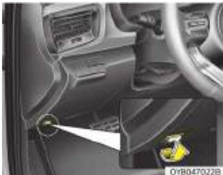
1. Para soltar el cierre del capó, tire de la palanca de apertura. El capó debería saltar y abrirse ligeramente.
