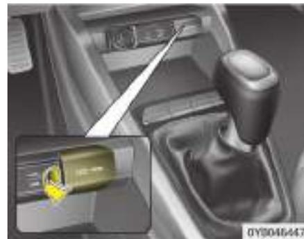
La toma de corriente está diseñada para proporcionar potencia a teléfonos móviles u otros aparatos eléctricos diseñados para funcionar con el sistema eléctrico del vehículo. Estos aparatos deben tener una potencia de menos de 10 amperios con el motor funcionando.
