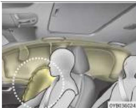
Su vehículo está equipado con un airbag de impacto lateral en cada uno de los asientos delanteros. El propósito del airbag es proporcionar una protección adicional al conductor y al pasajero delantero, más allá de la ofrecida por el cinturón.
