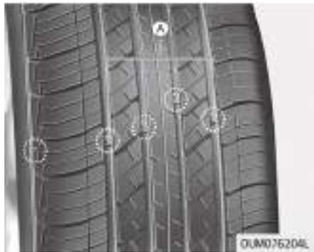
Si el neumático está desgastado de manera uniforme, el indicador del desgaste de la banda de rodadura (A) aparecerá como una banda sólida a lo largo de la banda de rodadura. Esto indica que queda una banda de rodadura en el neumático inferior a 1,6 mm. Reemplace el neumático cuando esto ocurra. No espere a ver que la banda atraviese toda la rodadura antes de cambiar el neumático.
