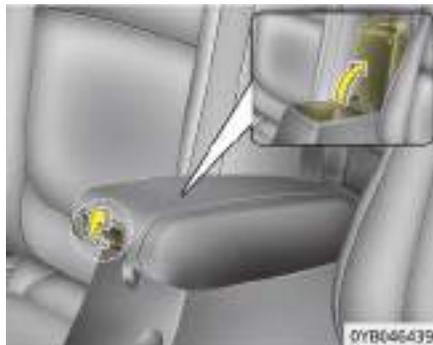
Estos compartimentos se pueden utilizar para almacenar pequeños elementos que necesiten tanto el conductor como el acompañante. Para abrir el compartimento de la consola central, tire hacia arriba de la palanca.
