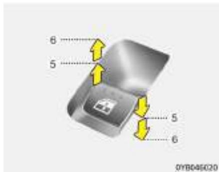
Pulsando o tirando del interruptor del elevalunas eléctrico momentáneamente a la segunda posición de detención (6) se baja o se sube completamente la ventanilla incluso aunque se suelte el interruptor. Para detener la ventanilla en la posición que desea mientras está operando, tire o pulse y suelte el interruptor en la dirección opuesta al movimiento.
