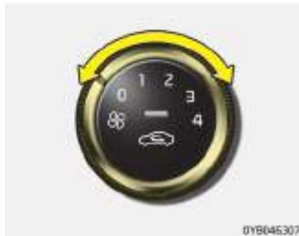
El interruptor de encendido debe estar en la posición ON para hacer funcionar el ventilador.
