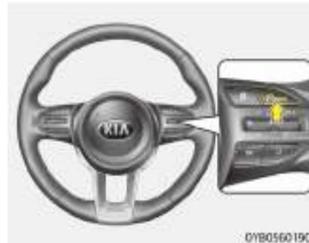
1. Pulse dos veces el botón del límite de velocidad
