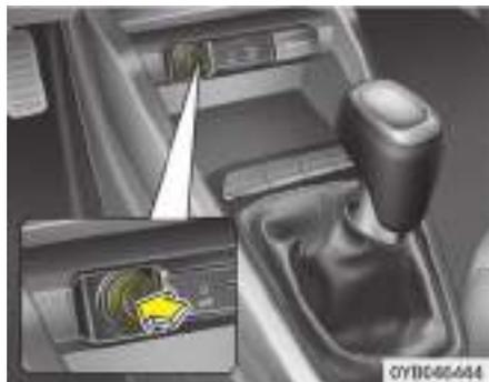
Para que el encendedor funcione, el interruptor de encendido debe estar en la posición ACC (accesorios) u ON (activado).
