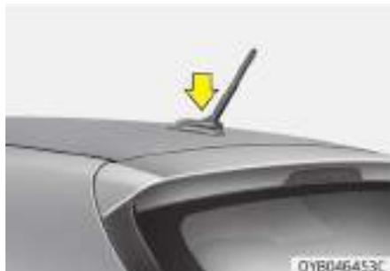
Su vehículo utiliza una antena para recibir las señales de emisión de AM y FM. Esta antena puede desmontarse. Para desmontar la antena, gírela en sentido antihorario. Para montar la antena, gírela en sentido horario.
