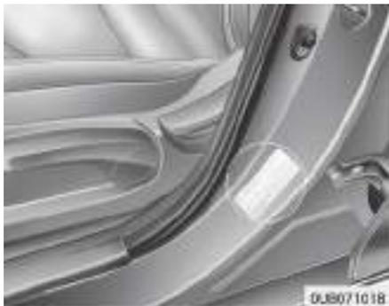
Los neumáticos de su nuevo vehículo se han elegido para ofrecer el rendimiento óptimo durante la conducción normal. La etiqueta del neumático en la columna central del lado del conductor muestra la presión de los neumáticos recomendada para el vehículo.
