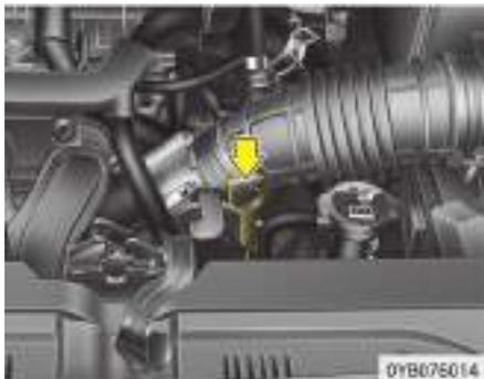
El nivel del líquido de la transmisión automática debe comprobarse regularmente.
