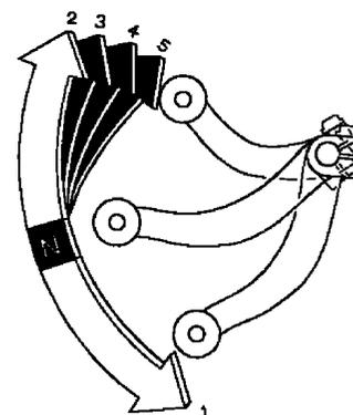
5. Levante el pedal para cambiar a una marcha más larga y pise el pedal para cambiar a una marcha más corta. Cada movimiento del pedal permite pasar a la siguiente velocidad. El pedal vuelve automáticamente a la posición horizontal al soltarlo.
