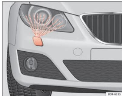
Fig. 102 Faro con eyector de lavado desplegado
