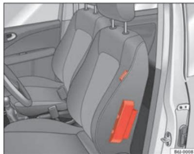
**Fig. 23** Airbag lateral en el asiento del conductor
