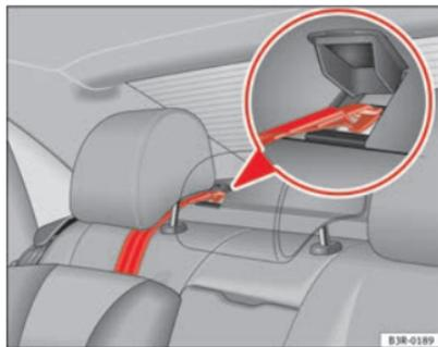
Fig. 35 Correa de sujeción: correcto ajuste y montaje
