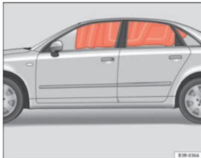
Fig. 26 Airbags para la cabeza inflados
