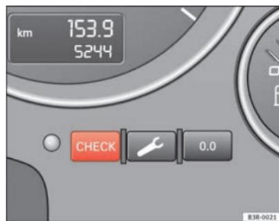
Fig. 53 Cuadro de instrumentos: Tecla CHECK
