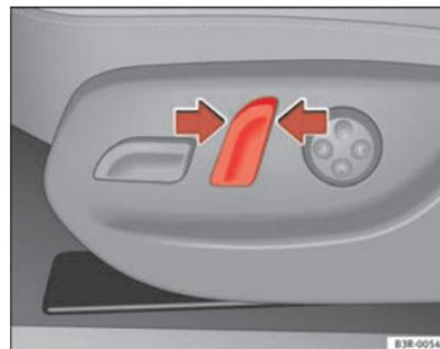
Fig. 108 Asiento delantero: Mando para la inclinación del respaldo
