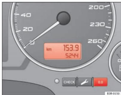
Fig. 42 Detalle del cuadro de instrumentos: Cuentakilómetros
