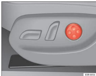
Fig. 109 Asiento delantero: Placa reguladora para apoyo lumbar
