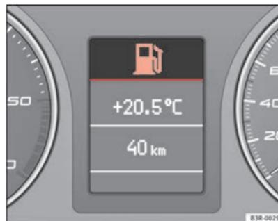
Fig. 55 Pantalla: Nivel de combustible bajo
