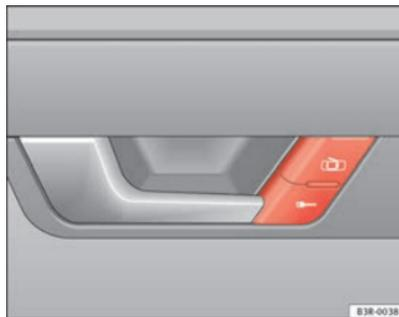
**Fig. 71** Detalle de la puerta del conductor: Conmutador del cierre centralizado
