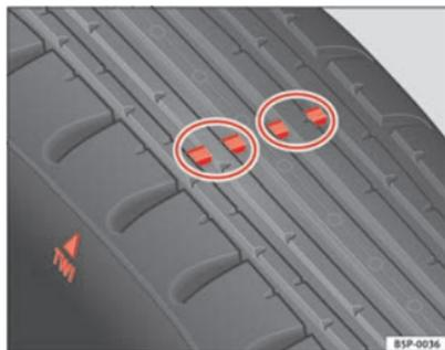
Fig. 174 Indicadores de desgaste del perfil del neumático
