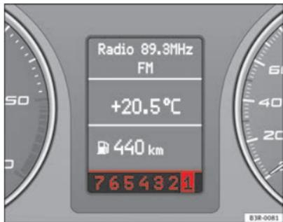
Fig. 147 Pantalla: Cambiar las marchas manualmente (modo tiptronic)
