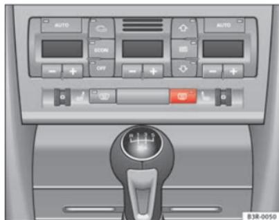
Fig. 97 Interruptor para luneta térmica
