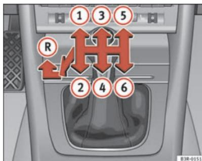
Fig. 142 Detalle de la consola central: esquema de un cambio manual de 6 marchas
