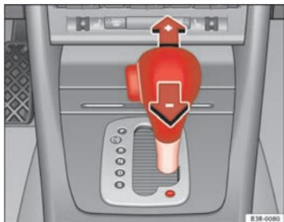
Fig. 146 Consola central: Cambiar las marchas manualmente (modo tiptronic)
