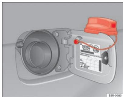
Fig. 163 Tapa del depósito con el tapón encajado
