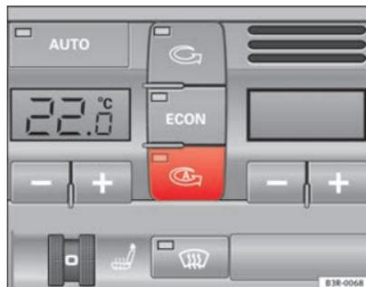
Fig. 131 Tecla para la recirculación de aire automática
