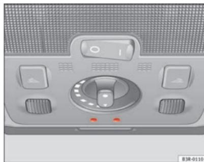
**Fig. 94** Detalle del revestimiento del techo: Iluminación ambiental
