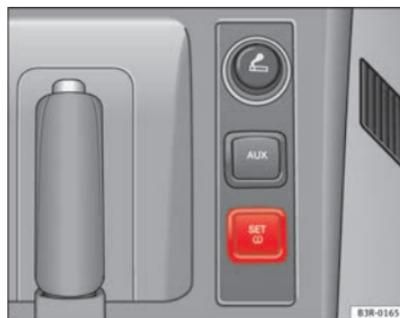
Fig. 173 Detalle de la consola central: Tecla del indicador de la presión de los neumáticos
