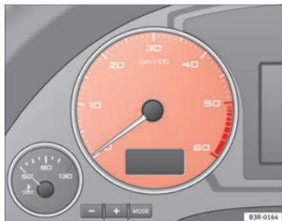
Fig. 39 Detalle del cuadro de instrumentos. Cuentarrevoluciones
