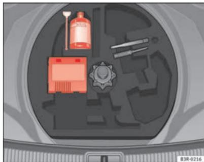
Fig. 177 Juego para reparación de neumáticos (tire mobility system) debajo de la superficie de carga del maletero
