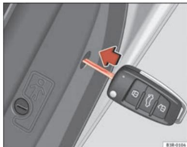
Fig. 73 Activar el bloqueo de emergencia
