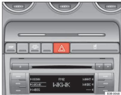
**Fig. 91 Consola central: Interruptor para intermitentes simultáneos de emergencia**
