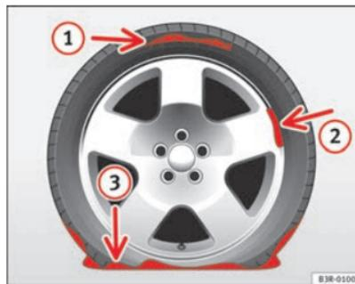
Fig. 184 Pinchazos para los que no se adecua el sistema tire mobility system
