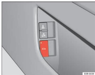
Fig. 74 Puerta del conductor: Desbloquear el portón trasero
