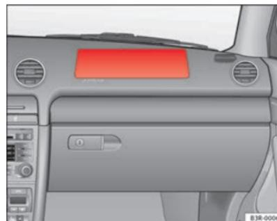
**Fig. 18** Airbag del acompañante en el tablero de instrumentos
