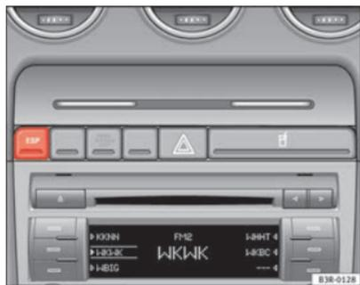
Fig. 149 Consola central con el interruptor del ESP
