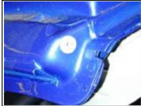
Sustituir la muela de fijación del embellecedor si estuviera perforada.
