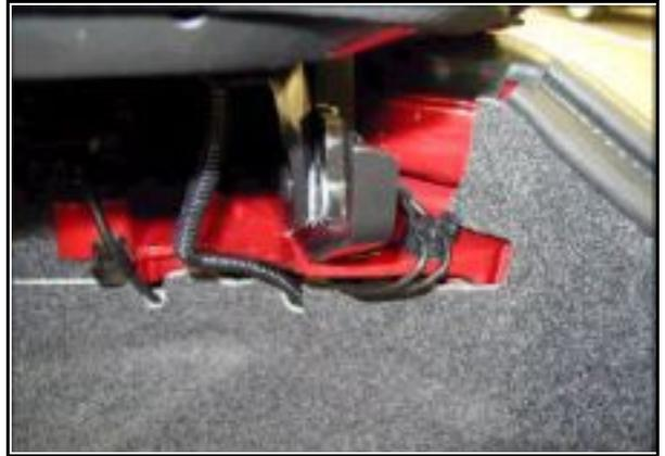
Controlar si hay presencia de agua sobre el soporte del techo, visible por el maletero y posibilidad de presencia de agua en el recipiente de la rueda de repuesto.
