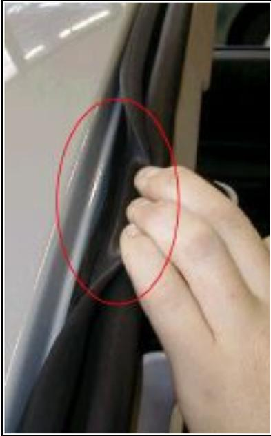
Verificar el correcto posicionamiento de la junta (la junta debe estar correctamente calzada)
