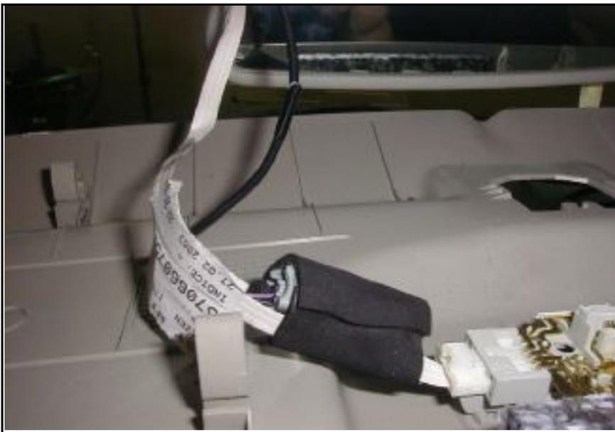
Encajar el conector en la ebanistería. Si esto no es posible, inmovilizar el conector en el cableado del iluminador del plafonier con ayuda de un taco de espuma.
