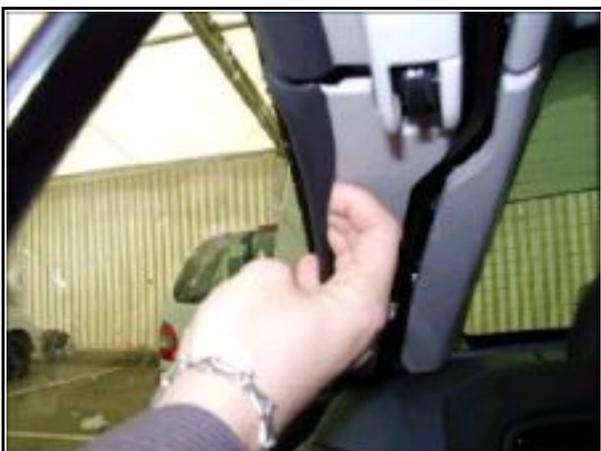
Controlar si hay presencia de agua en el panel de custodia en la esquina trasera, lado habitáculo y bajo el labio de revestido de la junta de custodia.
