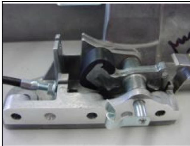
Enroscar la rosca sobre el soporte unos **10 mm** en el pre-montaje.
