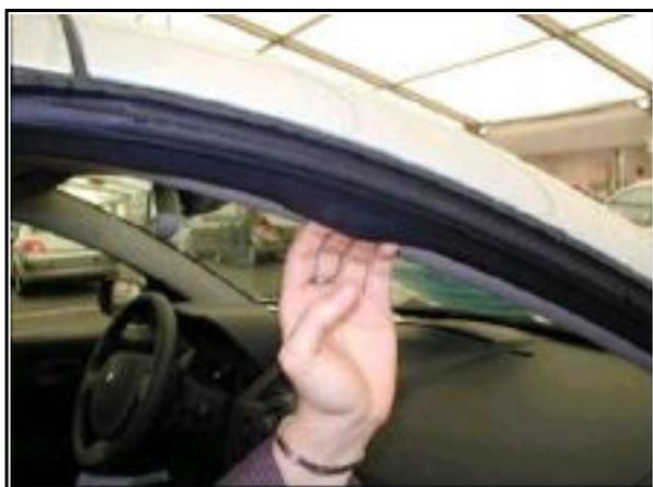
Controlar si hay presencia de agua bajo el labio de revestido del montante del vano y en la parte inferior del pie delantero.
