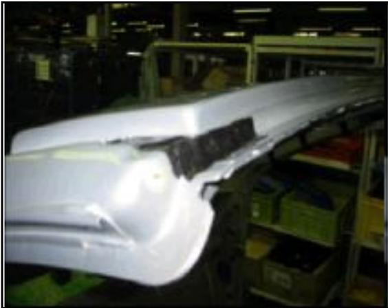
Verificar la presencia y el posicionamiento del butilo bajo la junta en el ángulo superior del montante del vano.
