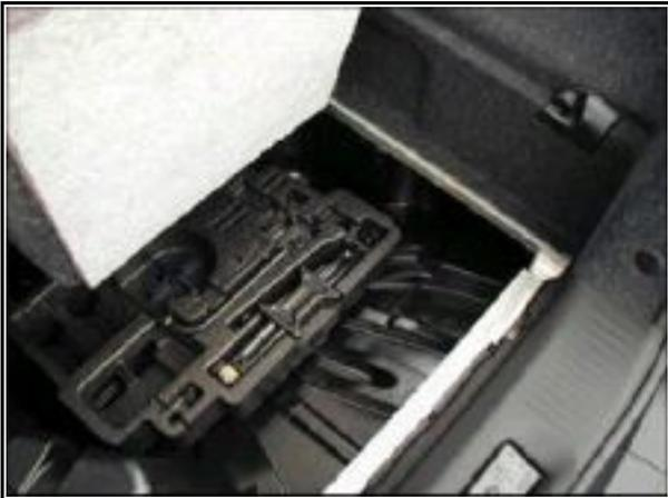
Controlar si hay presencia de agua en el receptáculo de la rueda de repuesto y bajo la moqueta del maletero.
