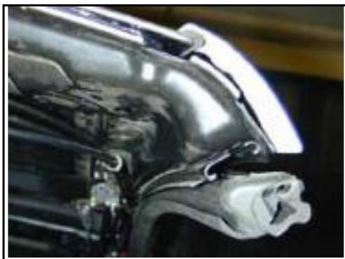
Verificar la presencia y el posicionamiento de la espuma bajo el embellecedor del marco delantero del techo.
