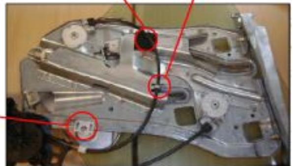
**Si el cursor presenta un juego axial importante, cambiar el mecanismo completo** para un mecanismo conforme (sin juego axial del cursor).
