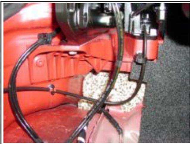
Sustituir las grapas de sujeción y respetar la higiene del cable.
