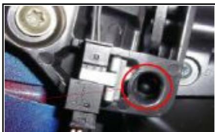
Controlar el ensamblado del centrador.
