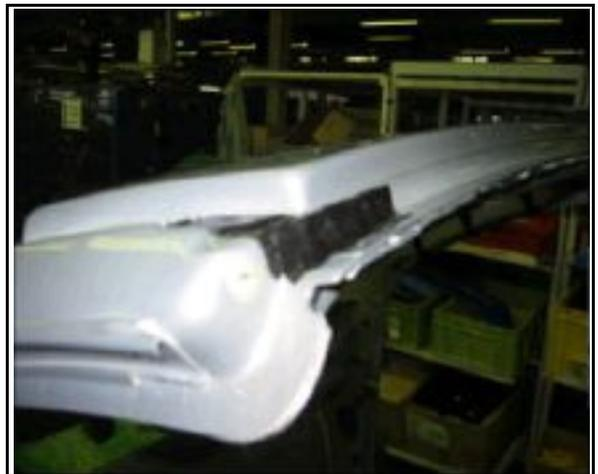
Posicionamiento del butilo bajo la junta en el ángulo superior del montante del vano, como se indica en la foto anterior.
