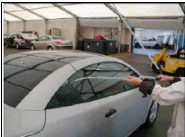
Si hay entrada de agua solamente en los cristales a la altura de la unión cristal de custodia/cristal delantero, no retocar.
