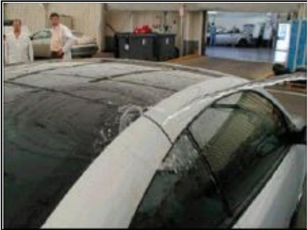
Poner el chorro de agua a **20 cm** del techo y rociar a la velocidad de **30 cm/s**, en la unión de los 2 embellecedores del techo durante **30 s**.
