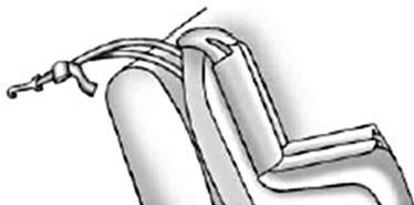
Si está usando una correa doble en una posición de asiento del lado de la ventana y se ha retirado la cabecera, guíe la correa por encima del respaldo.
