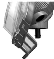
6. Reinstale el soporte en el faro y gírelo en el sentido de las manecillas del reloj hasta que el centro del soporte del foco se encuentre en la figura de flecha del faro.
