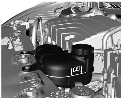
Si el sistema de enfriamiento está frío, el nivel del refrigerante debería estar arriba de la línea de la marca de llenado.
