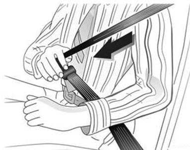
Extraiga el cinturón del retractor, guíelo sin retorcer de un extremo al otro del cuerpo e inserte la placa de seguro en la hebilla. Apriete el
