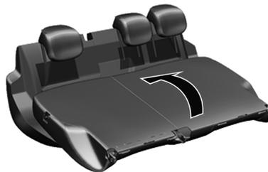
4. Pliegue el respaldo hacia adelante y hacia abajo.
