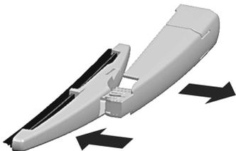
Levante el brazo del limpiador. Empuje la pluma en ángulo sobre el brazo del limpiaparabrisas, hacia abajo hasta que se libere.
