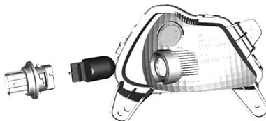
2. Desconecte el conector eléctrico del soporte del foco.
