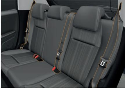
Cada una de las plazas traseras va equipada con un cinturón de seguridad provisto de tres puntos de anclaje y, en las plazas laterales, de limitador de esfuerzo.
