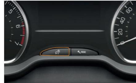
Con las luces encendidas pulse el botón para modificar la intensidad luminosa del puesto de conducción.
