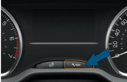
Después de cada revisión, debe poner a cero el indicador de mantenimiento.
