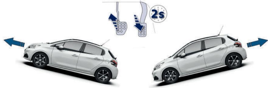
**Con el vehículo parado en pendiente ascendente, éste se mantiene inmovilizado un instante después de soltar el pedal del freno:**
