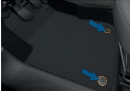
Para el primer montaje de la cubrealfombra del lado del conductor, utilice exclusivamente las fijaciones que se incluyen. Las demás cubrealfombras simplemente se colocan sobre la alfombra.
