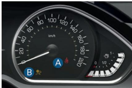
A. Testigo de cinturón del conductor desabrochado.
