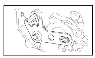
**INSTALLING THE SHIFT SHAFT**
