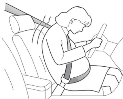
La sección diagonal del cinturón de seguridad debe pasar por el pecho de forma normal, la parte del cinturón debe pasar por debajo del abdomen bajo y ajustado a los huesos de la cadera. **NUNCA** coloque el cinturón sobre o arriba del vientre.
