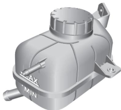
El nivel de refrigerante debe verificarse semanalmente cuando el sistema de enfriamiento está frío y con el automóvil detenido sobre una superficie nivelada.
