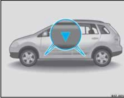
Fig. 169 Puntos de apoyo para el crিকে
