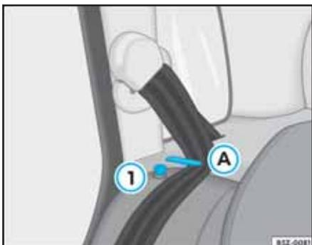
Fig. 88 Posicionador de las cintas de los cinturones de seguridad para el rebatimiento del asiento
