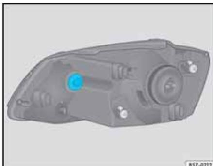
Fig. 179 Localización de la lámpara del indicador de dirección delantero
