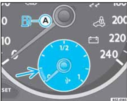
Fig. 37 Indicador del nivel de combustible
