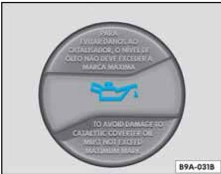
**Fig. 148** Tapa de la boca de llenado de aceite de Motor
