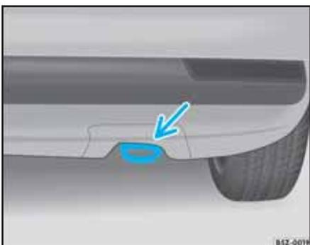
[Fig. 194](#) Argolla de remolque trasera
