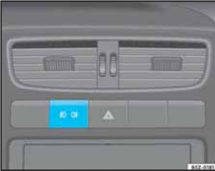
Fig. 70 Interruptor de funcionamiento de los faros/luz antiniebla
