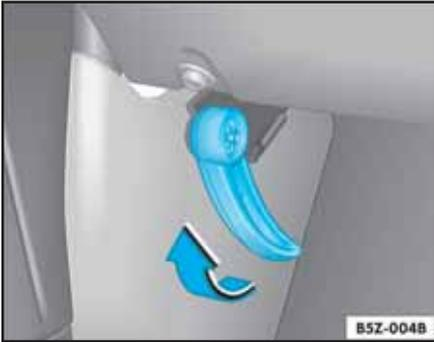
Fig. 144 Detalle del área de los pies al lado del conductor: Palanca de desbloqueo del capó
