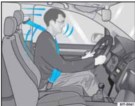
**Fig. 12** Conductor con cinturón de seguridad correctamente ajustado durante una frenada brusca
