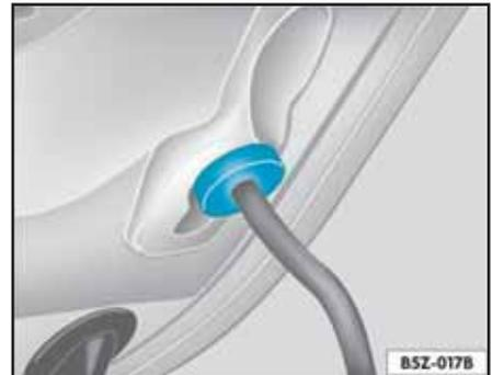
Fig. 146 Varilla de sostenimiento del capó
