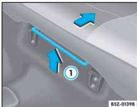
Fig. 93 Palanca de ajuste longitudinal
