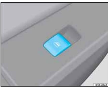
Fig. 68 Interruptor del accionamiento eléctrico en la puerta trasera
