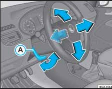
Fig. 123 Ajuste de la columna de dirección
