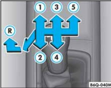
Fig. 126 Esquema de cambio de velocidades
