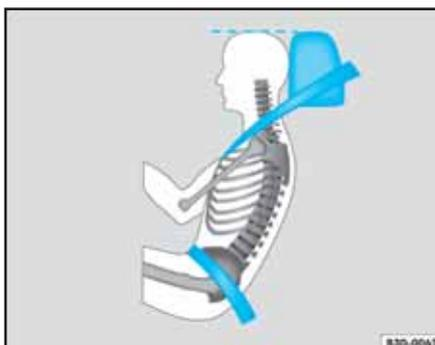
Fig. 17 Posición del cinturón de seguridad y del apoyacabezas correctos, vistos de lado
