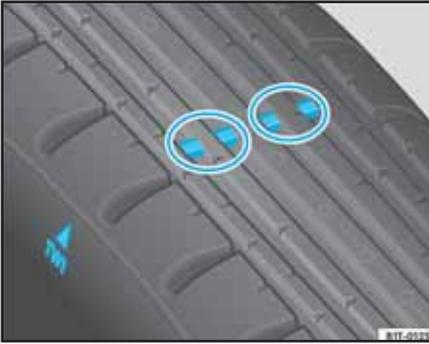
Fig. 157 Representación del perfil del neumático: indicadores de desgaste
