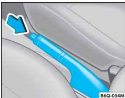
Fig. 136 Palanca de freno de mano ubicada entre los asientos delanteros
