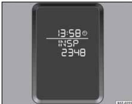
Fig. 40 Indicador del próximo servicio. La figura muestra, como ejemplo, el display de un vehículo sin sistema interactivo de informaciones o sin computadora integrada.
