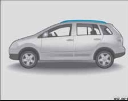
Fig. 118 Soportes longitudinales del portaequipajes del techo
