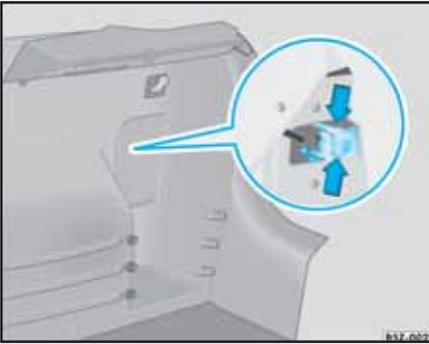
Fig. 190 Soporte de las lámparas en el conjunto luces traseras
