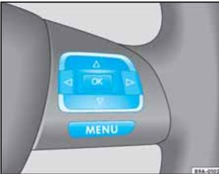
Fig. 45 Volante multifunciones: lado derecho.
