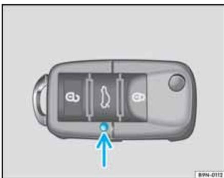
**Fig. 60** Luz piloto de la batería en la llave con mando a distancia
