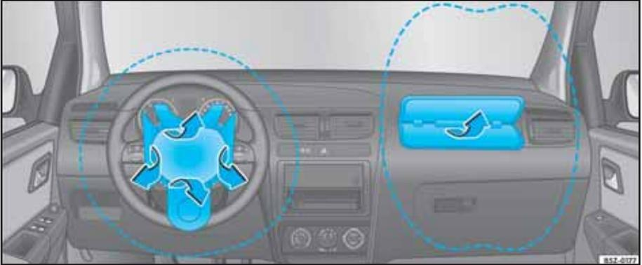
Fig. 27 Rayo de acción y cubiertas de los airbags en caso de accionamiento
