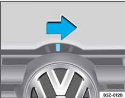
Fig. 145 Detalle de la rejilla del radiador: traba de seguridad para abrir el capó
