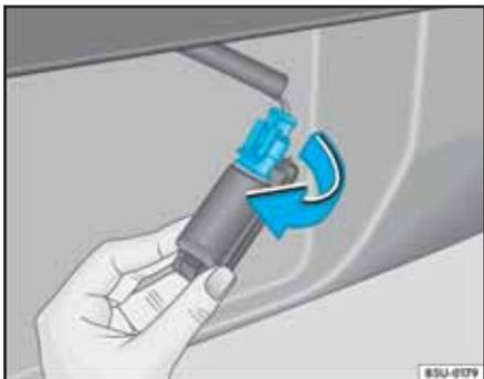
Fig. 189 Luz de la placa de matrícula
