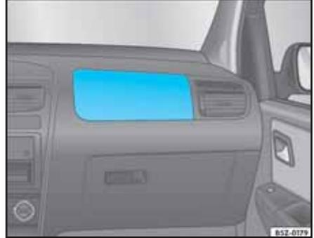
Fig. 24 Localización del airbag del pasajero del asiento delantero: en el panel instrumentos
