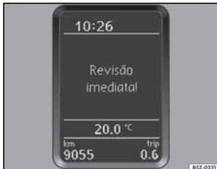
Fig. 39 Indicador del próximo servicio. La figura muestra, como ejemplo, el display de un vehículo con sistema interactivo de informaciones o con computadora integrada.
