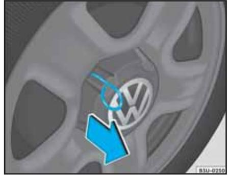
**Fig. 166** Retirar el tapón central con el enganche metálico
