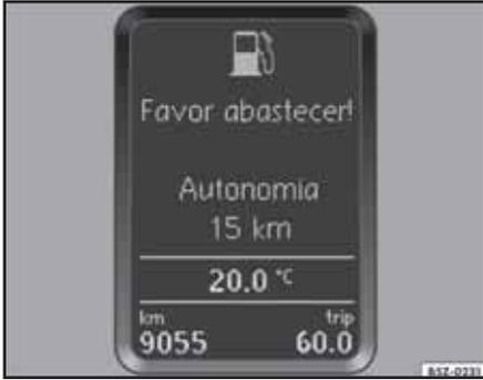
Fig. 50 Luz indicadora del nivel de combustible y texto de alerta en el display
