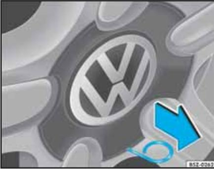
**Fig. 165** Retirar el tapón central con el enganche metálico
