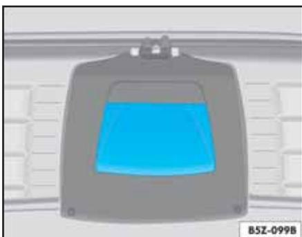
Fig. 64 Detalle del revestimiento interno de la tapa del maletero: rebaje para cerrar
