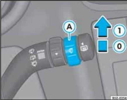
Fig. 79 Palanca de limpiaparabrisas y lavaparabrisas: ajuste de las configuraciones del sensor de lluvia (A)
