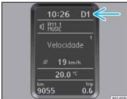
Fig. 130 Posiciones de la palanca selectora en el display: indicación de la palanca en el modo de conducción normal
