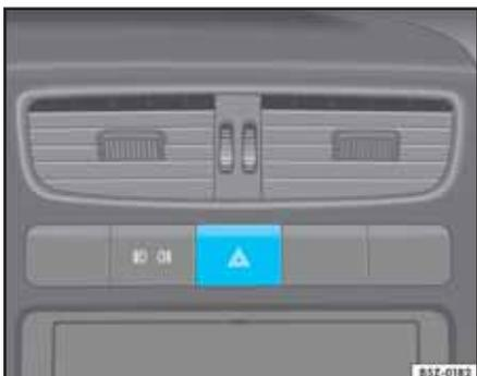
**Fig. 71** Detalle en el panel: Interruptor de las luces de emergencia
