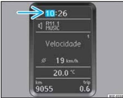
Fig. 38 Reloj en el display del panel de instrumentos: vehículos con sistema interactivo o con computadora integrada.
