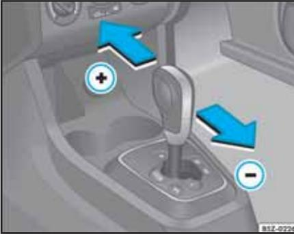
**Fig. 132** Palanca selectora de cambios de la transmisión automatizada
