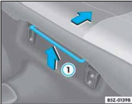
Fig. 100 Palanca de ajuste longitudinal
