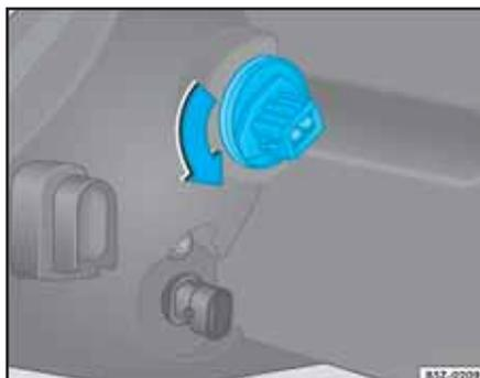
Fig. 180 Portalámparas de la lámpara del indicador de dirección delantero
