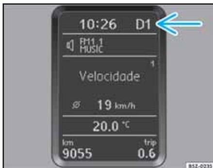
Fig. 128 Posiciones de la palanca selectora en el display: indicación de la palanca en el modo de conducción normal (Drive), con el 1º cambio colocado
