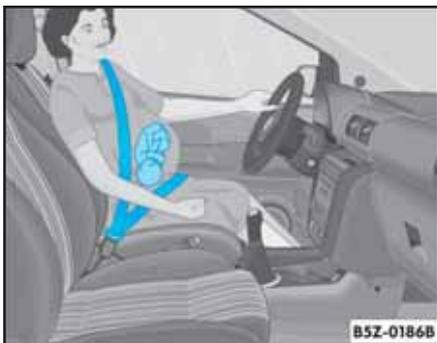
Fig. 20 Posición del cinturón de seguridad en mujeres embarazadas
