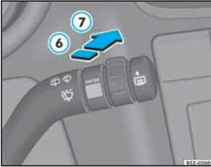
Fig. 77 Palanca del limpiador/lavador de la luneta
