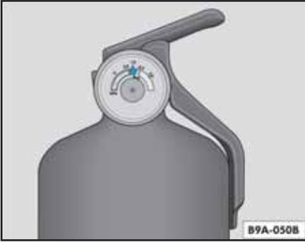
Fig. 159 Manómetro: indicador de carga
