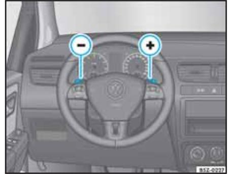
**Fig. 133** Volante multifunciones con selectores basculantes para la conmutación de cambios
