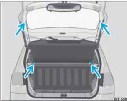
Fig. 117 Retirar y colocar la bandeja portaobjetos del baúl
