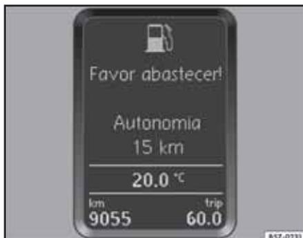
Fig. 49 Luz indicadora del nivel de combustible y texto de advertencia en el display
