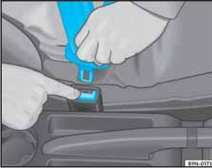
Fig. 21 Suelte la lengüeta del cierre del cinturón
