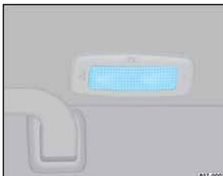
Fig. 74 Interruptor de las luces internas traseras.
