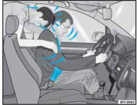
**Fig. 11** El ocupante del asiento trasero que no se abrocho el cinturón de seguridad es lanzado hacia adelante, por encima del conductor
