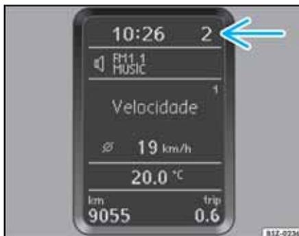
Fig. 129 Posiciones de la palanca selectora en el display: modo de conducción manual, con la 2ª marcha seleccionada
