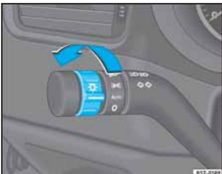
Fig. 69 Detalle en la palanca de los indicadores de dirección: interruptor de las luces
