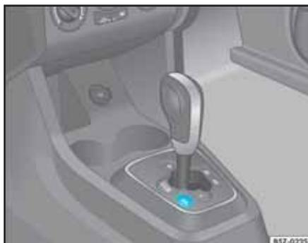
Fig. 131 Detalle de la consola central: tecla para accionamiento del modo deportivo
