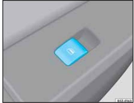
Fig. 66 Interruptores del accionamiento eléctrico de los vidrios en la puerta del acompañante
