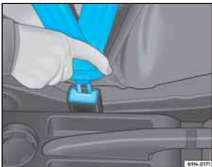
**Fig. 13** Cierre y lengüeta del cinturón de seguridad
