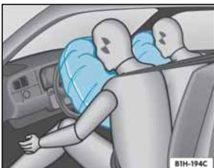
Fig. 26 Ilustración del funcionamiento: airbags insuflados
