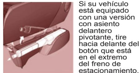
La palanca del freno de estacionamiento baja.
