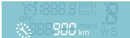
Unos segundos después de poner el contacto, sale señalado el nivel de aceite, y el totalizador kilométrico recobra su funcionamiento normal y la llave se queda encendida. Le señala que debe realizar próximamente una revisión.
