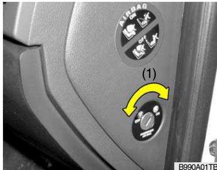
Se puede desactivar el airbag frontal del copiloto mediante el interruptor de activación/desactivación del airbag frontal del copiloto (1) si se instala un sistema de retención para niños o si el asiento del copiloto no está ocupado.
