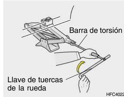
Tras introducir la barra de torsión en la llave de tuercas de la rueda, móntela en el gato como se ilustra en la figura. Para elevar el vehículo, gire la llave de tuercas en sentido horario. Cuando el gato empiece a levantar el vehículo chequee nuevamente que está adecuadamente puesto y así no resbalará. Si el gato está sobre un terreno blando o arena, es necesario colocar un trozo de madera, un ladrillo, una piedra plana u otro objeto bajo el gato para evitar el hundimiento.
