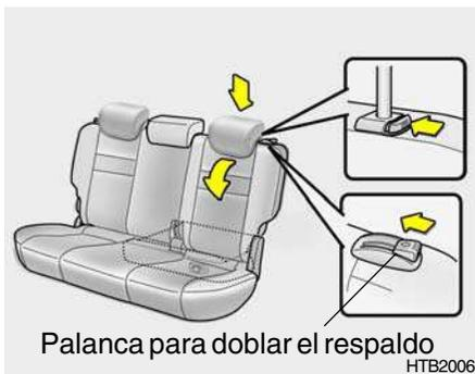
1. Empuje el reposacabezas completamente hacia abajo.
