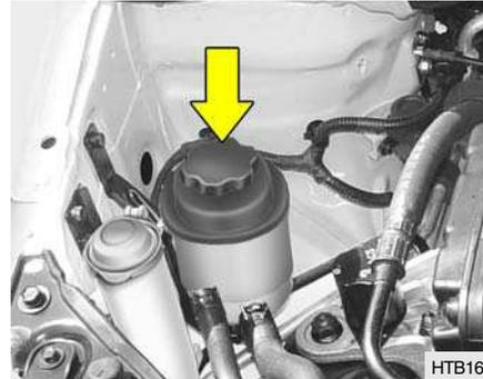
El nivel de líquido de la servodirección debe ser comprobado diariamente. Para verificar el nivel del líquido de la servodirección, asegúrese de que el contacto esté en "OFF", entonces usted podrá ver si éste se encuentra entre el "MAX" y "MIN" de las marcas de nivel en el depósito.
