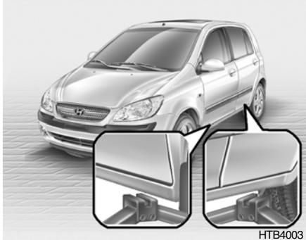
La base del gato debe apoyarse en un lugar firme y nivelado. Instalándola como se enseña en la figura.
