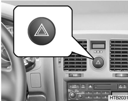
El sistema de warning debe ser usado cada vez que sea necesario detener el automóvil en un lugar de riesgo. Cuando usted necesite detenerse por una emergencia, siempre salga de la carretera tan lejos como le sea posible. Las luces de warning se encienden presionando el interruptor. Este activa las luces intermitentes delanteras y traseras de ambos costados de forma intermitente, aunque la llave de contacto sacada. Las luces se apagan presionando el interruptor por segunda vez.
