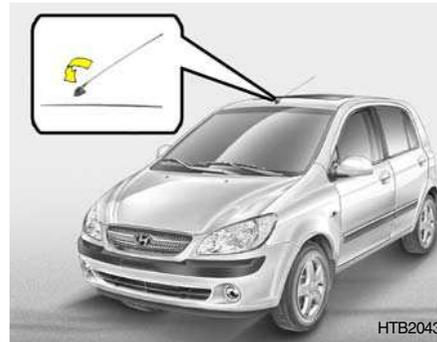
El vehículo tiene instalada una antena en el techo para recibir la emisión de AM y FM.
