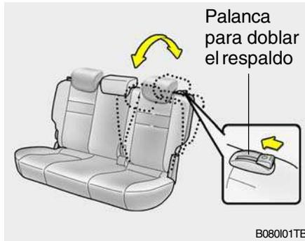
Para reclinar el respaldo, empuje la palanca del mismo hacia el reposacabezas y suéltela al alcanzar el ángulo de inclinación deseado.
