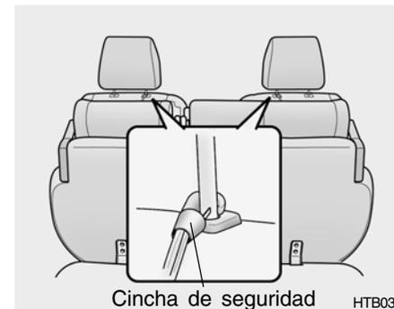
4. Para fijar el asiento, enganche la cincha de seguridad de debajo del respaldo en la barra del reposacabezas del asiento del conductor y del acompañante.
