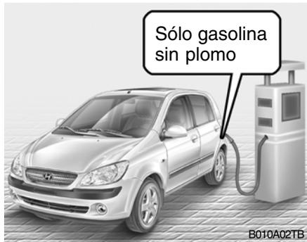
En el vehículo Hyundai deberá ser utilizada gasolina sin plomo con un Índice de Octano N° 91 o superior. Si fuera utilizada gasolina con plomo causaría un funcionamiento defectuoso del catalizador inutilizándolo y haciendo ineficaz su sistema de control de emisión de gases. Ello produciría además un costo adicional en los gastos de mantenimiento del vehículo.
