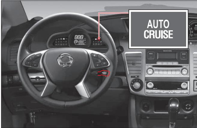
El control de velocidad es un sistema de control de velocidad automático que mantiene la velocidad de conducción deseada sin utilizar el pedal del acelerador.
