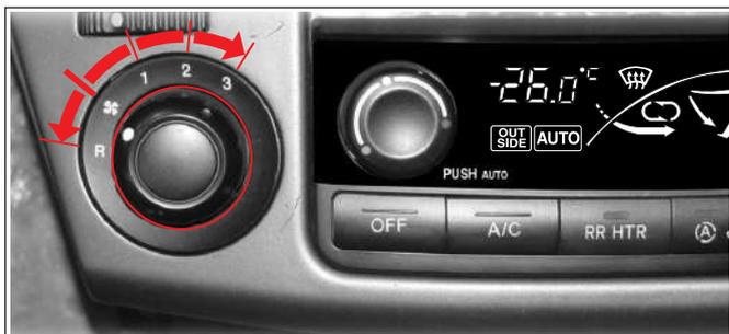
1. Coloque el interruptor de control del aire acondicionado trasero en cualquier posición excepto (R).
