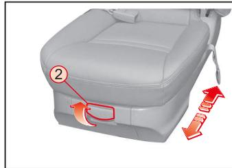
Para mover el asiento hacia adelante o hacia atrás, jale hacia arriba y sostenga la palanca de deslizamiento del asiento ② y mueva el asiento a la posición adecuada.
