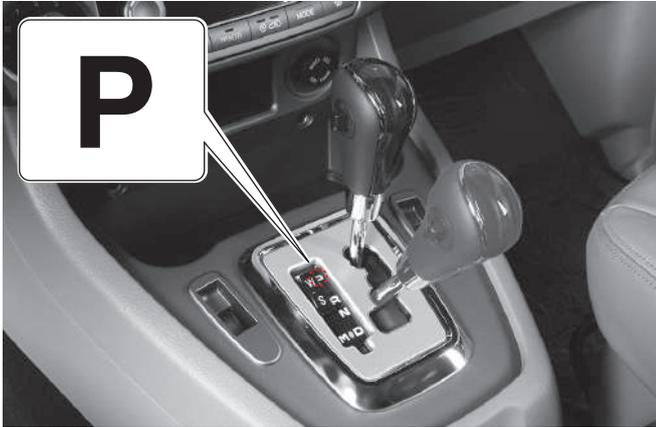
Utilice esta posición para estacionar el vehículo, arrancar el motor, calentar el motor o permanecer en un lugar durante un período de tiempo prolongado.
