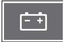
Esta luz indicadora se enciende cuando el interruptor de arranque se gira a la posición "ON" y se apaga cuando el sistema está en condición normal.
