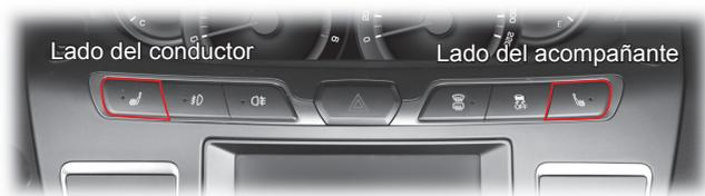
Pulse el interruptor para calefaccionar el asiento y vuélvalo a pulsar para detener la calefacción. Durante la calefacción, se enciende la luz indicadora del interruptor.
