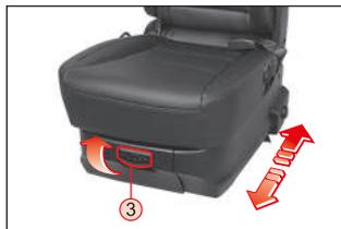
Para mover el asiento hacia adelante o hacia atrás, jale hacia arriba y sostenga la palanca de deslizamiento del asiento ③ y mueva el asiento a la posición adecuada.
