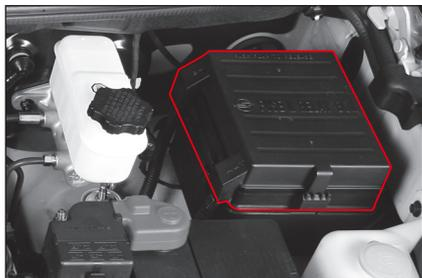
La caja de fusibles se encuentra ubicada al lado derecho del compartimiento del motor.
