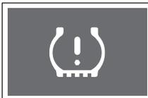
Esta luz de advertencia se ilumina al ajustar el interruptor de encendido en posición “ON” y debería apagarse en pocos segundos.
