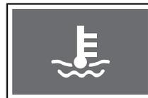
Cuando la temperatura del refrigerante del motor es anormalmente alta, la luz de advertencia de sobrecalentamiento del motor parpadea y suena la alarma. Cuando esto sucede, detenga el vehículo en un lugar seguro y espere a que se enfríe el motor. Para más información, refiérase al Capítulo 11 "Cuando el motor se sobrecalienta".
