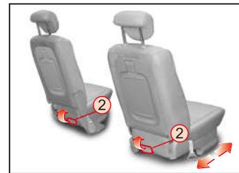
Para mover el asiento hacia adelante o hacia atrás, jale hacia arriba y sostenga la palanca de deslizamiento del asiento ② y mueva el asiento a la posición adecuada.
