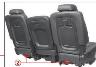
Para mover el asiento hacia adelante o hacia atrás, jale hacia arriba y sostenga la palanca de deslizamiento del asiento ② y mueva el asiento a la posición adecuada. Luego, libere la palanca en la posición deseada.
