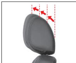
El respaldo de la cabeza se puede inclinar hacia adelante cuando se empuja hacia adelante. El respaldo de la cabeza inclinado regresa a su posición normal cuando lo empuja hasta adelante completamente hasta que se detiene y después lo libera.
