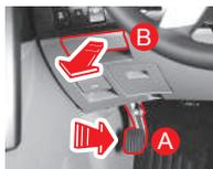
Verifique el funcionamiento del freno de estacionamiento pulsando el pedal de freno (A) en su totalidad. Además, accione la palanca del freno de estacionamiento (B) para comprobar si el freno de estacionamiento es liberado.
