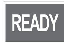
Este indicador se enciende al activar el interruptor de encendido/apagado del control de crucero.
