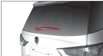
1. Retire la llave de arranque y levante el brazo limpiador del vidrio posterior.
