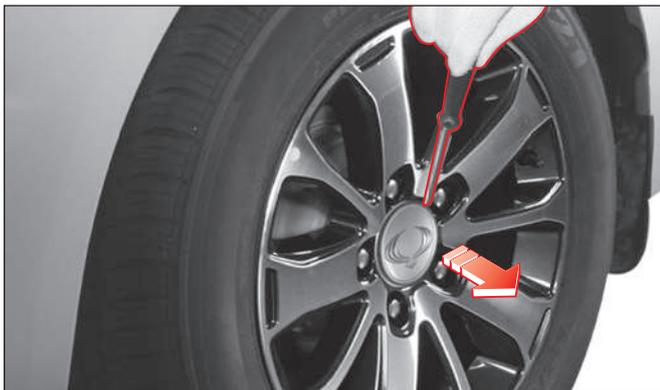
8. Levante la tapa de la rueda haciendo palanca con un destornillador plano.
