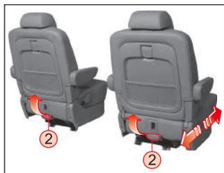
Para mover el asiento hacia adelante o hacia atrás, jale hacia arriba y sostenga la palanca de deslizamiento del asiento ② y mueva el asiento a la posición adecuada.
