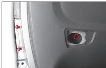
3. Desatornille los tres tornillos (3 mm) del ensamble del faro de combinación trasero.
