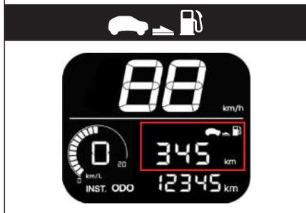
La pantalla LCD indica cuánta distancia puede conducir su vehículo con la cantidad de combustible actual en el tanque de combustible.
