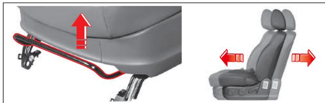
Para mover el asiento hacia adelante o hacia atrás, jale y sostenga la palanca de deslizamiento del asiento y mueva el asiento a la posición adecuada. Luego, libere la palanca en la posición deseada.
