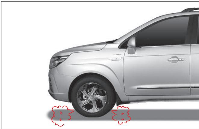
Si se desinfla un neumático mientras conduce, sujete firmemente el volante y levante el pie del acelerador. Disminuya la velocidad gradualmente y estacione su vehículo en un lugar seguro. Reemplace cualquier llanta baja con una llanta de repuesto. Para este proceso, refiérase a las secciones sobre neumáticos de auxilio.
