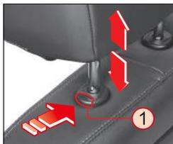
Para levantar el apoyacabeza, jale hacia arriba sin presionar el botón de liberación. Para bajar el apoyacabezas, presione el botón ① de liberación en la parte superior del respaldo del asiento y empuje el apoyacabezas hacia abajo.
