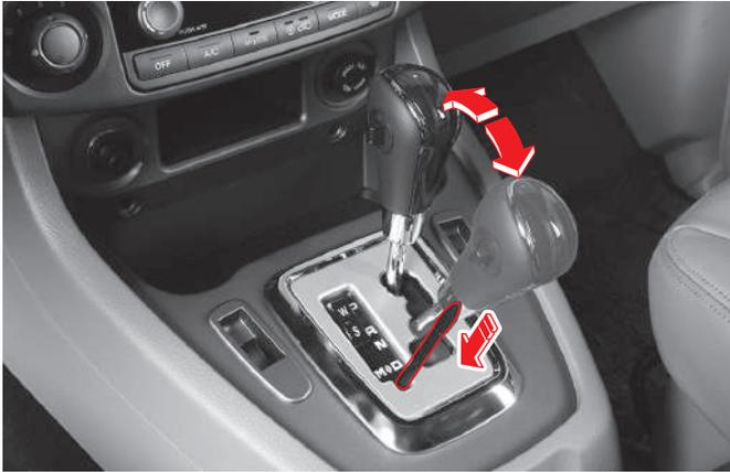
Para pasar de la posición “P” a otra posición, el interruptor de arranque debe estar en la posición ON y el pedal de frenos oprimido. Si no puede cambiar la posición “P” con el interruptor de arranque en la posición ON y el pedal de frenos oprimido:
