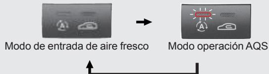
Para cambiar el modo de fuente de aire a recirculación en el modo AUTO, ingrese al modo MANUAL primero, y luego presione el interruptor de selección de fuente de aire.
