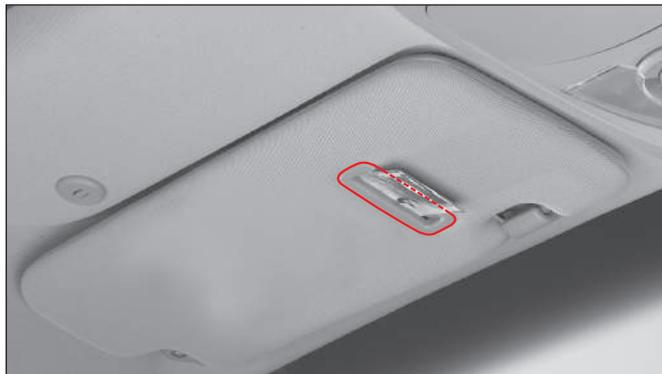
Puede conservar sus tiquetes en el sostenedor de tiquetes ubicado al frente de la visera parasol del conductor.
