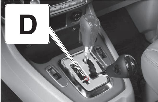
Utilice esta posición para conducción normal. La transmisión cambia automáticamente de 1ra a 5ta (7ta) según el nivel de presión en el pedal de acelerador y la velocidad del vehículo.
