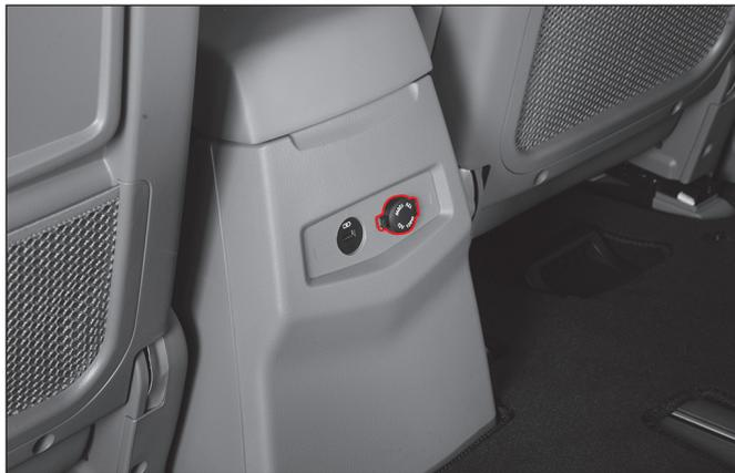
Un tomacorriente auxiliar para dispositivos eléctricos adicional está instalado en el tablero. Este tomacorriente suministra energía cuando la llave de arranque está en la posición "ON" o "ACC".
