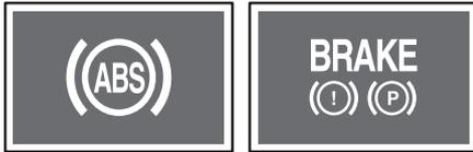
Si la luz de advertencia ABS y la luz de advertencia de freno se encienden simultáneamente, el sistema EBD (Distribución Electrónica de la Fuerza de Frenado) está dañado. En este caso, el sistema ABS no puede ser activado.
