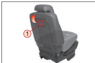
Jale hacia arriba la palanca ① para rebatir o levantar el respaldo del asiento hasta que encaje haciendo “clic”.
