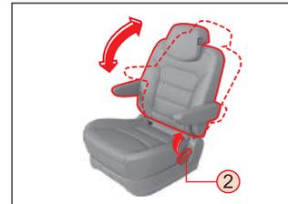
Para cambiar el ángulo de reclinación del respaldo del asiento, inclínese un poco hacia delante y levante la palanca ②. Luego, reclínese hacia atrás y libere la palanca en la posición deseada. Esta palanca está diseñada para ajustar el respaldo del asiento hasta determinado ángulo y dejarlo plano.
