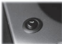
Para ver la presión de las llantas, presione el interruptor de recorrido (Trip) en el modo iluminación. La pantalla LCD muestra la presión de llantas para las ruedas frontales. Para ver la presión de las llantas de las ruedas traseras, vuelva a presionar el interruptor de recorrido.
