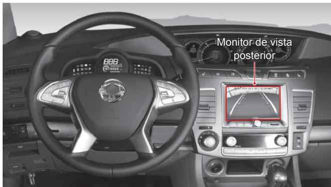
El monitor muestra la vista detrás del vehículo al ajustar la palanca de cambios en posición R.
