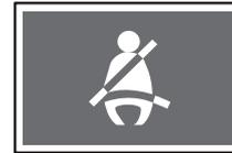
Esta luz de advertencia parpadea y suena la alarma de advertencia durante 6 segundos cuando el motor de arranque está en posición "ON (Encendido)", a no ser que el cinturón de seguridad del conductor esté bien sujetado. Esta operación de recordatorio se detiene cuando el conductor se ajusta el cinturón de seguridad incluso durante su período de operación.
