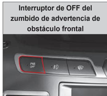
Interruptor de encendido/apagado de alarma de advertencia para el sistema de detección de obstáculos delantero con luz LED OFF
