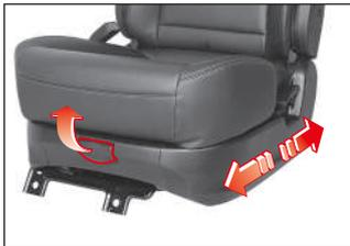
Para mover el asiento hacia adelante o hacia atrás, jale y sostenga la palanca de deslizamiento del asiento y mueva el asiento a la posición adecuada. Luego, libere la palanca en la posición deseada.
