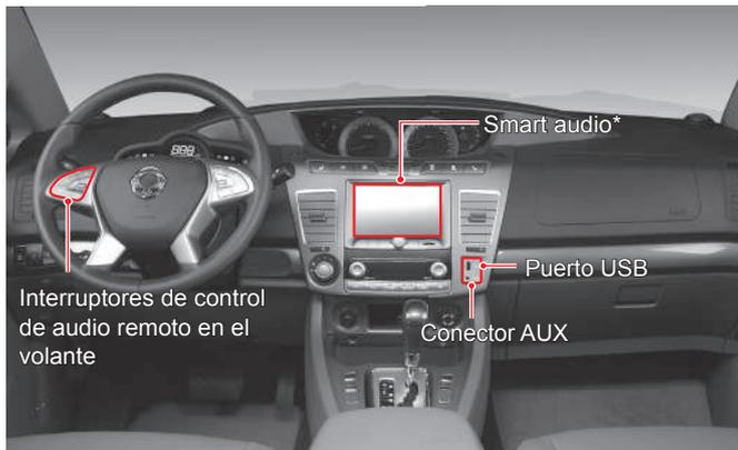
Compatible con USB / AUX / tarjeta SD / Cámara, este sistema de audio se puede controlar usando el panel de toque e interruptores del volante.
