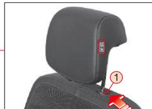
Para levantar el apoyacabeza, jale hacia arriba sin presionar el botón de liberación. Para bajar el apoyacabeza, presione el botón ① de liberación en la parte superior del respaldo del asiento y empuje el apoyacabeza hacia abajo.
