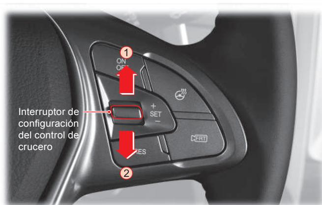
1. Interruptor de encendido/apagado del control de crucero. (Se enciende el indicador "READY")
