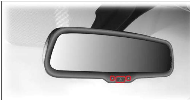
El nivel de reflejo del espejo retrovisor interior puede ajustarse en forma automática por la intensidad de la luz del vehículo que está detrás al presionar el interruptor de ajuste automático anti-brillo. Al presionar el interruptor, el indicador correspondiente se enciende. Si presiona el interruptor otra vez, el indicador se apagará y se desactivará esta función.
