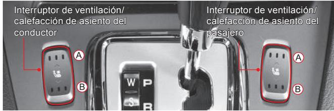
Para calentar el asiento, presione la sección (A) del interruptor. Hay tres niveles de calefacción. El indicador en el interruptor se ilumina en rojo.
