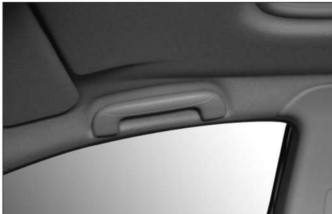
El mango de apoyo no está instalado al lado del conductor.
