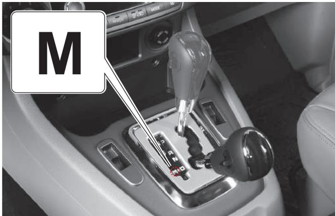
Si la palanca de selección de cambios está en esta posición, puede cambiar de marcha manualmente utilizando el interruptor inclinado en la palanca.
