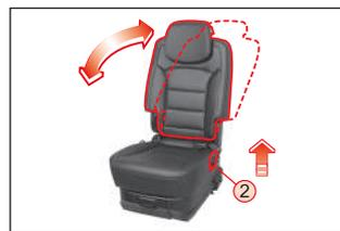
Para cambiar el ángulo de inclinación del respaldo del asiento, inclínese un poco hacia delante y levante la palanca. Luego, reclínese hacia atrás y libere la palanca en la posición deseada. Esta palanca está diseñada para ajustar el respaldo del asiento hasta determinado ángulo y dejarlo plano.
