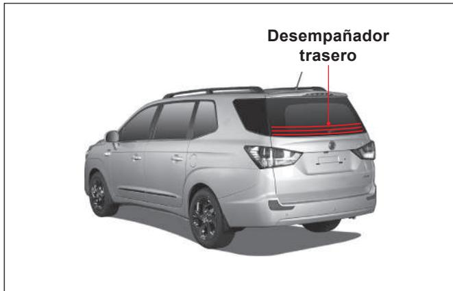
Hay filamentos en la luneta trasera. Tenga cuidado de no dañar los filamentos mientras limpia el interior de la luneta trasera.
