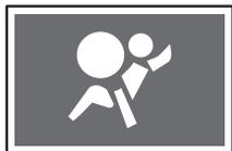
Al colocar el interruptor de ignición en la posición ON, esta luz indicadora se ilumina y se vuelve a apagar, para confirmar que el sistema de bolsas de aire está en funcionamiento.
