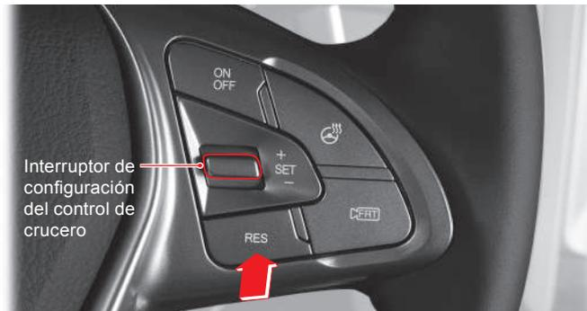
Si las condiciones de parada del cruceo automático se cumplen durante la activación del cruceo automático, la función del control de cruceo se desactiva. Sin embargo, la última velocidad establecida que está memorizada en la UCE, se reanuda al presionar el botón RES.
