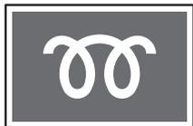
Este indicador se enciende cuando el interruptor de arranque se coloca en la posición "ON" y se mantiene encendido por un corto período de tiempo o se apaga inmediatamente. Cuando las bujías de arranque están suficientemente calientes, la luz se apagará.
