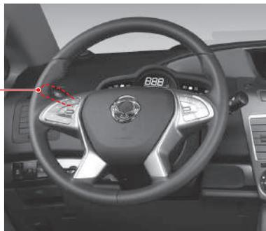
Gire el barril en el final de la palanca como se muestra, después podrá activar las luces de la siguiente manera:
