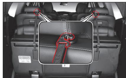
4. Enganche las dos correas en las barras del apoyacabeza como se muestra en la figura de arriba. Ajuste el largo de las correas para sujetar bien el asiento rebatido.
