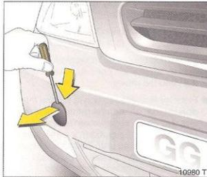
Coupé, Cabrio: abrir la tapa de cubierta para el alojamiento de la argolla de remolque que hay en la parte delantera a la derecha: desencastar la tapa por la parte superior con un destornillador y retirarla hacia abajo.
