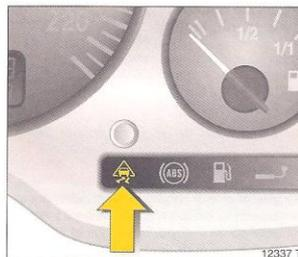
Si se enciende durante la marcha: anomalía en el sistema TC. Es posible continuar la marcha. Sin embargo, según la aceleración y las características de la calzada, la estabilidad de marcha puede deteriorarse debido a ruedas motrices que giran libremente.
