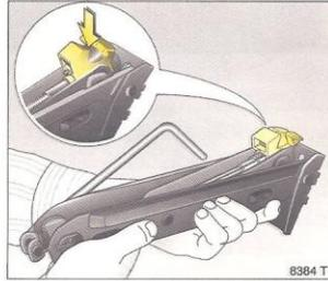
4. Aplicar el brazo del gato delante – o detrás – de manera que la garra del gato (flecha en la figura) abarque el refuerzo vertical y agarre en la escotadura del mismo.
