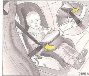
Colocar los tramos torácico y abdominal del cinturón de seguridad del vehículo en las guías del cinturón que hay en la mesa de seguridad.
