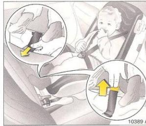
Para regular la longitud, ajustar la cinta por delante del asiento de seguridad infantil tirando de ella o levantar la brida metálica para aflojarla.
