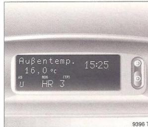
En vehículos con Carphone \* la temperatura exterior se indica como función del ordenador de a bordo, ver la ilustración.
