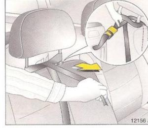
Enganchar la lengüeta del cinturón Reboard en el cierre de cinturón existente en la parte posterior del asiento de seguridad infantil.
