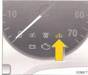
**Testigo de control de la electrónica del motor**
