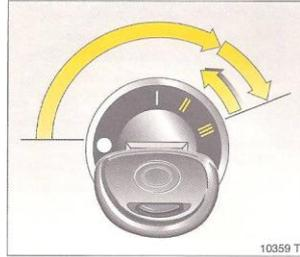
**Puesta en marcha, motor Diesel:** cambio mecánico en punto muerto, mantener pisado el embrague, cambio automático en P o N, no pisar el acelerador, girar la llave hasta la posición II; cuando se apague el testigo de precalentamiento<sup>1)</sup>, girar la llave hasta la posición III
