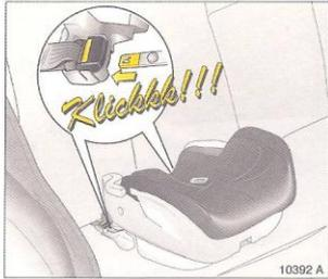
Engastar audiblemente el asiento de seguridad infantil en el sentido de marcha con las dos lengüetas de la consola de fijación en los cierres de cinturón del adaptador. Verificar el enclavamiento tirando del asiento.
