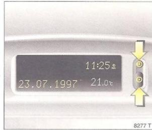
Estando desconectado el encendido, la hora, la fecha y la temperatura exterior se pueden mostrar durante unos 15 segundos presionando brevemente uno de los dos botones situados junto al visualizador.
