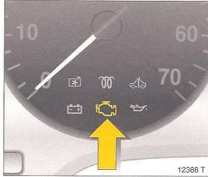
**Testigo de control para gases de escape**
