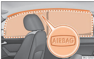
Fig. 21 Ubicación y zona de despliegue del airbag para la cabeza.
