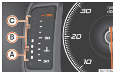
Fig. 76 Cuadro de instrumentos digital: indicador de temperatura del líquido refrigerante del motor.
