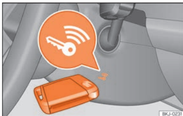
Fig. 211 A la derecha de la columna de dirección: arranque de emergencia.
