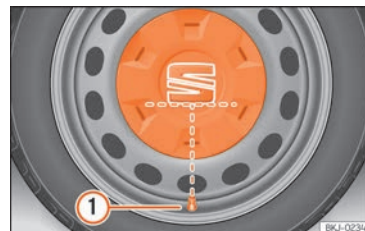
Fig. 34 Colocación correcta del embellecedor central de rueda para llantas de acero.
