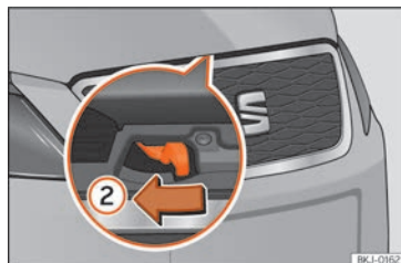
Fig. 268 Palanca bajo el capó.
