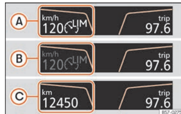
Fig. 225 En la pantalla del cuadro de instrumentos: indicaciones del estado del limitador de velocidad.
