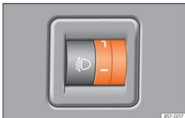
Fig. 110 Al lado del volante: regulador del alcance de las luces.
