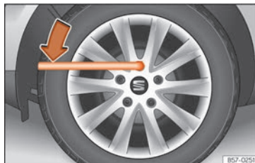
Fig. 38 Cambio de rueda: aflojar los tornillos de rueda.
