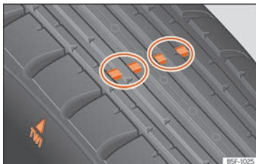
Fig. 277 Perfil del neumático: indicadores de desgaste.
