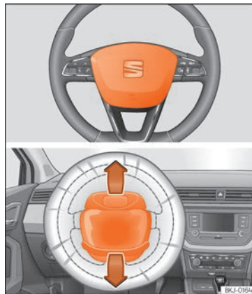
Fig. 15 Airbag del conductor en el volante.
