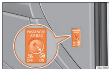
Fig. 17 Conmutador con llave para activar y desactivar el airbag del acompañante.
