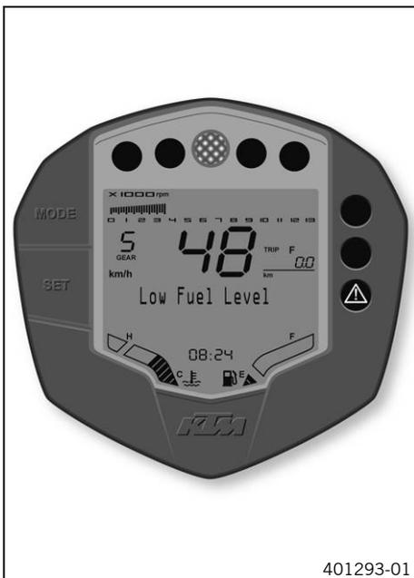
Cuando el nivel de combustible llega a la marca de reserva, el modo de visualizado cambia automáticamente a **TRIP F** y empieza a contar desde **0.0**, independientemente del modo de visualizado que estuviera activado previamente.
