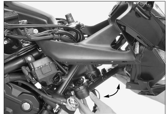
Monte una arandela de seguridad nueva [1], alineando sus aletas dobladas con las ranuras en la tuerca de ajuste.
