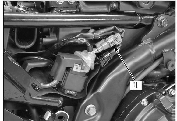
Compruebe la continuidad entre cada terminal del conector 2P (Gris) [1] del sensor de velocidad de la rueda trasera en el lado sensor y la masa.
