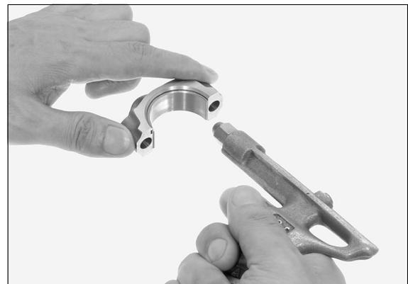
Aplice una solución de aceite de molibdeno a la superficie deslizante del cojinete de la muñequilla de biela sobre las tapas de dicho cojinete.
