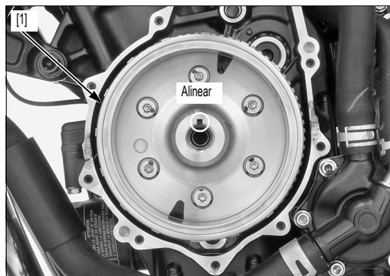
Aplique aceite de motor a las roscas del tornillo del volante de inercia y la superficie de asiento.
