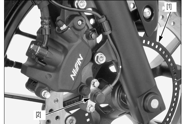
3. Comprobación de la existencia de un cortocircuito en la línea de sensor de velocidad de la rueda delantera (en el lado del sensor)
