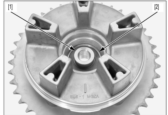
Coloque el nuevo cojinete [1] con la cara marcada orientada hacia abajo. Monte el casquillo de la brida de cardán [2] en el cojinete hasta que quede completamente asentado.
