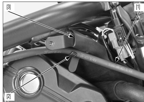
Desmonte los dos tornillos de la tapa de la culata [1] y las gomas de fijación [2].
