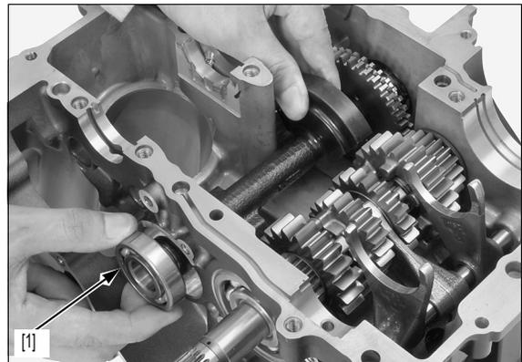
Aplique agente sellante a las roscas de los tornillos de la placa de asiento del cojinete del eje secundario del cambio derecho/compensador (página 1-20).
