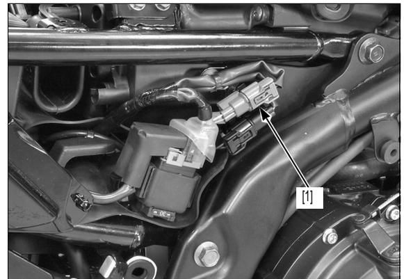
Compruebe la continuidad entre cada terminal del conector 2P (Gris) [1] del sensor de velocidad de la rueda trasera en el lado sensor y la masa.
