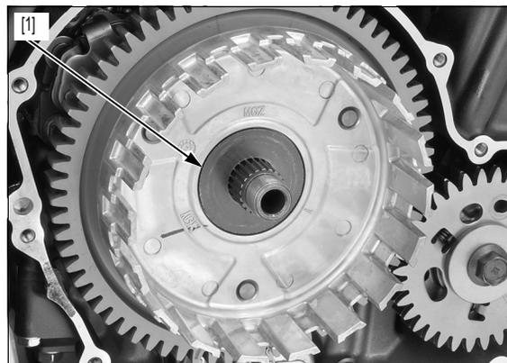
Alinee los dientes del engranaje conductor primario (tijera) introduciendo el destornillador en la ranura del engranaje [1] y haciendo palanca en los engranajes, a continuación, instale el tornillo de 6 x 14 mm [2] en los orificios del engranaje conductor primario.
