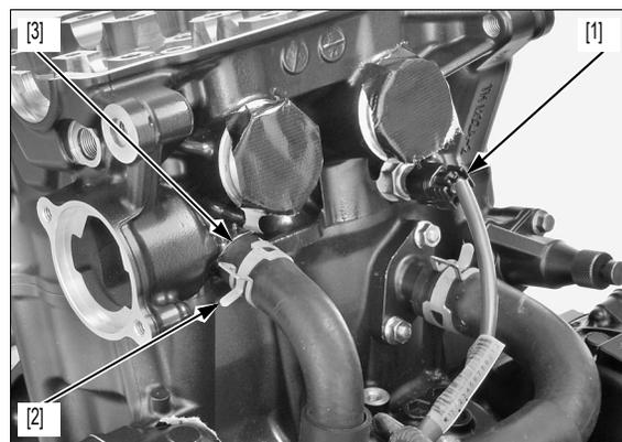
Retire los tornillos de 6 mm [1].
