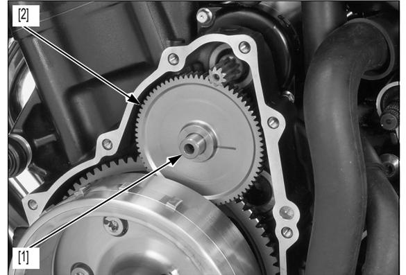
Sujete el volante de inercia [1] con la herramienta especial y afloje el tornillo del volante de inercia [2].
