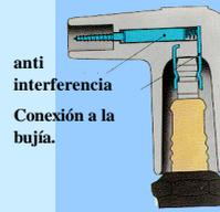
anti interferencias. La chispa actúa como si fuera un pequeño transmisor de radio e interfiere con las emisiones de radio y televisión. La ley obliga a que todos los automóviles monten anti interferencias, para evitar interferencias. En ocasiones, el anti interferencia se incluye en el terminal de la bujía (arriba). Sin embargo, en la mayoría de los autos actuales no existe este problema ya que los cables son, por sí mismos, anti interferencias.
