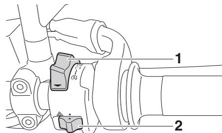
1. Interruptor de arranque/parada del motor “ $\text{E}$ ”/“ $\text{C}$ ”/“ $\text{X}$ ”
