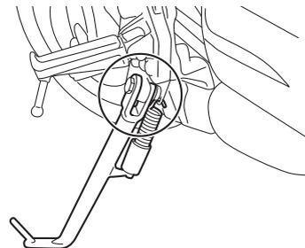
Antes de cada utilización debe comprobar el funcionamiento del caballete lateral y engrasar el pivote y las superficies de contacto metal-metal si es necesario.
