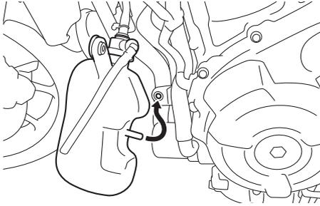
8. Extraiga el perno de drenaje del líquido refrigerante y la junta para vaciar el sistema de refrigeración.
