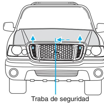
3. Levantar totalmente la tapa del capó y apoyarlo en su varilla soporte.
