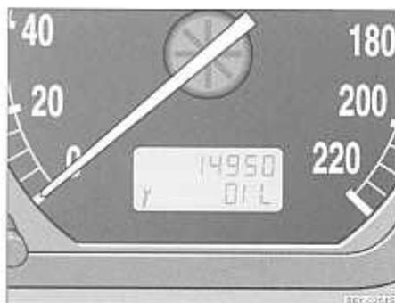
Fig. 4 Indicador de intervalos de mantenimiento QG0
