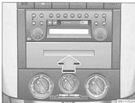
Fig. 73 Cuadro de instrumentos: Compartimento guardaobjetos extraíble.
