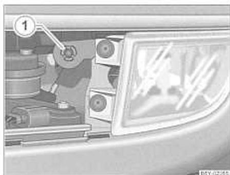
Fig. 159 Desmontar los faros antiniebla
