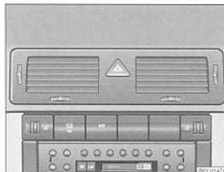
Fig. 32 Cuadro de interruptores: Interruptor para el sistema de intermitentes simultáneos
