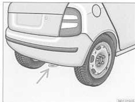
Fig. 150 Argolla de remolque trasera.
