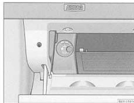
Fig. 71 - Compartimento guardaobjetos: manejo de la refrigeración.
