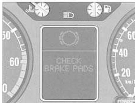
Fig. 15: Display de informaci3n: Forro de frenos desgastado
