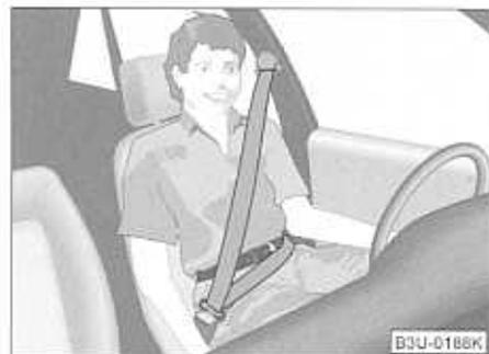
Fig. 93 Colocación de la banda del cinturón en la zona de los hombros y la pelvis
