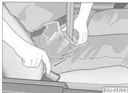
Fig. 96 Retirar la lengüeta del cierre del cinturón
