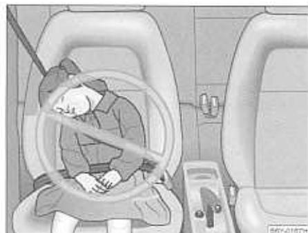
Fig. 107 Niño indebidamente asegurado en una posición de asiento incorrecta - expuesto al peligro a causa del airbag lateral
