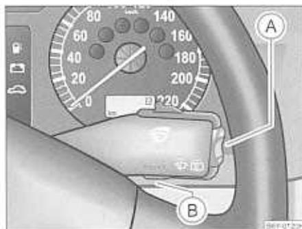
Fig. 7 Indicador multifunción: elementos de manejo
