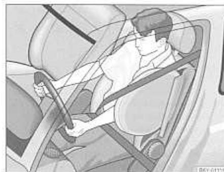
Fig. 104 Airbag lateral activado.
