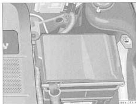
Fig. 134 Vano motor: depósito del sistema lavaparabrisas.
