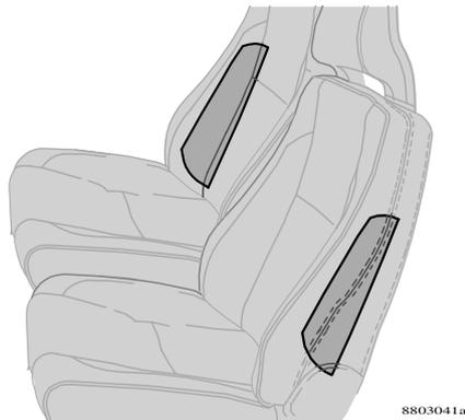
Colocación de airbag laterales
