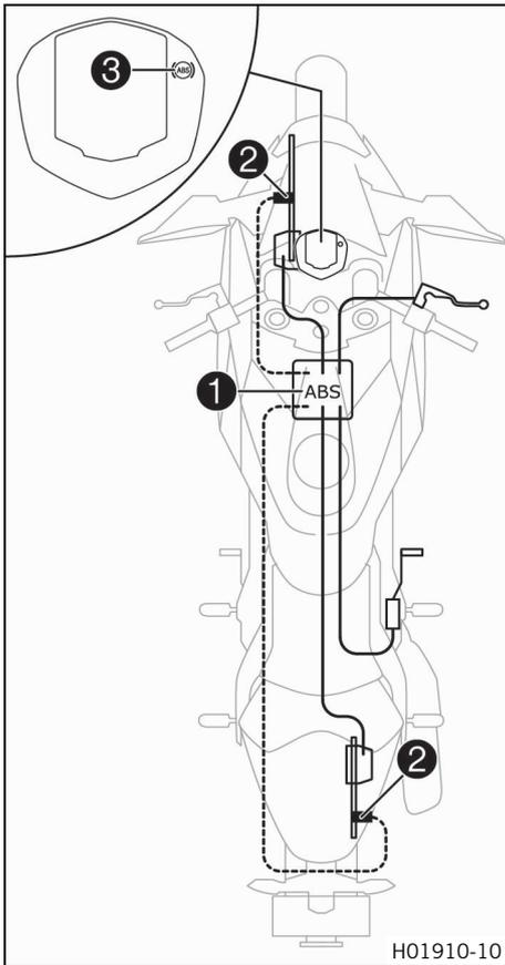
La unidad del ABS ①, compuesta por una unidad hidráulica, una unidad de mando del ABS y una bomba de recirculación, está instalada debajo del asiento. Hay un encoder del número de revoluciones ② en cada una de las ruedas, la delantera y la trasera.
