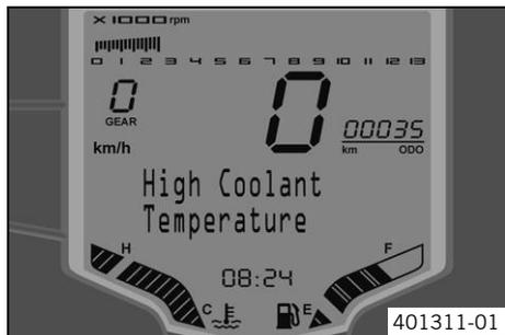
Cuando la temperatura del refrigerante sobrepasa el valor especificado, en el display de información se visualiza **High Coolant Temperature**.
