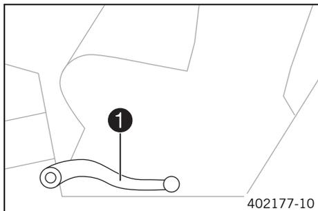
El pedal del freno ❶ se encuentra delante del reposapiés del lado derecho. El pedal del freno acciona el freno de la rueda trasera.
