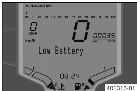
Cuando la tensión de la batería desciende del valor especificado, en el display de información se visualiza **Low Battery**.
