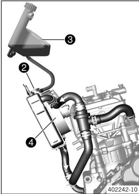
La refrigeración depende de la corriente de aire y de un ventilador del radiador (4), controlado por medio de un interruptor bimetálico. Cuanto menor sea la velocidad, menor es la acción refrigerante. La suciedad en los nervios del radiador reduce asimismo la acción refrigerante.
