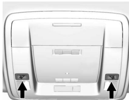
Hay luces de lectura en la consola elevada y el recubrimiento, si están equipadas. Para operar, la ignición debe estar activada o en ACC/ACCESORIOS, o utilizando Energía retenida para los accesorios (RAP).
