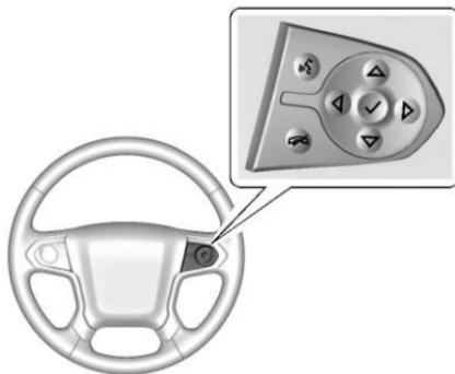
△ ○ ▽ : Presione para moverse hacia arriba o abajo en una lista. En la vista principal, presione arriba y abajo para moverse entre las diferentes páginas de aplicación de información.
