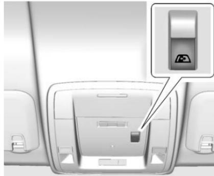
Si está equipado, la ventana trasera eléctrica deslizante trabaja cuando la ignición se enciende o se coloca en ACC/ACCESSORY (ACC/ACCESORIOS), o cuando la Energía retenida para los accesorios (RAP) está activa. Vea *Energía retenida para los accesorios (RAP)* ⇨ 284.
