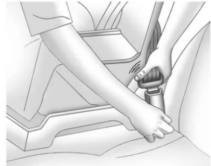
3. Empuje la placa de cerrojo dentro del broche hasta que escuche un sonido de clic. Coloque el botón de liberación sobre la hebilla, lejos del sistema de asiento de seguridad para niños, de tal forma que el cinturón de seguridad se desabroche rápidamente si es necesario.
