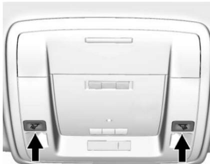
Hay luces de lectura en la consola superior y el revestimiento, si están instaladas. Para operar, la ignición debe estar en ACC/ACCESORIOS o utilizar Energía retenida para los accesorios (RAP).
