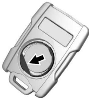
2. Presione la batería hacia abajo y deslícela hacia el bolsillo del transmisor en dirección al llavero. No utilice un objeto metálico.
