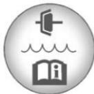
El tapón del depósito del fluido del embrague hidráulico tiene este símbolo. Vea en *Vista general del compartimiento del motor* ⇨ 382 la ubicación del depósito.
