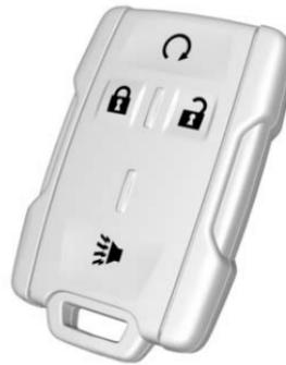
**🔒** : Presione para abrir el seguro de la puerta del conductor.
