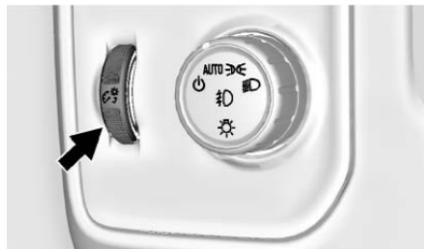
Esta función controla el brillo de las luces del volante y el tablero de instrumentos. El control de iluminación del tablero de instrumentos está junto al control de la luz exterior.
