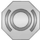
El depósito del cilindro maestro de frenos se llena con líquido para frenos DOT 3. Vea en *Vista general del compartimiento del motor* ⇨ 382 la ubicación del depósito.
