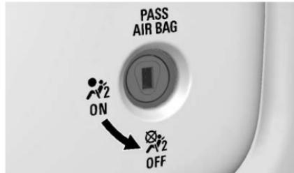
Para desactivar la bolsa de aire del pasajero delantero exterior, inserte la llave de encendido en el interruptor, empújela hacia dentro y mueva el interruptor hasta la posición de apagado.
