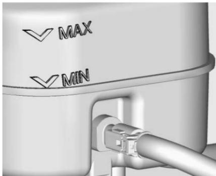
El nivel del líquido debe estar por arriba de la marca MIN (MÍNIMO); de no ser así, haga que revisen el sistema hidráulico de los frenos para ver si hay alguna fuga.
