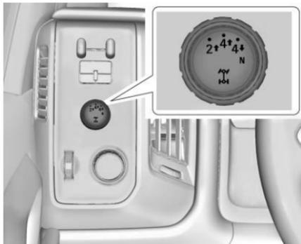
Utilice la perilla de la caja de transferencia, al lado del volante, para cambiar entre tracción en dos y cuatro ruedas para obtener tracción adicional.
