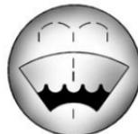
Abra el tapón que tiene el símbolo del lavaparabrisas. Agregue líquido para lavaparabrisas hasta llenar el tanque. Vea en *Vista general del compartimiento del motor* ⇨ 382 la ubicación del depósito.
