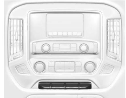
El interruptor que se utiliza para ajustar los pedales está en la columna central, debajo de los controles de clima.
