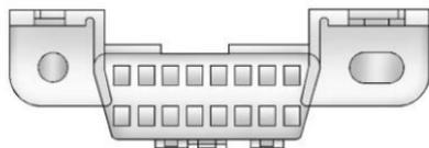
El DLC está debajo del tablero de instrumentos del lado izquierdo del volante. Conectar dispositivos que no se utilicen para realizar una Inspección de emisiones/Prueba de mantenimiento o para dar servicio al
