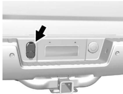
Para vehículos equipados con remolques de trabajo pesado, el conector del arnés está montado en la defensa.
