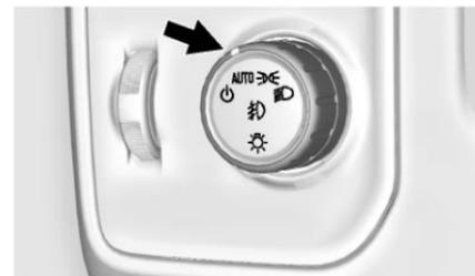
El control de luz exterior está en el tablero de instrumentos, a la izquierda del volante de la dirección.
