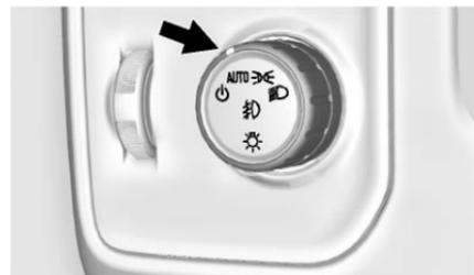
El control de luz exterior está en el tablero de instrumentos a la izquierda del volante de dirección.
