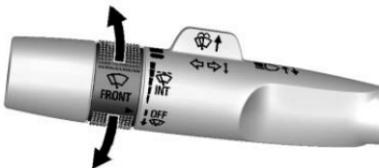
El control del limpiaparabrisas está en la palanca direccional.
