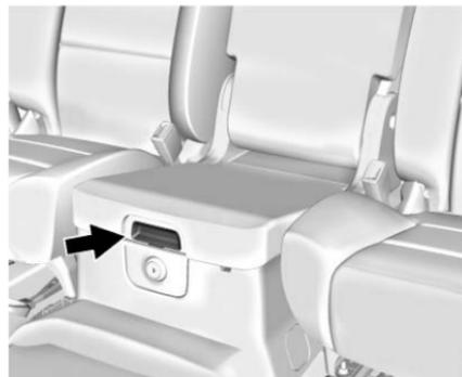
Si está equipado con almacenamiento de la consola delantera del piso del asiento, desbloquee con la llave de ignición, presione el botón, y levante para abrir.
