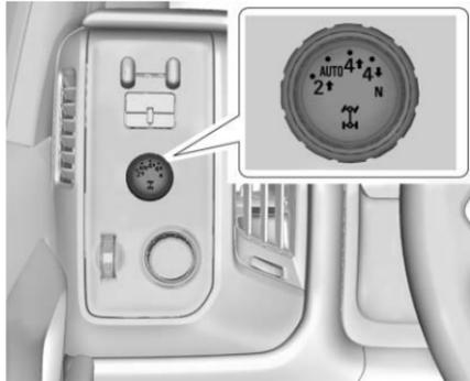
Si está equipado, utilice la perilla de la caja de transferencia al lado del volante para cambiar entre tracción en dos y cuatro ruedas.
