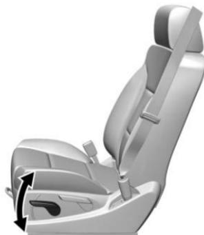
Si está equipado, mueva la palanca hacia arriba o hacia abajo en forma repetida para aumentar o reducir el soporte lumbar.
