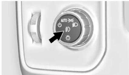
Si están equipadas, el control de las luces de niebla está en el centro del control exterior de luces, a la izquierda de la columna de dirección.
