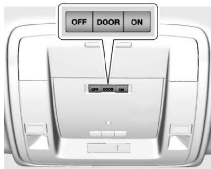
Hay luces de techo en la consola elevada y el recubrimiento, si están equipadas.
