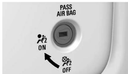
Para activar la bolsa de aire del pasajero delantero exterior nuevamente, inserte la llave de encendido en el interruptor, empújela hacia dentro y mueva el interruptor hasta la posición de encendido.
