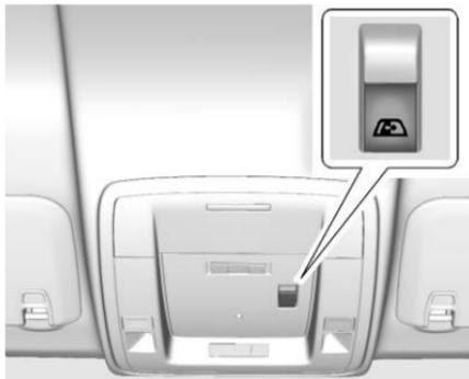
Si está equipado, la ventana trasera eléctrica funciona cuando la ignición está en encendido o en ACC/ACCESSORY, o la Energía retenida para los accesorios (RAP) debe estar activa. Consulte *Energía retenida para los accesorios (RAP)* ⇨ 284.
