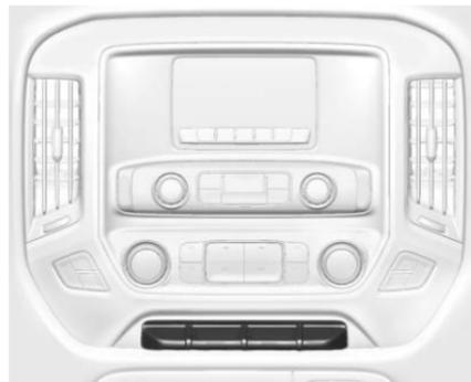
El interruptor usado para ajustar los pedales está en la consola central, debajo de los controles de clima.
