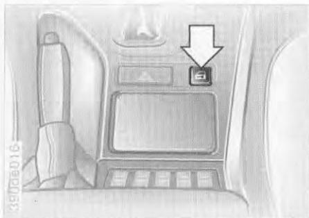
Con esta tecla se acciona el cierre centralizado estando cerradas las puertas delanteras. De esa forma sólo se desbloquean y bloquean las puertas, el portón/capó trasero, la luneta trasera y la tapa de depósito, pero no se aplica la protección antirrobo.
