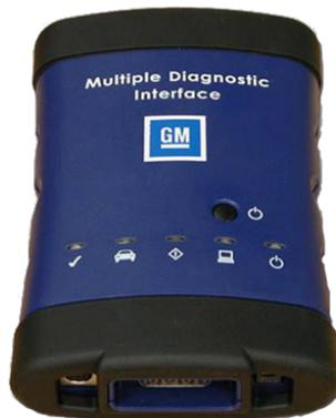
Para los diagnósticos y reparaciones bajo esta nueva estructura de bus empleamos la Multiple Diagnostic Interfase o MDI. Esta herramienta se usa en combinación con el software GDS, que se instala en una computadora personal y ambos forman la unidad de diagnóstico necesaria para todos los futuros vehículos de GM.
