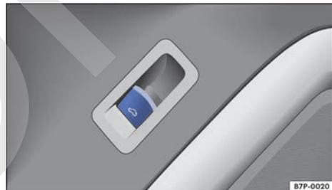
**Fig. 43** En la puerta del conductor: tecla de desbloqueo del portón del maletero.
