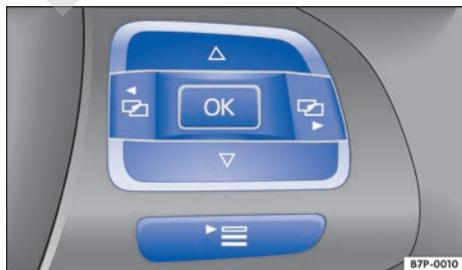
**Fig. 19** Lado derecho del volante multifunción: teclas para utilizar los menús del cuadro de instrumentos.
