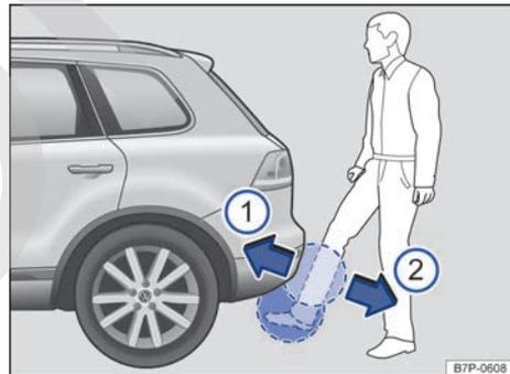
**Fig. 38** Sistema de cierre y arranque sin llave Keyless Access: abrir el portón del maletero con la apertura controlada por sensores (Easy Open) con el vehículo en diferentes niveles.
