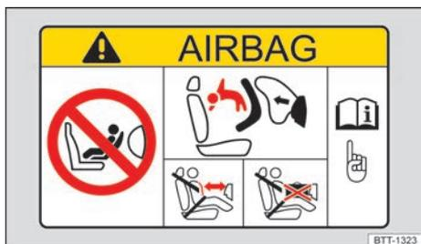
Fig. 95 Representación esquemática: etiqueta adhesiva relativa al airbag en el parasol.
