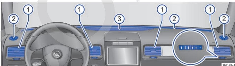
**Fig. 215** En el tablero de instrumentos: difusores de aire.
