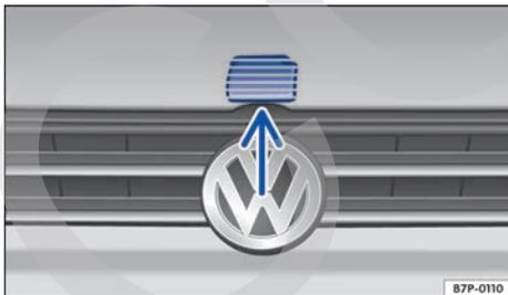
**Fig. 234** Encima de la parrilla del radiador: palanca de apertura del capó del motor.
