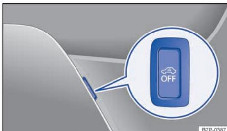
**Fig. 39** En el guarnecido de la puerta del conductor: tecla para desconectar la vigilancia del habitáculo y el sistema antirremolcado.
