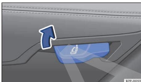
Fig. 72 Parte inferior del asiento trasero: palanca para desbloquear el respaldo izquierdo del asiento. El lado derecho es simétrico.
