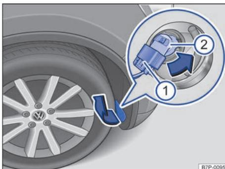
**Fig. 280** En el guardabarros delantero derecho: cambio de lámpara en el faro.
