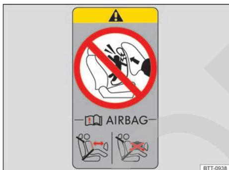
Fig. 96 Representación esquemática: etiqueta adhesiva relativa al airbag en el pilar B.
