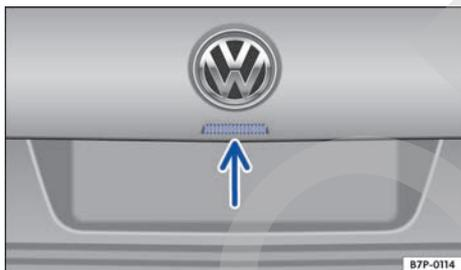
**Fig. 46** En el portón del maletero: pulsador para abrir el portón.
