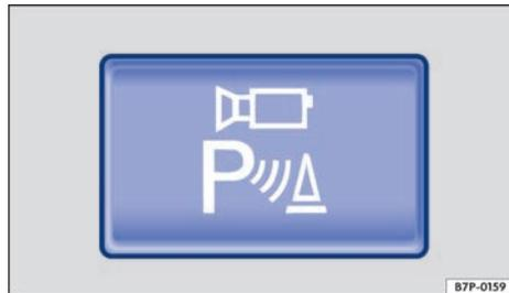
Fig. 193 En la parte superior de la consola central: tecla para conectar manualmente el sistema de visión periférica. ▶
