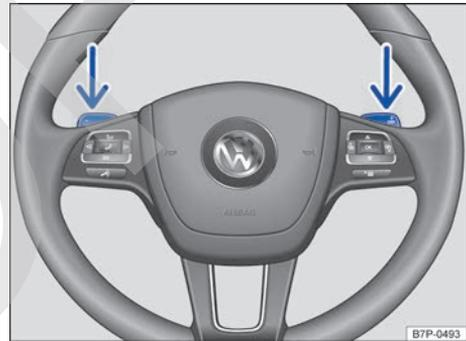
Fig. 161 Volante con levas de cambio para el Tiptronic.
