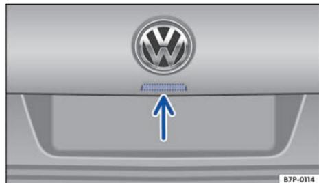
**Fig. 44** En el portón del maletero: pulsador para abrir el portón.
