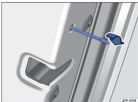
**Fig. 256** Bloqueo de emergencia del vehículo con la llave de emergencia.
