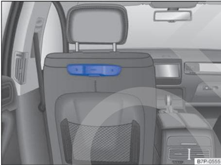
**Fig. 155** En la parte trasera del asiento del conductor: alojamiento para el Rear Seat Entertainment.
