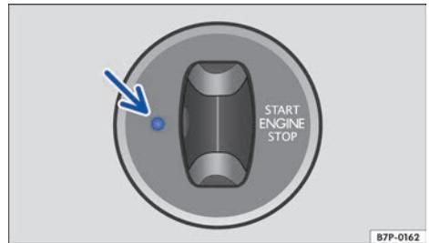
Fig. 259 Cerradura de encendido: desbloqueo de emergencia de la llave.
