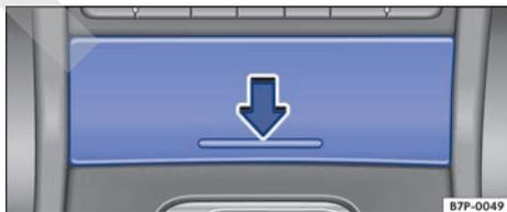
**Fig. 147** En la parte delantera de la consola central: abrir el cenicero.
