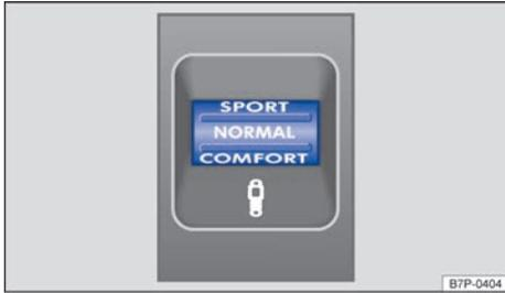
**Fig. 170** En la parte inferior de la consola central: regulador para ajustar la amortiguación.
