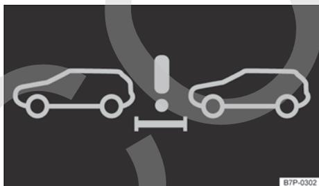
**Fig. 203** En la pantalla del cuadro de instrumentos: indicación de advertencia de la distancia.
