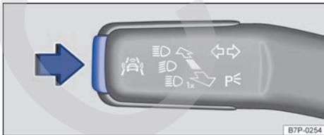
**Fig. 20** En la palanca de los intermitentes y de la luz de carretera: tecla de los sistemas de asistencia al conductor.
