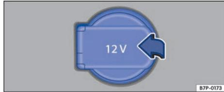
**Fig. 274** En el portaobjetos situado debajo del reposabrazos central delantero: toma de corriente de 12 voltios para conectar el compresor (variante 2).
