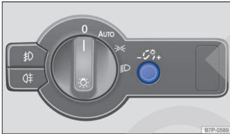
**Fig. 103** Junto al volante: regulador de la iluminación de los instrumentos y los mandos.
