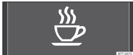
Fig. 212 En la pantalla del cuadro de instrumentos: símbolo de detección del cansancio.
