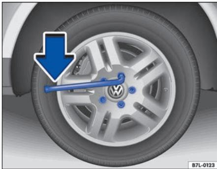
**Fig. 264** Cambio de rueda: aflojar los tornillos de rueda.
