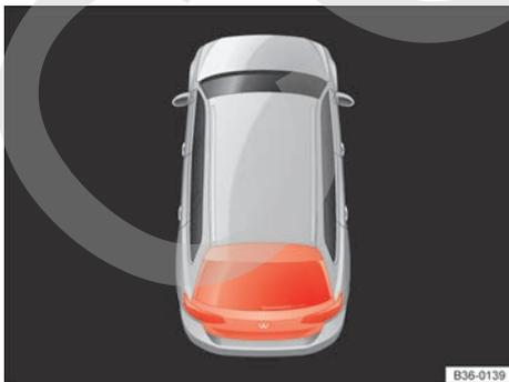
**Fig. 42** En la pantalla del cuadro de instrumentos: portón del maletero abierto o no cerrado correctamente.
