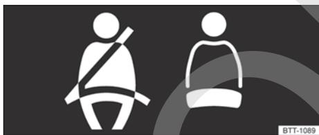
**Fig. 75** Indicación del estado de los cinturones de seguridad de las plazas traseras en la pantalla del cuadro de instrumentos.
