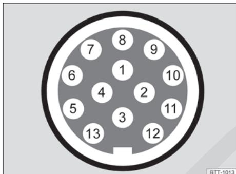
**Fig. 136** Representación esquemática: asignación de los pines de la toma de corriente para remolque.
