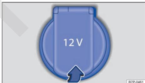
**Fig. 152** En el portaobjetos situado debajo del reposabrazos central delantero: abrir la toma de corriente de 12 voltios.
