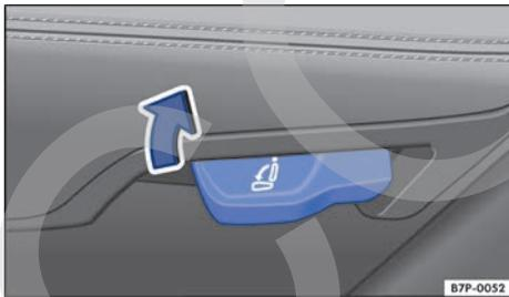
**Fig. 59** En el lateral izquierdo del asiento trasero: palanca para el ajuste de la inclinación del respaldo.
