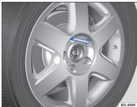
**Fig. 270** Cambio de rueda: pasador de montaje en el orificio superior.
