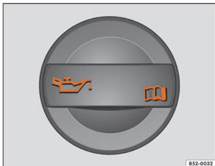
**Fig. 236** En el vano motor: tapa de la boca de llenado de aceite.
