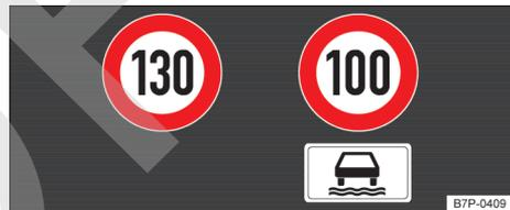
**Fig. 211** En la pantalla del cuadro de instrumentos: ejemplos de limitaciones de velocidad reconocidas con sus respectivos paneles complementarios.
