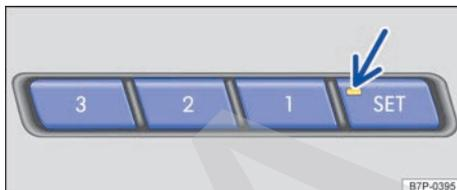
**Fig. 70** En la parte superior del guarnecido de las puertas del conductor y del acompañante: teclas de memoria para los ajustes del asiento.
