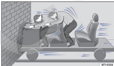
**Fig. 77** El vehículo choca contra el muro. Los ocupantes no llevan colocado el cinturón de seguridad.
