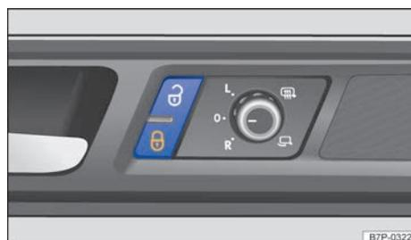
**Fig. 36** En la puerta del conductor: tecla del cierre centralizado.
