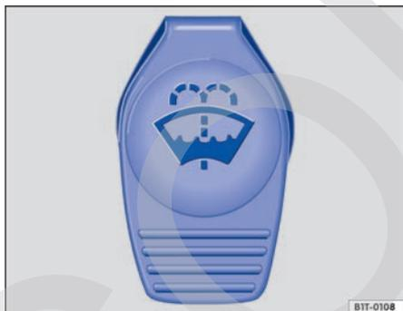
**Fig. 114** En el vano motor: tapa del depósito del lavacristales.
