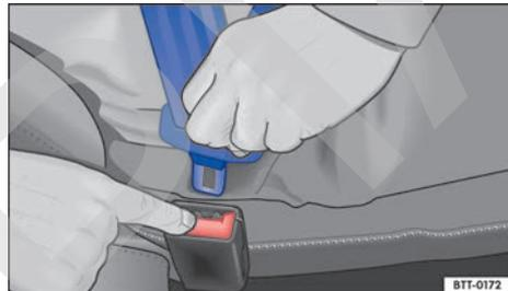
Fig. 82 Soltar la lengüeta del cierre del cinturón.
