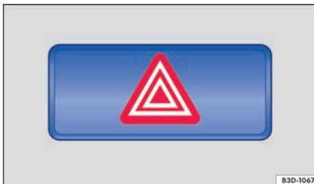
**Fig. 252** En la parte superior de la consola central: pulsador de los intermitentes de emergencia.
