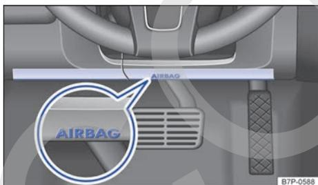
**Fig. 93** En el lado del conductor: ubicación del airbag para las rodillas.
