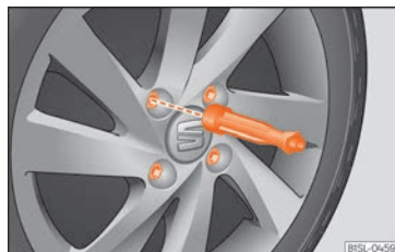
Fig. 37 Cambio de rueda: aflojar los tornillos de la rueda con el mango del destornillador.
