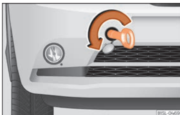
Fig. 43 Parte derecha del parachoques delantero: argolla de remolque enroscada.
