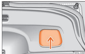
Fig. 74 Portón trasero abierto: cavidad para tirar.
