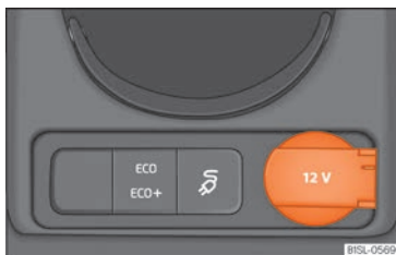
Fig. 106 Consola central delantera: toma de corriente de 12 voltios en el portaobjetos e interfaz USB.
