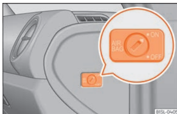
Fig. 15 Conmutador con llave para activar y desactivar el airbag del acompañante.
