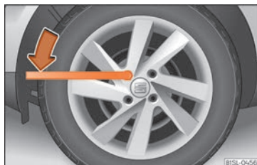
Fig. 33 Cambio de rueda: aflojar los tornillos de rueda.
