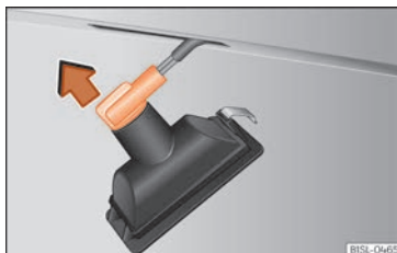
Fig. 55 Luz de la matrícula: desmontar el portalámparas.
