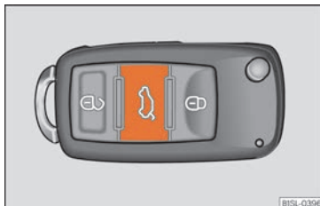
Fig. 73 En la llave del vehículo: botón para desbloquear y abrir el portón trasero.
