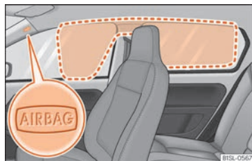
Fig. 19 Ubicación y zona de despliegue del airbag para la cabeza.
