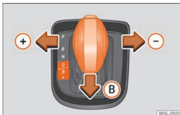
Fig. 135 En la palanca selectora: conectar la recuperación de la energía de frenado.
