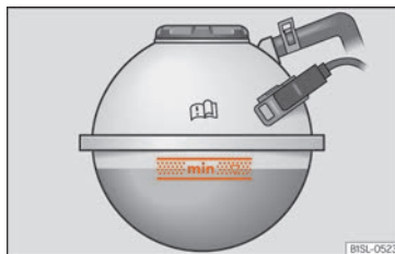
Fig. 161 En el vano motor: marca en el depósito de expansión del líquido refrigerante.
