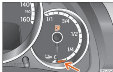
Fig.149 En el cuadro de instrumentos: indicador del estado de carga de la batería de alto voltaje con la zona de la reserva marcada en rojo (flecha).
