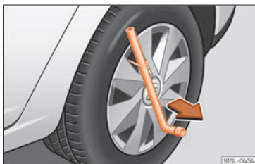
Fig. 30 Retirar el embellecedor integral.
