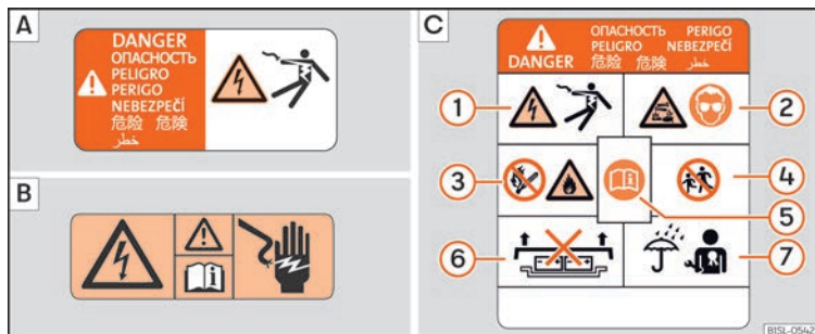
Fig. 146 Letreros de advertencia (representaciones esquemáticas): [A] Componentes de alto voltaje. [B] Letrero de advertencia general de alto voltaje. [C] Letrero de advertencia de la batería de alto voltaje.
