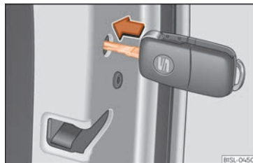
Fig. 71 Bloqueo de emergencia del vehículo con la llave del vehículo.
