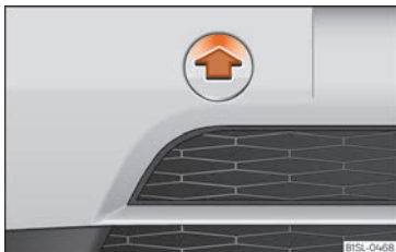
Fig. 42 Parte derecha del parachoques delantero: retirar la tapa.
