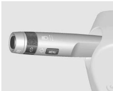
Para activar la computadora de a bordo, gire el control de la palanca de las luces de giro.
