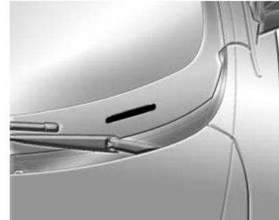
La placa con el número de identificación del vehículo se encuentra en la esquina delantera del tablero de instrumentos, en el lado del conductor. Es visible desde fuera a través del parabrisas.
