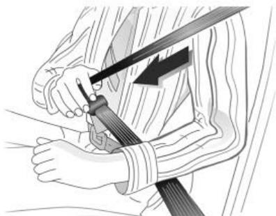
Extraiga el cinturón del retractor, guíelo por encima del cuerpo sin retorcerlo y bloquee la lengüeta en el cierre. Durante el viaje, tense frecuentemente el cinturón abdominal tirando suavemente de la banda torácica.
