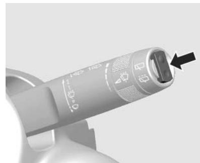
Para accionar el limpiacristales, presione el interruptor situado en el extremo de la palanca.
