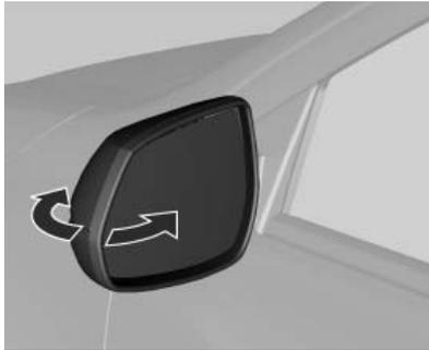
Para la seguridad de los peatones, los retrovisores exteriores basculan de su posición de montaje normal al recibir impactos de una determinada fuerza. Vuelva a colocar el retrovisor en su posición presionando ligeramente sobre la carcasa. Esta función también es útil para reducir el ancho total del vehículo y evitar daños cuando el vehículo está esta-
