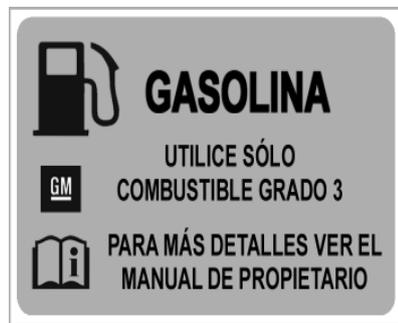
La etiqueta autoadhesiva ubicada en la tapa de llenado del tanque de combustible del vehículo contiene una indicación del tipo de combustible.
