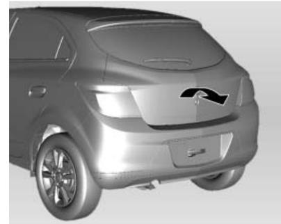
Para desbloquear el portón trasero y abrirlo, inserte la llave en la cerradura y gírela hacia la derecha o pulse el botón
