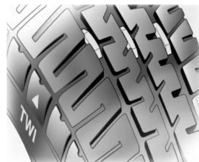
La profundidad mínima autorizada legalmente (1,6 mm) se ha alcanzado cuando el dibujo muestra un indicador de desgaste (TWI = Tread Wear Indicator). Su posición se indica mediante marcas en el costado del neumático.
