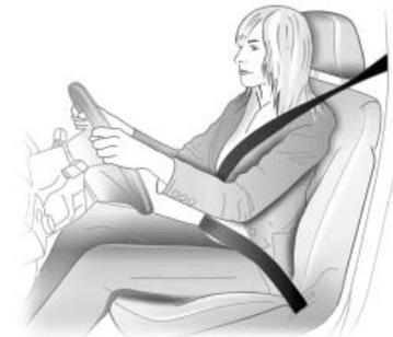
Extraiga el cinturón de seguridad y enclávelo en el cierre. El cinturón de seguridad no debe estar retorcido y debe quedar bien ajustado al cuerpo. El respaldo no debe estar demasiado reclinado (un máximo de 25° aproximadamente). Durante el viaje, tense frecuentemente el cinturón abdominal tirando suavemente de la banda torácica.
