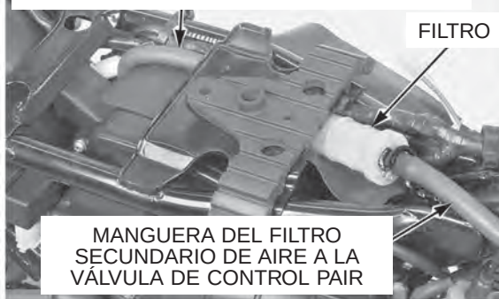
MANGUERA DEL FILTRO SECUNDARIO A LA VÁLVULA DE CONTROL PAIR
