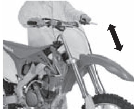
33. Mientras mantiene paralelas las horquillas, apriete alternadamente los pernos de fijación del eje derecho (36) a la torsión especificada:
