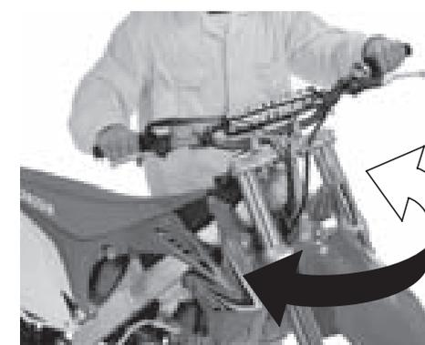
4. Instale la matrícula (3) alineando sus orificios (7) con las lengüetas (8) del vástago de la dirección. Instale y apriete los pernos (2) con seguridad. Pase la lengüeta de la placa de la matrícula (1) en torno al acolchado del manillar (9) como se muestra.
