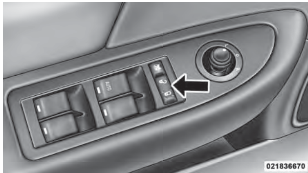
Seguros eléctricos de las puertas
