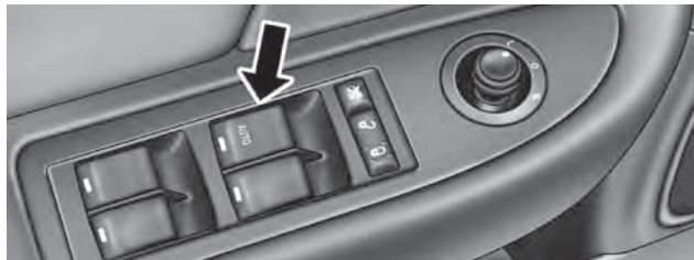
Interruptor de las ventanas eléctricas
