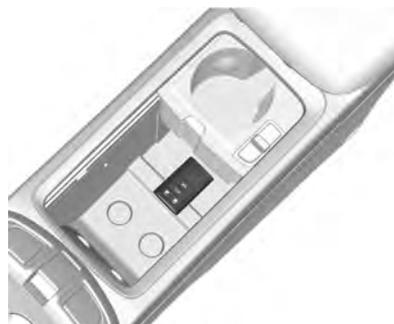
Si la batería del transmisor tiene poca carga, el DIC puede indicar ELECTRONIC KEY NOT DETECTED (LLAVE ELECTRÓNICA NO DETECTADA) cuando usted trata de arrancar el vehículo. Para arrancar el vehículo, coloque el transmisor en el bolsillo para el transmisor del área del portaobjetos de la consola central con los botones mirando hacia arriba. Luego, con el vehículo en P (estacionamiento) o en N (Punto
