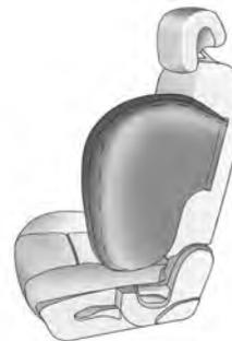
Si el vehículo tiene airbags para impacto lateral montados en el asiento del conductor y del pasajero de la parte delantera externa, estarán en el costado de los respaldos más cercanos a la puerta.
