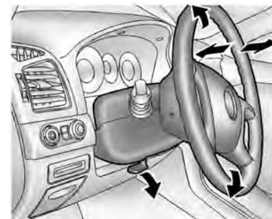
El vehículo tiene un volante inclinable y telescópico.
