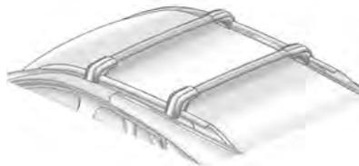
Para prevenir daños o pérdidas de la carga durante la marcha, compruebe que los rieles transversales y la carga estén sujetos en forma segura. La colocación de carga en el portaequipajes de techo eleva la posición del centro de gravedad del vehículo. Evite las altas velocidades, los arranques repentinos, los giros cerrados, el frenado repentino o las maniobras abruptas ya que puede perder el control del vehículo. Si conduce una larga distancia, por caminos irregulares o a gran velocidad,
