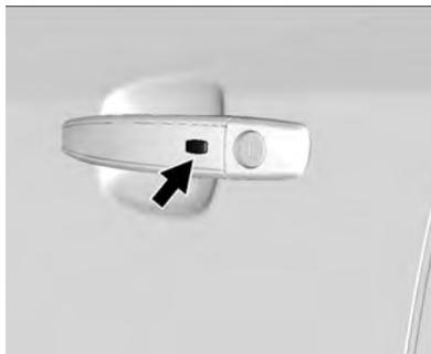
Con el transmisor de acceso sin llave a menos de 1 m (3 pies), aproxítese a la puerta delantera y tire de la manija para desbloquear y abrir la puerta. En algunos modelos, hay un sensor táctil en la manija de la puerta. Si se reconoce el transmisor, la puerta se desbloqueará y abrirá.
