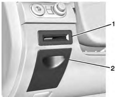
Se dispone de un portatarjetas (1) y un compartimiento portaobjetos (2) en el tablero de instrumentos.
