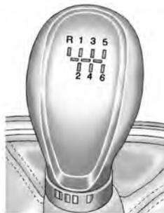
**1 (Primera):** Pise el pedal del embrague y cambie a 1 (primera). Luego, suelte lentamente el pedal del embrague a medida que presiona el pedal del acelerador.
