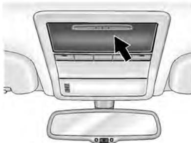
Si está equipado, el portador de anteojos de sol está en la consola de techo. Para abrirlo, empuje la parte trasera de la tapa.
