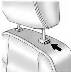
Se puede ajustar la altura del apoyacabezas. Tire del apoyacabezas hacia arriba para levantarlo. Intente mover el apoyacabezas para verificar que está trabado en su lugar.
