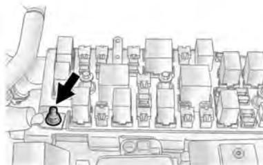
El vehículo cuenta con un terminal positivo (+) remoto. Está ubicado en el compartimiento del motor del bloque de fusibles debajo del capó. Consulte *Vista general del compartimiento del motor en la página 10-5* para mayor información sobre la ubicación.
