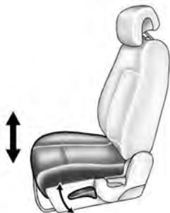
Si está equipado, mueva la palanca hacia arriba o abajo repetidamente para elevar o bajar el asiento del conductor.
