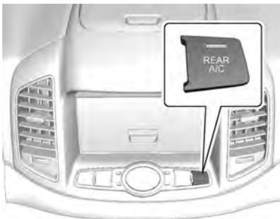
Para encender el sistema de aire acondicionado para la 3ra fila, pulse el botón ON/OFF del aire acondicionado para la 3ra fila ubicado en el centro del tablero de instrumentos.
