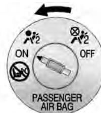
Para activar nuevamente el airbag frontal del acompañante, inserte cualquier llave o una moneda en el interruptor, empuje hacia dentro y mueva el interruptor a la posición ON.
