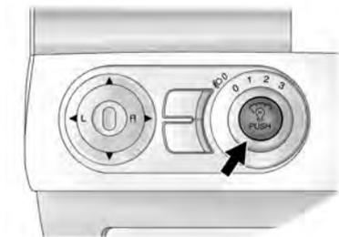
Para atenuar o aumentar el brillo de las luces del tablero de instrumentos, pulse el botón y gírelo en sentido horario o antihorario.
