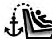
Para que sea más fácil hallar los anclajes superiores para correa, el símbolo de anclaje superior para correa está junto al anclaje.
