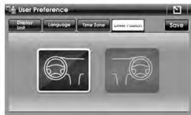
Según la posición del conductor del vehículo, se puede seleccionar VOLANTE A LA DERECHA / VOLANTE A LA IZQUIERDA.
