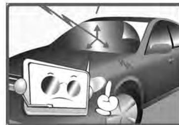
Si el parabrisas del vehículo tiene un recubrimiento metálico brillante, este afectará la recepción del GPS.
