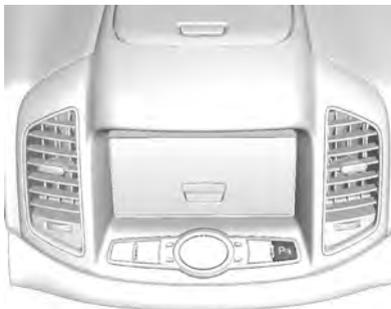
Para activar el sistema, pulse el botón del asistente de estacionamiento del tablero de instrumentos. EL botón del indicador se enciende.
