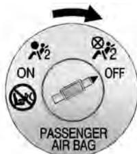
Para desactivar el airbag frontal del acompañante, inserte cualquier llave o una moneda en el interruptor, empuje hacia dentro y mueva el interruptor a la posición OFF. Los pretensores de los cinturones y todos los sistemas de airbag del conductor permanecen activos.
