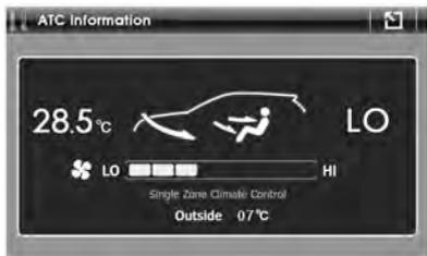
Además de pulsar el botón ATC en el menú principal, la información de ATC se muestra en la parte inferior de la pantalla cuando varía la información vinculada al aire acondicionado, como la temperatura, el flujo de aire, etc. Esta pantalla emergente se mostrará durante 5 segundos.
