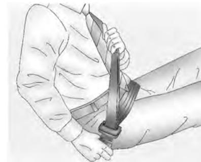
5. Para tensar la parte de la cintura, tire hacia arriba del cinturón de hombro.
