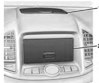
Hay un compartimento portaobjetos (1) en el tablero de instrumentos. Tire de la manija para abrir.
