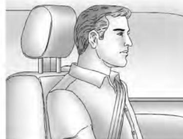
Ajuste el apoyacabezas de modo tal que su parte superior esté a la misma altura que la parte superior de la cabeza del ocupante. Esta posición reduce la probabilidad de una lesión de cuello en un choque.
