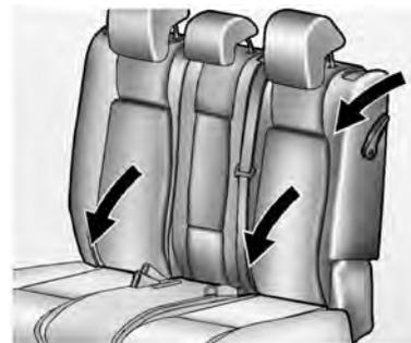
3. Tire hacia adelante de la palanca del lado exterior del respaldo. Luego, empuje levemente el asiento hacia adelante. El respaldo se plegará y el asiento se rebatirá hacia adelante automáticamente.
