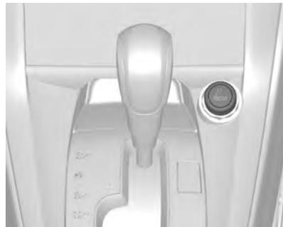
Para activar el encendedor de cigarrillos, gire el encendido a ACC (ACCESORIO) u ON (ENCENDIDO) y empuje el encendedor hacia adentro hasta el tope.
