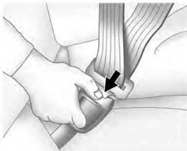
Para abrir el cinturón, presione el botón de la hebilla. El cinturón debe volver a la posición de guardado. Deslice la lengüeta metálica por encima del cinto cuando no se está usando el cinturón de seguridad. La lengüeta metálica debe apoyarse sobre la costura del cinturón de seguridad, cerca de la hebilla de guía en la pared lateral.
