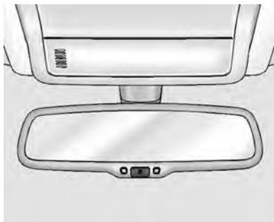
Su vehículo puede estar equipado con el espejo electrocrómico (ECM) que reduce automáticamente el resplandor producido por los vehículos que marchan detrás suyo proporcionando niveles de luz uniformes a sus ojos.
