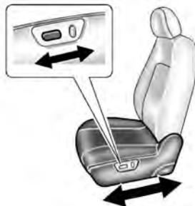
Si está equipado, mueva el asiento hacia delante o detrás deslizando el control horizontal hacia delante o detrás.
