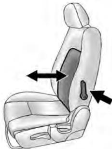
Si está equipado, mueva la palanca hacia adelante o atrás para incrementar o disminuir el apoyo lumbar.
