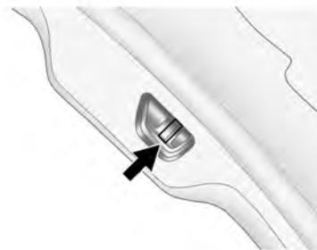
Para abrir el portón trasero si se desconectó la batería o si hay bajo voltaje, acceda a la palanca de liberación. Retire el revestimiento del lado interior del portón trasero.
