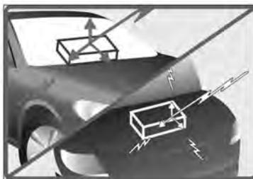
No coloque objetos sobre el panel de instrumentos ni en la repisa de la ventana trasera. Hacerlo puede desestabilizar la señal satelital del GPS y hacer que el sistema funcione de manera imprecisa.
