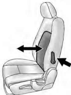
Si está equipada, mueva la palanca hacia atrás para incrementar o disminuir el apoyo lumbar.
