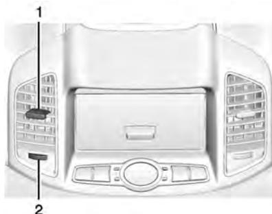
Mueva la perilla deslizante (1) de las salidas de aire hacia arriba y abajo o a derecha e izquierda para dirigir el flujo de aire.
