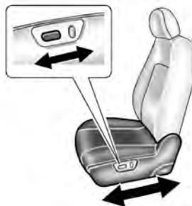
Si está equipado, mueva el asiento hacia delante o hacia atrás deslizando el control horizontal hacia delante o hacia atrás.
