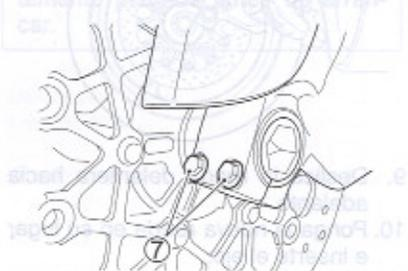
15. Apriete los tornillos del eje ⑦ al par especificado.
