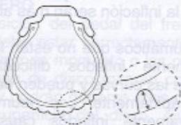
Verifique la condición de los neumáticos todos los días antes de conducir. Reemplace los neumáticos si resulta evidente que están dañados, tienen grietas o cortes, por ejemplo, o si la profundidad del dibujo es inferior a 1,6 mm en el delantero o 2,0 mm en el trasero.
