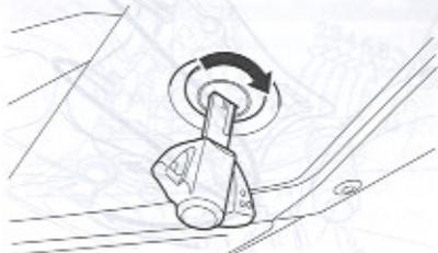
El cierre del asiento está debajo de la cubierta izquierda del bastidor. Para quitar el asiento trasero, inserte la llave de encendido en el cierre y gírela hacia la derecha.
