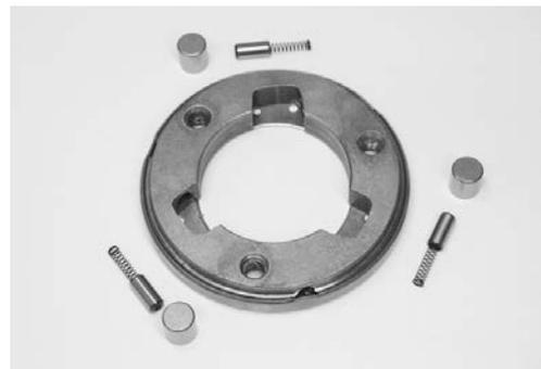
Revise el engranaje impulsado del arrancador para ver si está desgastado o dañado. Si encuentra cualquier defecto, reemplace el engranaje impulsado del arrancador por uno nuevo.
