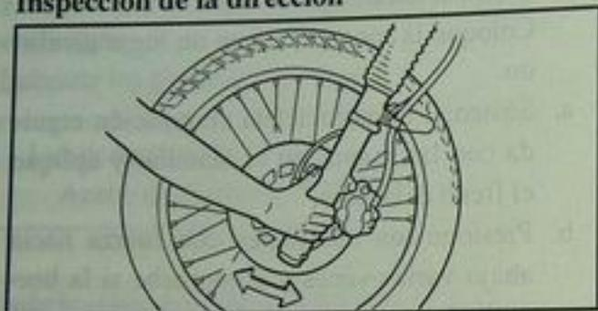
Compruébese periódicamente en que estado se encuentra la dirección. Cojinetes de dirección desgastados o flojos pueden ser peligrosos. Colocar un bloque debajo del motor a fin de levantar del suelo la rueda delantera de la moto. Luego, doblar el extremo izquierdo de las horquillas delanteras y tratar de moverlas hacia adelante y hacia atrás. Si se sintiera algo de juego libre, pedir a un concesionario Yamaha que inspeccione y ajuste. Esta inspección se facilita, si se retira la rueda delantera.
