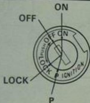
Este interruptor principal controla el encendido y el sistema de iluminación y su funcionamiento se describe a continuación.
