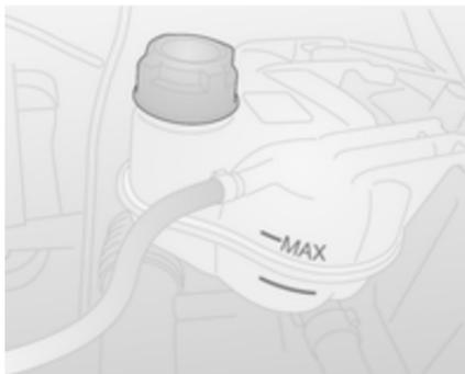
Con el sistema de refrigeración frío, el nivel del refrigerante debería estar entre la marca **MIN** y **MAX**. Rellene si el nivel es más bajo.
