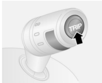
Las siguientes funciones se pueden seleccionar pulsando repetidamente el botón **TRIP** situado en el extremo de la palanca del limpiaparabrisas:
