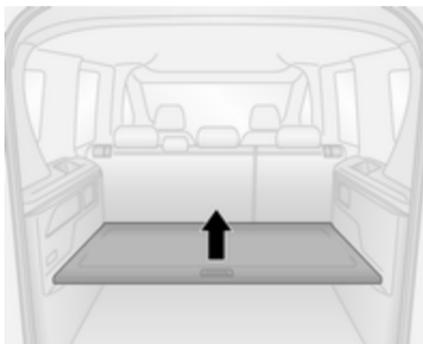
o en la posición inferior. En la posición inferior, la carga máxima permitida es de 70 kg.
