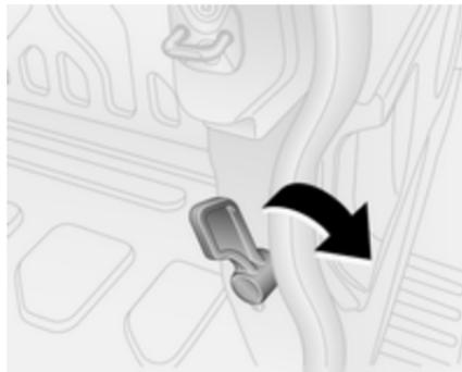
La puerta trasera derecha se desbloquea utilizando la palanca.
