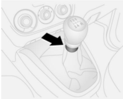
Para meter la marcha atrás, con el vehículo parado, espere 3 segundos después de pisar el pedal de embrague, levante el anillo de la palanca selectora y engrane la marcha.
