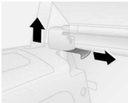
Abra la cubierta del compartimento de carga.
