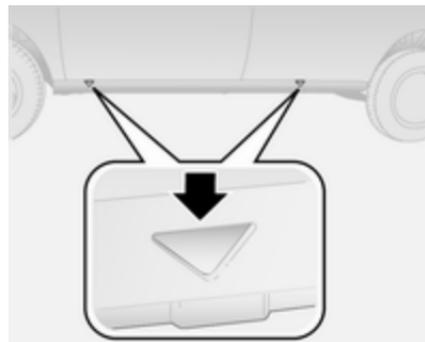
3. Los puntos de elevación del vehículo están situados en la parte delantera y trasera del mismo.
