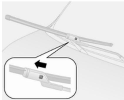
Levante el brazo limpiaparabrisas hasta que permanezca en posición alzada. Pulse el botón para liberar la escobilla del limpiaparabrisas y extraiga.
