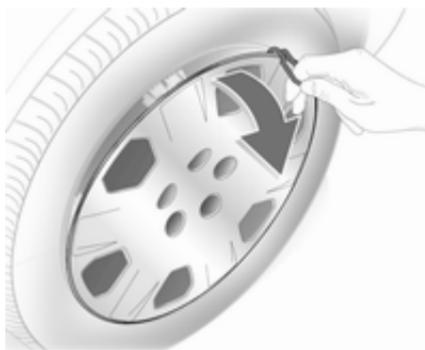
1. Desenclave los tapones de las tuercas de rueda con un destornillador y desmóntelos. Retire la cubierta de la rueda con una herramienta adecuada.
