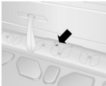
Un orificio de acceso (con flecha) permite soltar el trinquete de bloqueo del portón trasero con la herramienta adecuada. Presione la palanca hacia la derecha para desbloquear y abrir el portón trasero.
