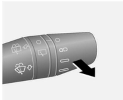
Si tira brevemente de la palanca, se pulveriza líquido de lavado sobre el parabrisas y el limpiaparabrisas realiza el barrido varias veces.
