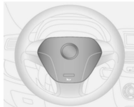
El sistema del airbag delantero se activa en caso de impacto frontal de una cierta gravedad. El encendido debe estar conectado.
