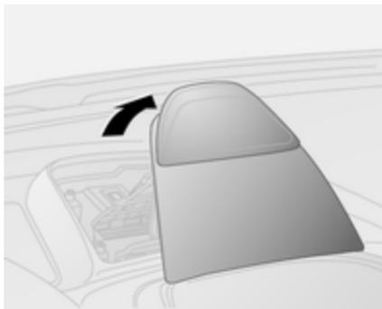
Tire de la parte trasera del portadocumentos hacia arriba en el tablero de instrumentos y déjelo en la posición inclinada.
