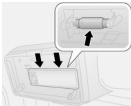
2. Extraiga haciendo palanca en los puntos indicados en la ilustración.
