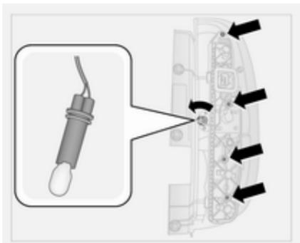
4. Desenrosque los cuatro tornillos de fijación con un destornillador. Gire el portalámparas para la luz de marcha atrás hacia la izquierda y sustituya la bombilla.
