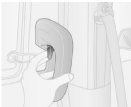
Tire de la palanca de la manilla interior y deslice la puerta.
