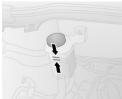
Si el nivel del líquido en el depósito desciende por debajo de la marca **MIN**, recurra a un taller.
