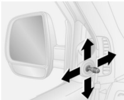
Bascule la palanca en la dirección deseada.
