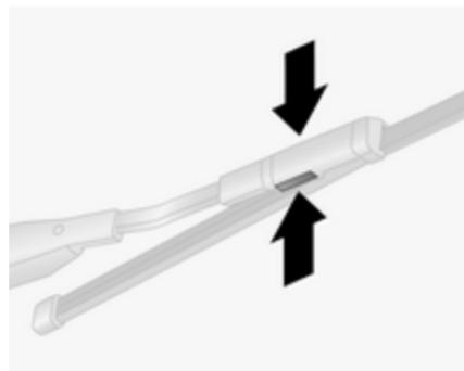
Levante el brazo del limpiaparabrisas, presione los clips de sujeción y desacople la escobilla.
