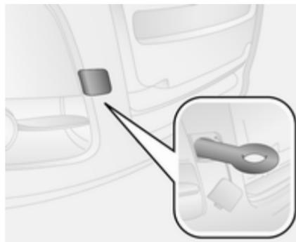
Extraiga la tapa levantándola cuidadosamente con un destornillador. Para evitar daños, se recomienda colocar un paño suave entre el destornillador y el marco.
