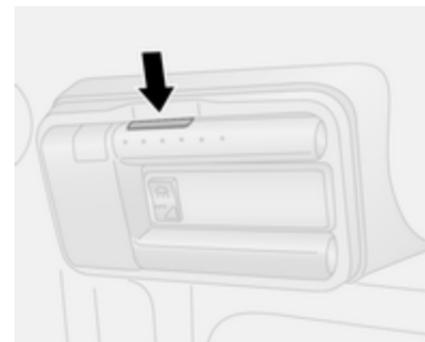
Dependiendo de la variante de modelo, la luz de cortesía trasera desmontable puede encenderse al abrir las puertas traseras / el portón trasero o la puerta corredera lateral si el interruptor central está en la posición central.
