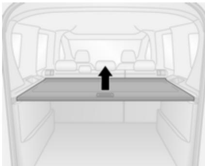
La bandeja portaobjetos trasera se puede montar en 2 posiciones: en la posición superior
