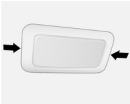
1. Desmonte la lente con un destornillador de punta plana.
