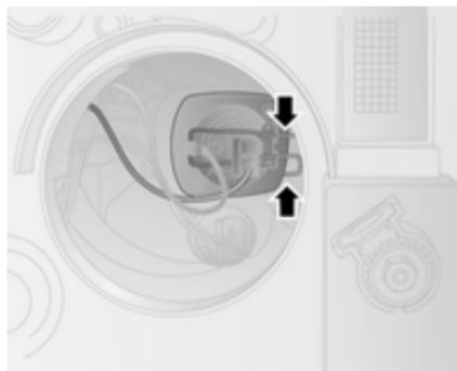
4. Inserte la bombilla nueva en el reflector de modo que la bombilla quede alineada con el rebaje del reflector.
