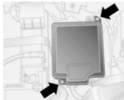
La caja de fusibles está situada a la derecha del compartimento del motor, junto a la batería.
