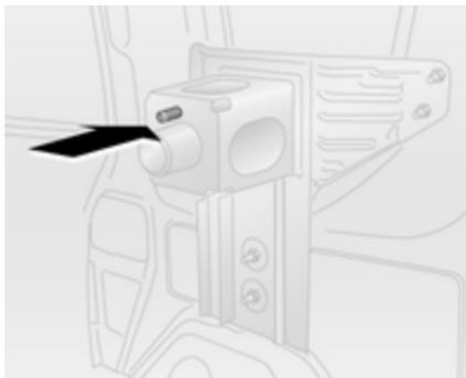
3. Coloque la rueda de repuesto sustituida en el soporte y asegúrese de que la espiga posicionadora esté alineada correctamente.
