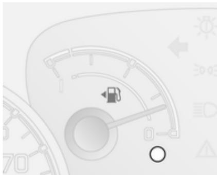
Indica el nivel de combustible, o de gas, en el depósito según el modo de funcionamiento.
