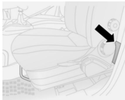
Las herramientas y el equipo de elevación del vehículo se encuentran en el compartimento portaobjetos, detrás del asiento delantero. Tire de la manilla delantera y deslice el asiento hacia adelante para tener acceso ⇨ 34.
