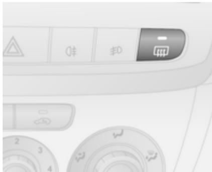
Se conecta pulsando el botón
