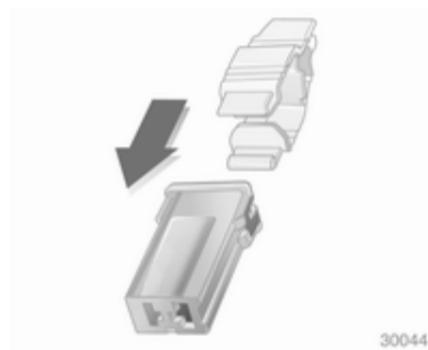
Coloque el extractor de fusibles en la parte superior o lateral del fusible correspondiente y extráigalo.
