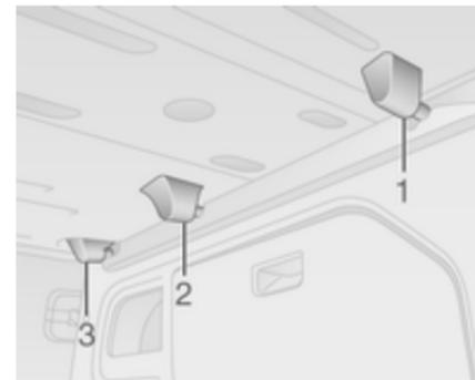
Para desmontarla, levante la parte delantera de la bandeja portaobjetos soltándola de las sujeciones delanteras (1) en ambos lados.
