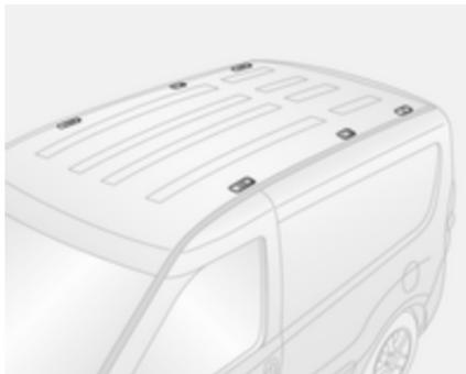
Para fijar un portaequipajes de techo, inserte los pernos de montaje en los orificios indicados en la ilustración.
