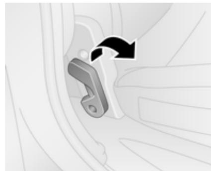
Tire de la palanca para liberarlos; la base del asiento se tensa y empieza a levantarse automáticamente.
