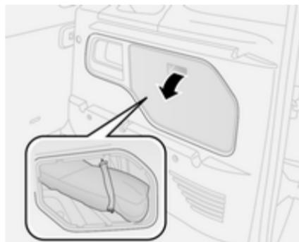
Las herramientas y el equipo del gato del vehículo están guardados en el compartimento de carga detrás de un panel en el lado derecho.
