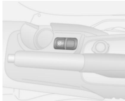
Desactive manualmente el sistema stop-start pulsando el botón
