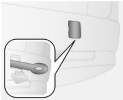
Introduzca un destornillador en la ranura del lateral de la tapa. Suelte la tapa haciendo palanca cuidadosamente con el destornillador. Para evi-
