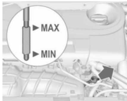
Rellene aceite de motor cuando el nivel haya descendido hasta la marca **MIN**.
