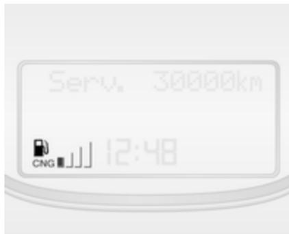
En el modo de funcionamiento con gas natural, las cuatro barras verticales junto a **CNG** corresponden al nivel de metano en los depósitos. A medida que disminuye el nivel de combustible, las barras del indicador de combustible CNG van desapareciendo.
