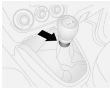
Marcha atrás: con el vehículo parado, espere 3 segundos después de pisar el pedal de embrague, levante el anillo de la palanca selectora y engrane la marcha.
