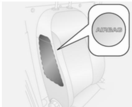
El sistema de airbag lateral consta de un airbag en cada uno de los respaldos de los asientos delanteros. Se pueden identificar por el rótulo **AIRBAG**.
