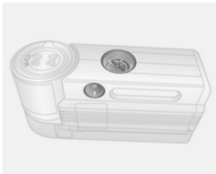
8. Ponga el interruptor basculante del compresor en **I**. El neumático se llenará con el sellador.
