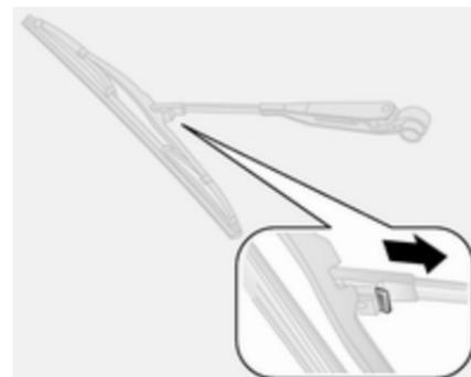
Levante el brazo del limpiaparabrisas, mantenga pulsado el clip de sujeción y desacople la escobilla.
