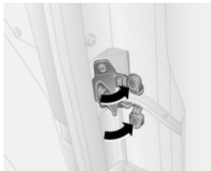
Las puertas se mantienen abiertas en un ángulo de 90 mediante tirantes de bloqueo. Para abrir las puertas a 180°, empuje el cierre y ábralas hasta la posición deseada.
