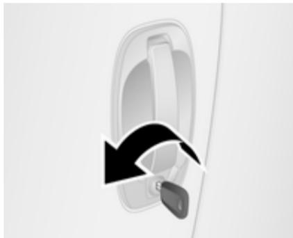
Gire la llave en la cerradura de la puerta del conductor hacia la parte delantera del vehículo.
