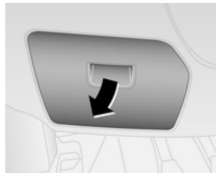
La caja de fusibles está situada detrás de una tapa en la parte inferior del tablero de instrumentos, en el lado del conductor.
