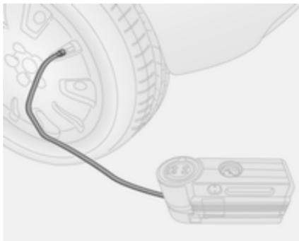
5. Enrosque el tubo flexible de llenado en la válvula del neumático.
