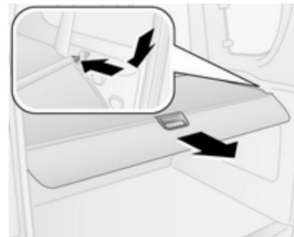
Tire de la cubierta hacia atrás usando el asidero y engánchelo en las fijaciones laterales.
