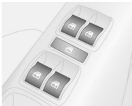
Pulse el interruptor
