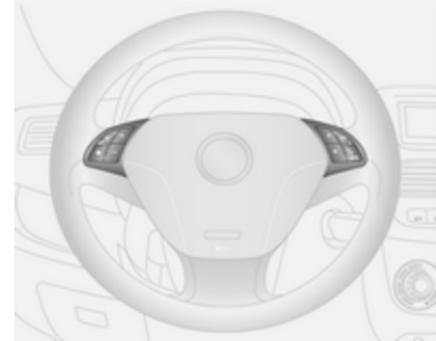
El sistema de infoentretenimiento y un teléfono móvil conectado se pueden manejar con los mandos en el volante.
