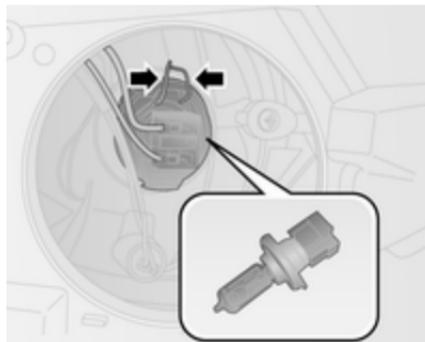
4. Inserte la bombilla nueva en el reflector de modo que la lengüeta de fijación de la bombilla quede alineada con el rebaje del reflector.
