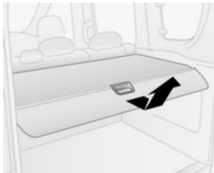
Retire la cubierta del compartimento de carga de las fijaciones laterales. Sujete la cubierta y guíela hasta que esté totalmente enrollada.
