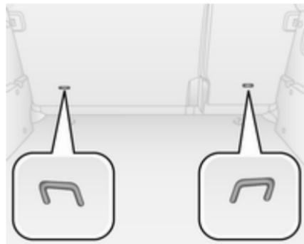
Además del soporte de montaje ISOFIX, fije la correa del anclaje superior a las argollas de fijación para el anclaje superior. La correa debe pasar entre las dos varillas guía del reposacabezas.
