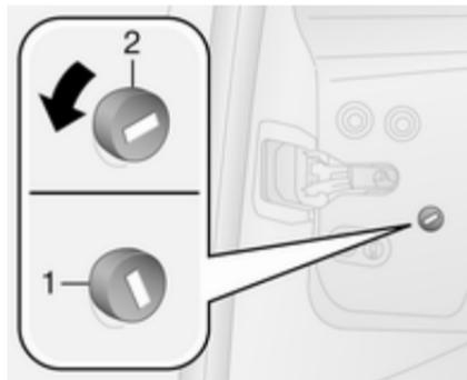
Para evitar que la puerta corredera lateral se abra desde el exterior, abra la puerta y acople el cierre de seguridad antirrobo.
