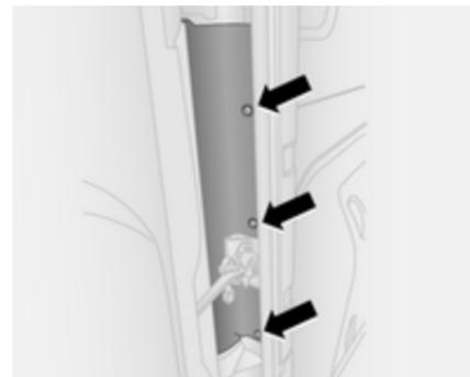
1. Retire los tres tornillos de fijación.
