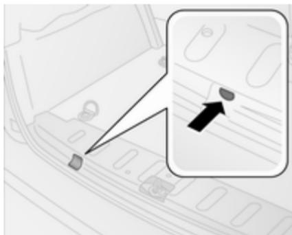
2. Introduzca la llave para ruedas en la apertura del piso del compartimento de carga.
