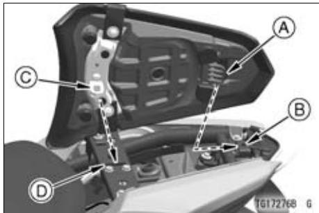
A. Gancho B. Ranura C. Placa de cierre D. Orificio de cierre
